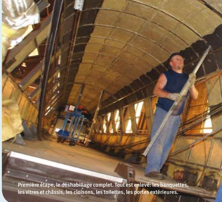
Première étape, le déshabillage complet. Tout est enlevé: les banquettes, les vitres et châssis, les cloisons, les toilettes, les portes extérieures.
