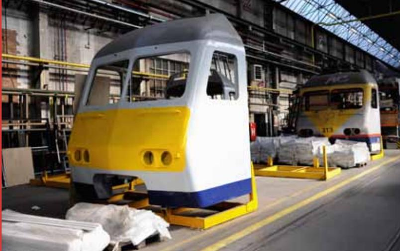
Durant la modernisation, la cabine de conduite est démontée pour traiter et peindre les tâches de rouille.
