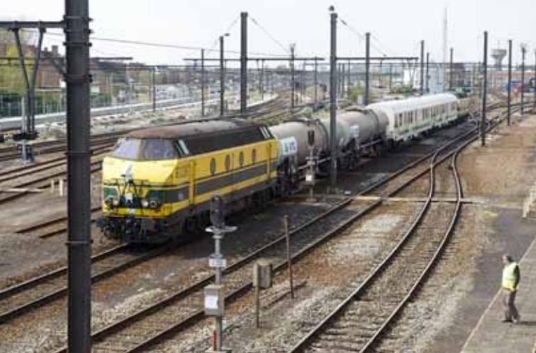
Prenez une voiture d'épandage composée d'une salle de commande, une salle des pompes et dotée d'un groupe électrogène, une voiture comprenant des facilités pour le personnel, 2 wagons citernes pleins d'eau, et 2 locomotives Infrabel, et vous obtiendrez un train de dés-herbage prêt à travailler à 60 km/h avec une autonomie de 3 à 4 jours !
