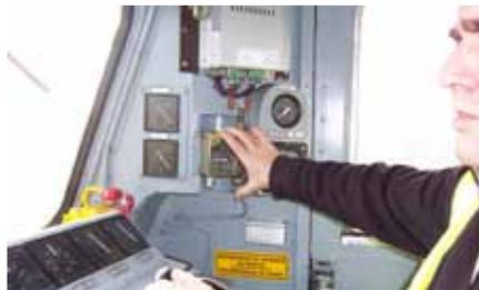
systèmes d'aide à la conduite (gong-sifflet, Mémor, TBL1, TBL1+) rappellent la signalisation lumineuse dans le poste de conduite et aident le conducteur à rester vigilant.
