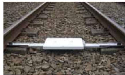
Comme dans le cas de la TBL1, si le train vient quand même à dépasser le feu rouge, le point d'information au pied du signal entraînera le freinage d'urgence pour stopper le train automatiquement.
