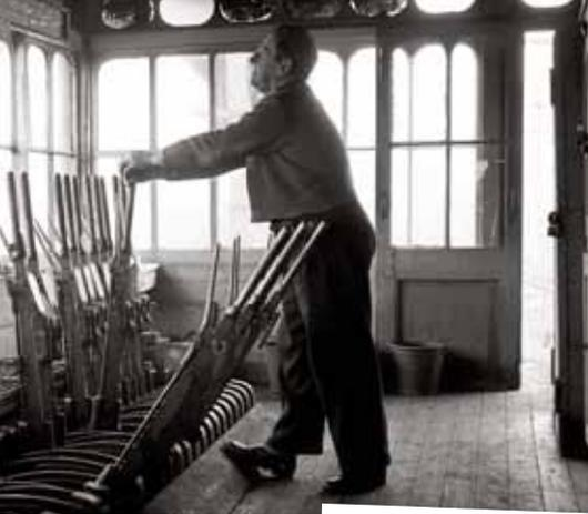
Dans les cabines mécaniques, la commande des aiguillages et signaux était manuelle.
