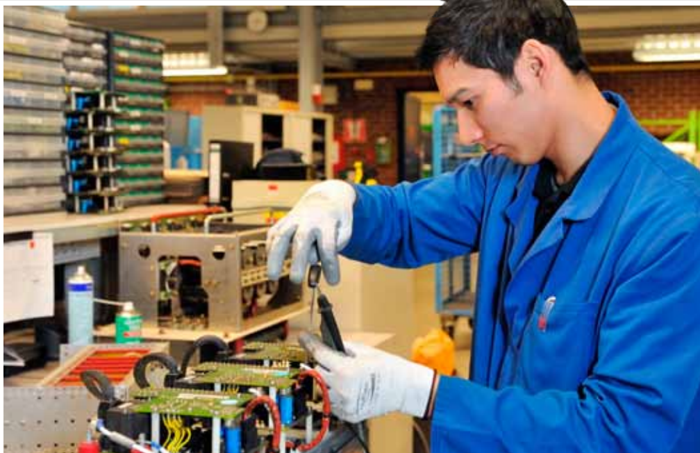
Laurence Subagyo contrôle un module de hacheur M6
