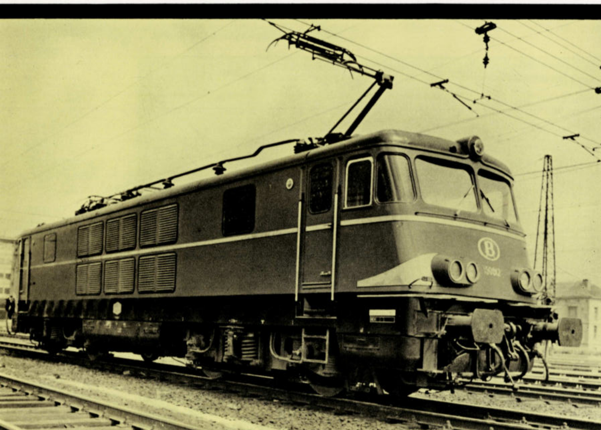
Driestroomlocomotief van de N.M.B.S.
