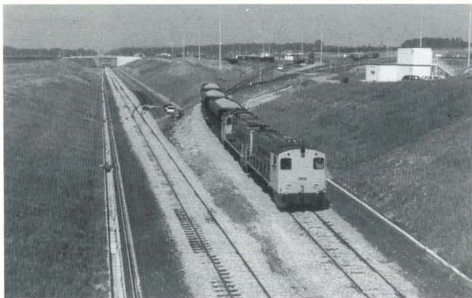
PHOTO 23-28 Les locomotives série 76 sont utilisées à la traction du train de desserte journalier de la base de St-Druon, où elles effectuent régulièrement des manoeuvres. Les 7619 et 7622, accouplées tête-bêche, se dirigent vers la ligne nouvelle où elles s'apprêtent à ballaster la voie provisoire. Dans le fond, la voie de raccord venant de la ligne 78 se greffe sur la voie déjà posée. Antoing, 2 août 1995. Photo : Baudouin DIEU.
