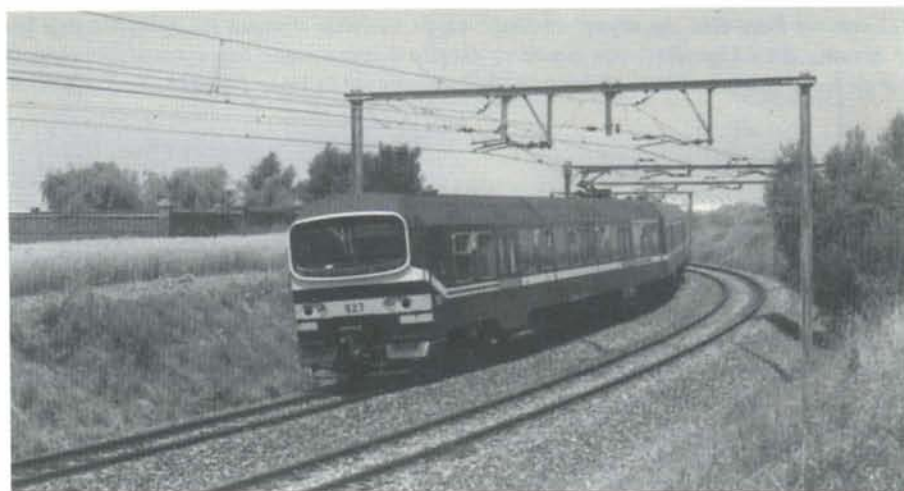
PHOTO 23-09 Depuis le 28 mai, la desserte de l'aéroport de Bruxelles-National est intégralement assurée par les automotrices de la série 900. C'est précisément à cet endroit que le tracé de la ligne 36C sera modifié et continuera en ligne droite vers la nouvelle gare en passant sous la piste d'atterrissage 07 située à 200 mètres environ. Zaventem, 27 juillet 1995. Photo : Jean-Luc VANDERHAEGEN.
