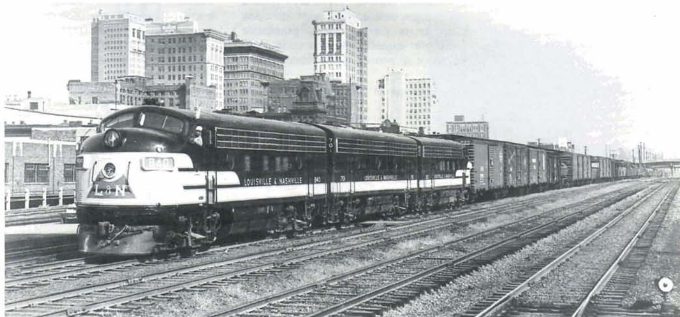
La plus connue des F : la F7, facilement reconnaissable à sa grille d'aspiration d'air horizontale et continue sur toute la longueur de la salle des machines. Ici, un ensemble de trois machines (F7A 840 + F7B (boosters) 701 + F7A 820) du Louisville & Nashville, remorquant un train de marchandises entre Cincinnati et New Orléans, en passage à Birmingham au début des années 1950. Le gros phare supérieur jetait de puissants éclairs dans le ciel afin d'avertir les automobilistes.
