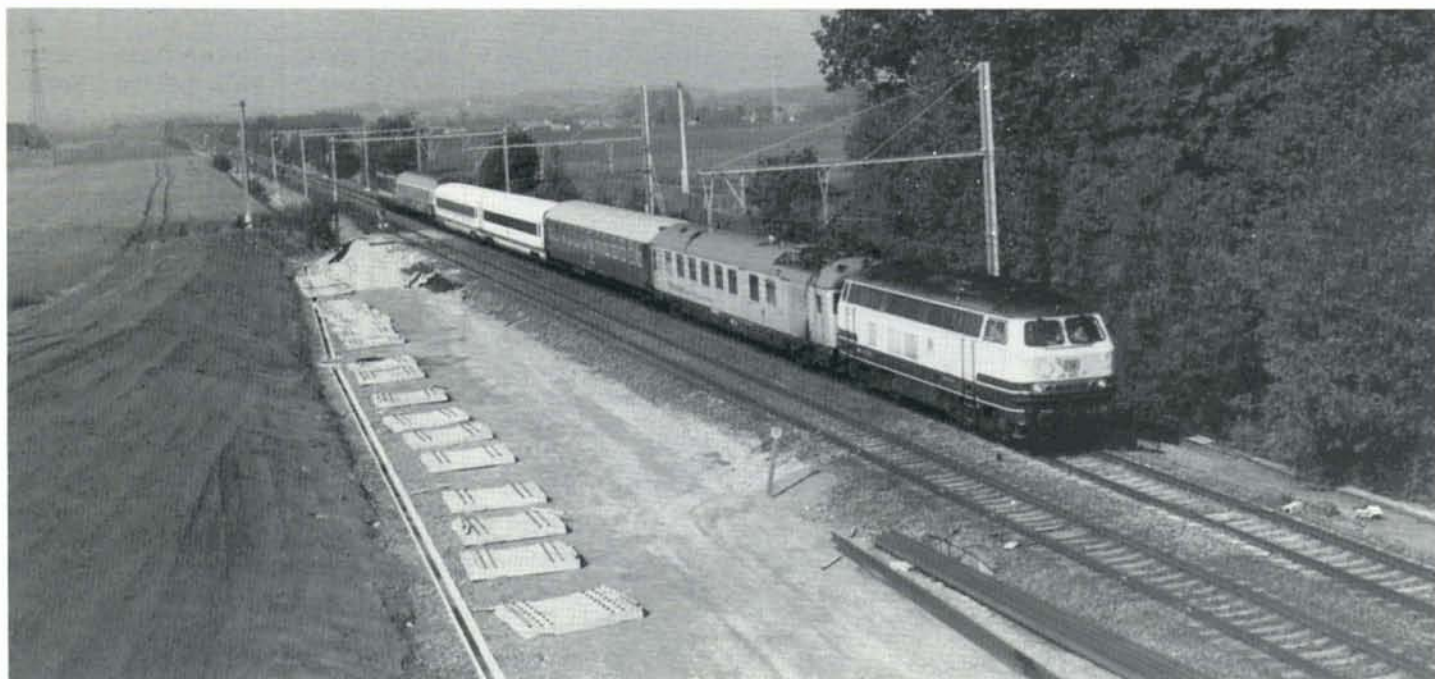
PHOTO 23-02 C'est entre Ath et Silly, à hauteur de la base TGV du Coucou en cours de construction, que furent opérées les diverses mesures. Derrière la 218.901-7, on distingue la voiture de mesure de la DBAG, une voiture d'accompagnement, les deux remorques ICE, la seconde voiture d'accompagnement, et en queue la 2732. A noter que la 218.901-7 titulaire du dépôt de Braunschweig, est l'ex-210.001-4 DB (locomotive à turbine à gaz, transformée le 10 février 1981). Photo : Philippe GOUSSET.
