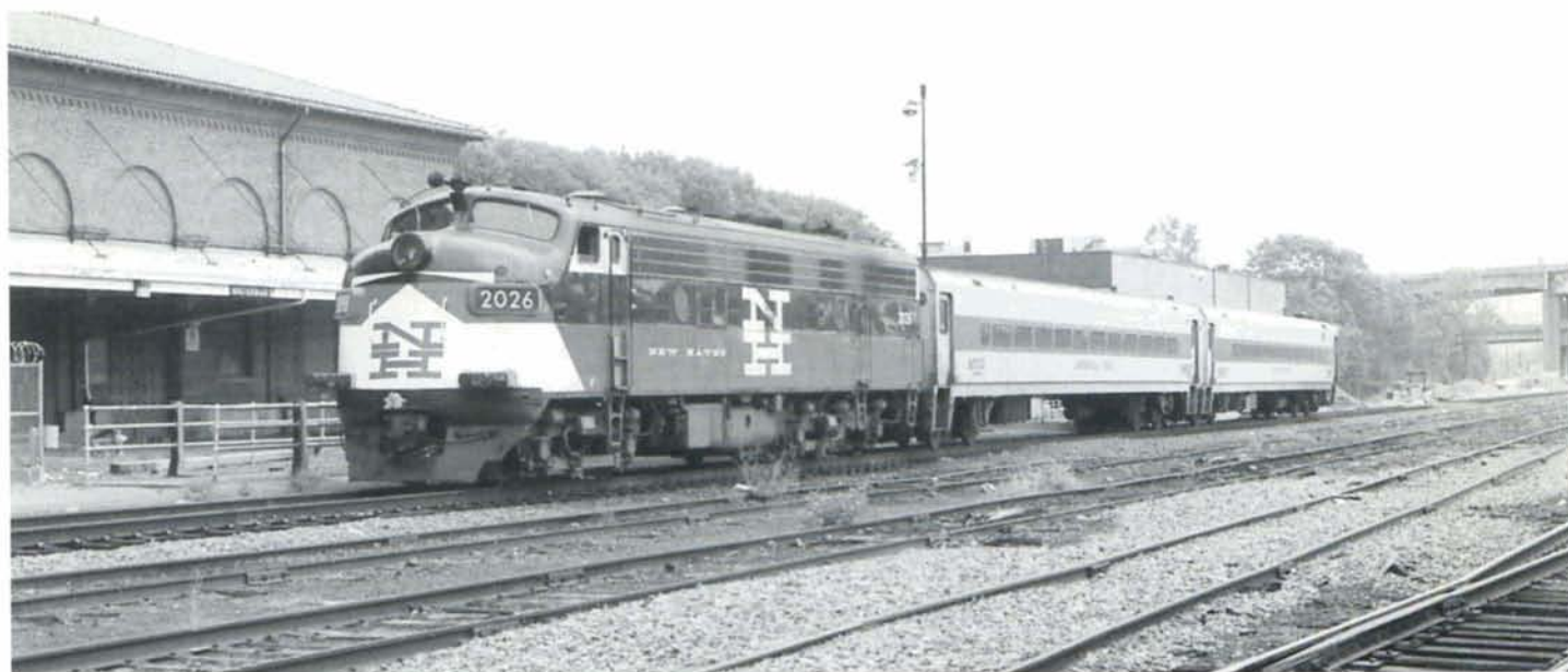
PHOTO 23-12 La FL9 : l'ultime modèle de "gros nez" produit par GM de 1957 à 1960. Ici, la FL9-2026 (ex. New Haven 2007), repeinte dans la version d'origine du New Haven, attend en gare de Waterbury, le départ vers Bridgeport.
