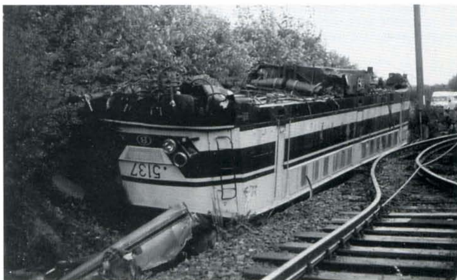
La 5137 après avoir pris en écharpe un train de marchandises à la sortie de la gare de Montzen côté Visé. La machine a quasiment effectué un tonneau et a terminé sa course sur le toit. Elle fut mise hors exploitation en date du 01-11-1995. Ph. : Georgy LEJEUNE.
