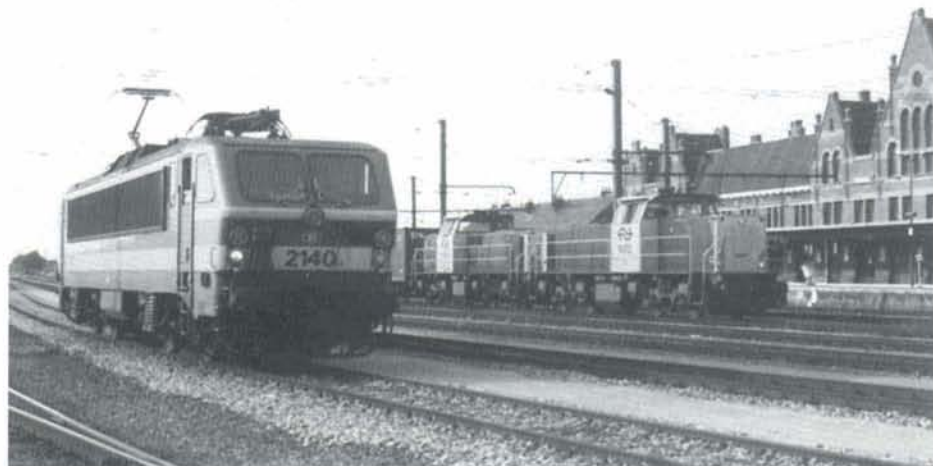
PHOTO 24-34 Lors de son passage en RI en septembre dernier, le pantographe Brecknell-Willis équipant à titre d'essai la 2140 a été remplacé par un pantographe Faiveley classique. Le 30 mai 1995, la 2140 allait relayer les 6412 et 6406 des NS en gare de Essen. C'est le panto Brecknell-Willis qui est levé. Photo : J-L VANDERHAEGEN.
