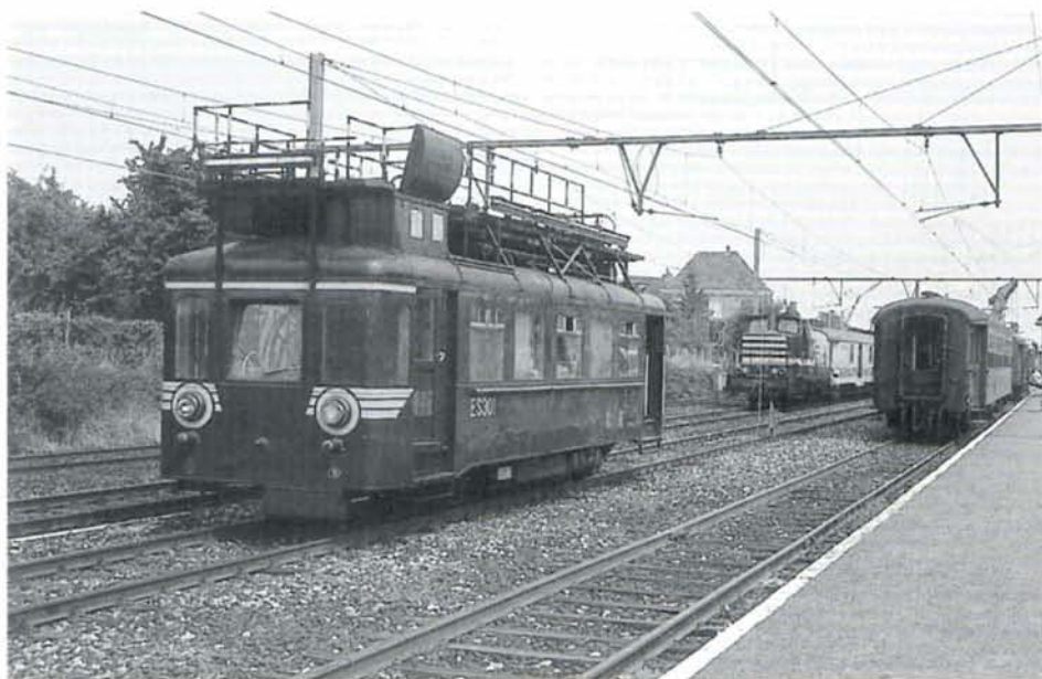
L'ES 301 (ex. 551.34), dernier engin de sa série en activité, a été retiré du service et conservé comme pièce historique par la SNCB. En juillet 1982, il participait aux travaux de réparation de la caténaire endommagée suite à la catastrophe d'Aalter. Ph.: P. HERBIET.
