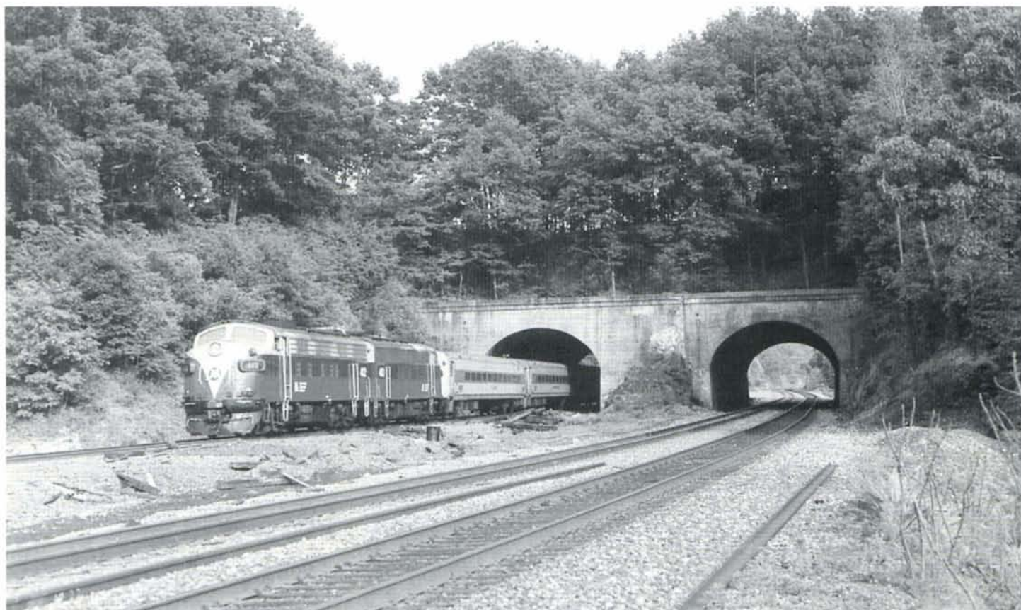
PHOTO 24-21 Les quatre locomotives de la série F10 du Metro-North (numérotées 410 à 413) ont été rachetées en 1991-1992 au réseau du MBTA (Massachusetts Bay Transportation Authority) à Boston. Les F10 proviennent de la reconstruction de machines du type F7 originaires du réseau du GM&O (Gulf, Mobile & Ohio). Deux locomotives de cette série, les F10 410 (ex. MBTA 1109, ex. F7 807-B du GM&O) et 412 (ex. MBTA 1150, ex. IGC (Illinois Gulf Central) 1620, ex. GM&O 85-A), assurent exceptionnellement un train New York-Poughkeepsie. Les F10 circulent en effet habituellement en seconde position, derrière une FL9, du fait qu'elles ne sont pas bi-modes. Le train est photographié à la sortie du tunnel d'Oscawanna, le 6 juin 1995. Photo : Jean-Luc VANDERHAEGEN.
