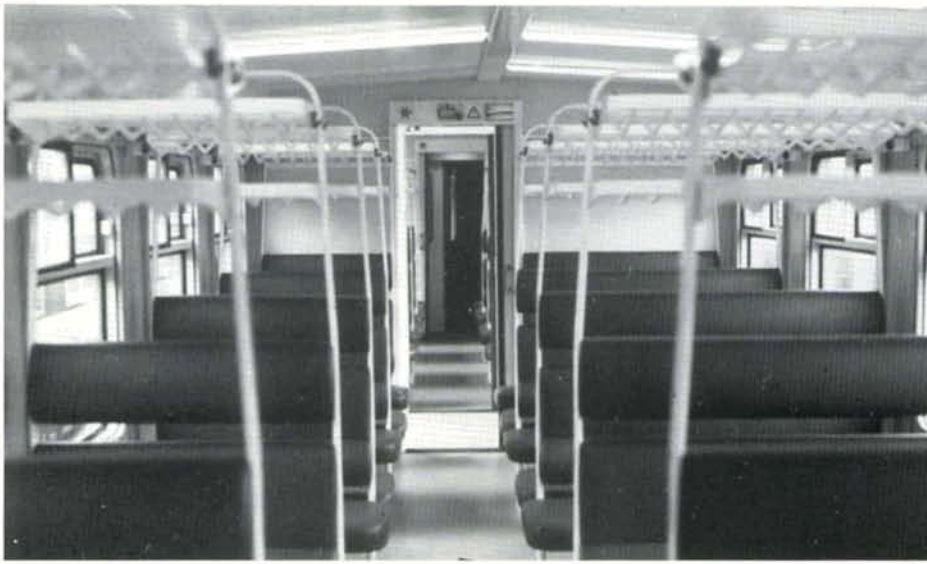
PHOTO 25-52 Voiture B 52.417 : banquettes inchangées recouvertes de similicuir d'un bleu verdâtre, parois intérieures plus claires, nouveaux revêtement de sol. Ajoutons que les toilettes des deux premières voitures sont équipés d'un WC chimique.
