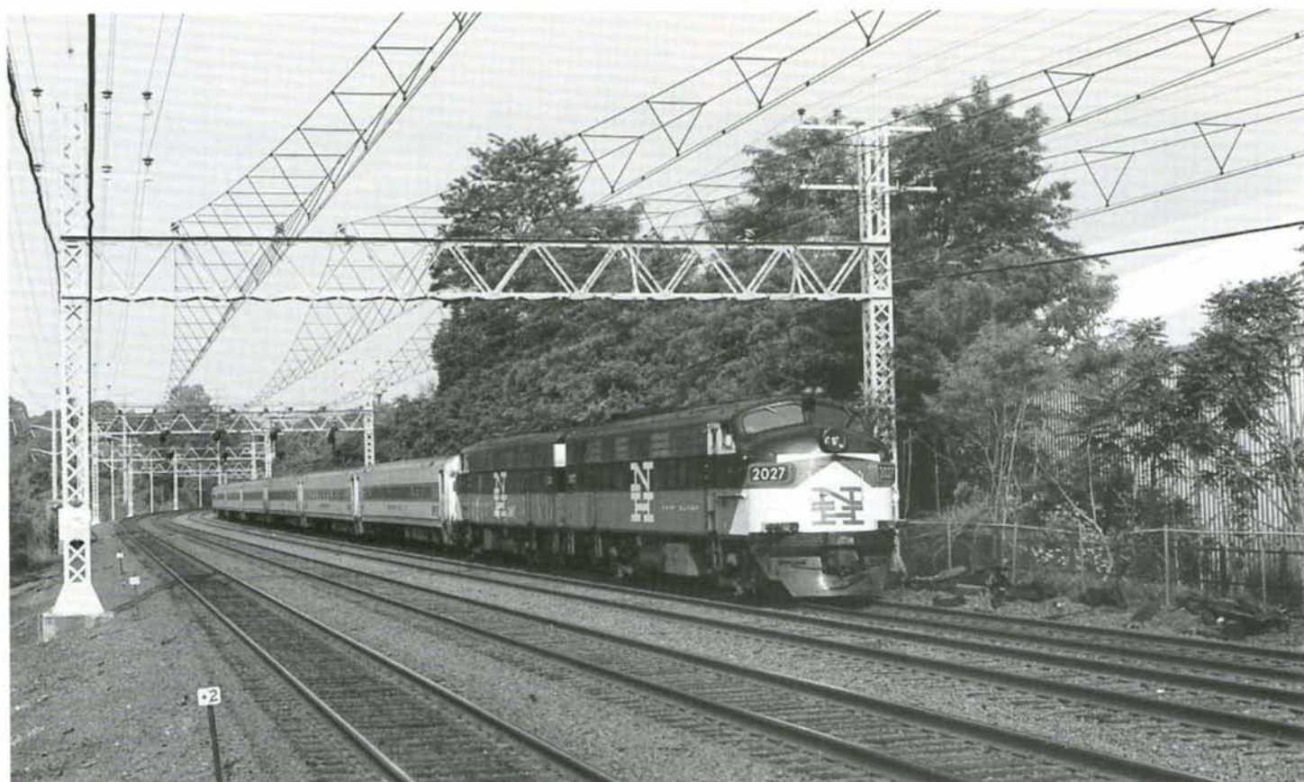
PHOTO 25-03 Un train de navetteurs Danbury - New York Grand Central Terminal poussé par un couplage de deux FL9 revêtues de leur livrée "Mac Ginnis" d'origine : les 2027 + 2011. Le convoi est photographié sur le corridor Nord-Est à Old Greenwich. On remarquera la caténaire triangulaire datant de l'origine de l'électrification de la ligne en 1907. 8 juin 1995.
