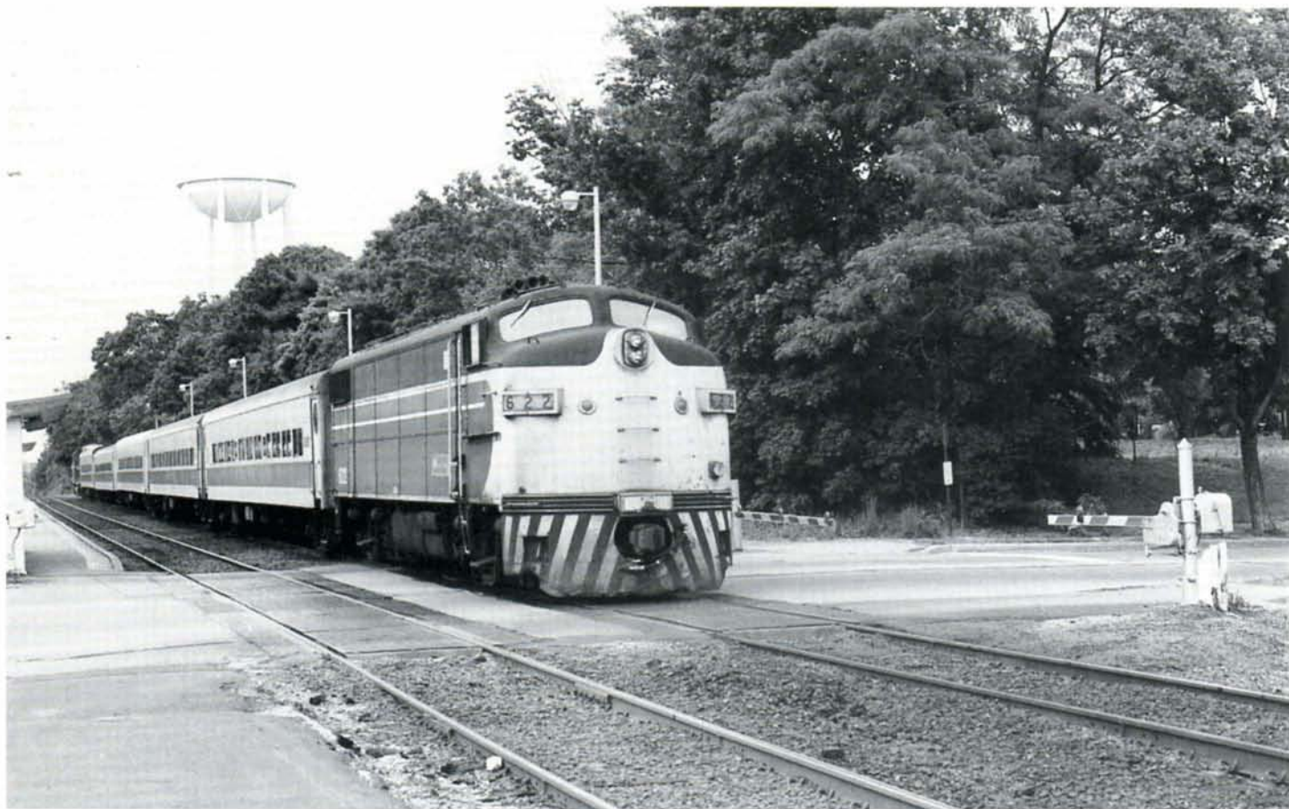
PHOTO 25-04 Le Long Island Railroad dispose de voitures-pilotes fort originales, en l'occurrence des anciennes locomotives démotorisées du type F7 et F9 de GM et du type FA-1 et FA-2 d'Alco. Ce document montre un train à destination de Port Jefferson. La voiture-pilote est une ancienne F7 renumérotée 622 (à l'origine : Baltimore & Ohio 265-A puis 4524). Cet engin dispose d'un moteur diesel Detroit servant pour l'alimentation électrique de la rame (chauffage et éclairage). Autre curiosité : les 5 voitures composant la rame sont elles-mêmes d'anciennes automotrices démotorisées! Albertson, 10 juin 1995. Photo : Jean-Luc VANDERHAEGEN.
