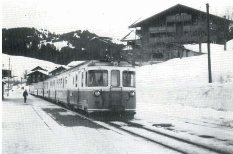
Une image classique du MOB : un train régional composé de l'automotrice double ABDe 8/8 4001 remorquant 5 voitures à bogies, en gare de Saanenmöser. Le MOB possède 4 automotrices de ce type (4001-4004) mises en service en 1964 afin de renforcer le parc. Photo : Jean-Claude GODTBIL.
