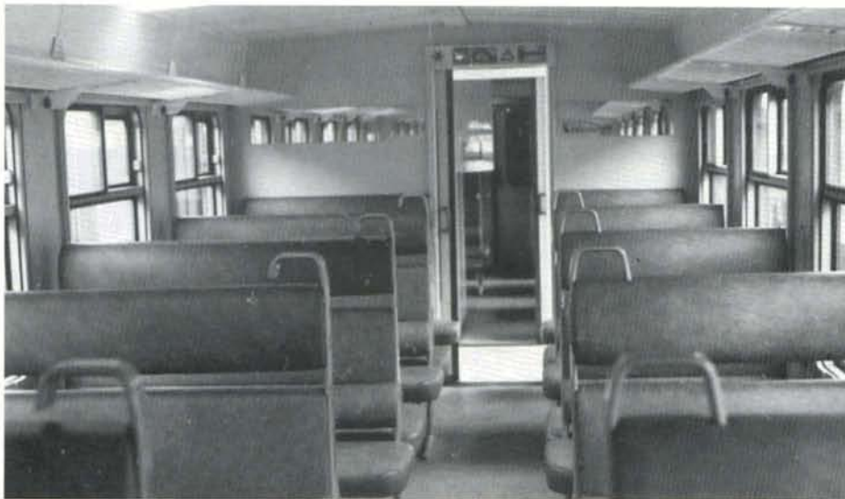
PHOTO 25-53 Dans la troisième voiture (M4 B 52.347), seul le compartiment central a été réaménagé. Les banquettes d'origine sont recouvertes d'un similicuir gris bleuté, et ont été dépourvues de leur porte-bagages, ceux-ci étant placés longitudinalement. Le sol est recouvert d'un linoléum moucheté gris beige. Des glaces sont disposées sur les parois d'about.
