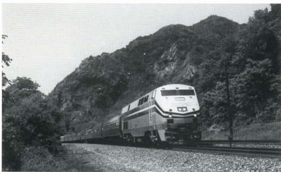
PHOTO 25-41 La relève des FL9 de l'AMTRAK et du Metro-North est concrétisée par une version bi-mode de la locomotive type AMD-103 (ou P32AC) de General Electric. Ici, la 800 remorquant le "Lake Shore Limited" entre Chicago et New York, en passage à Breakneck Bridge le long de l'Hudson, le 5 juin 1995. Photo : J-L VANDERHAEGEN.
