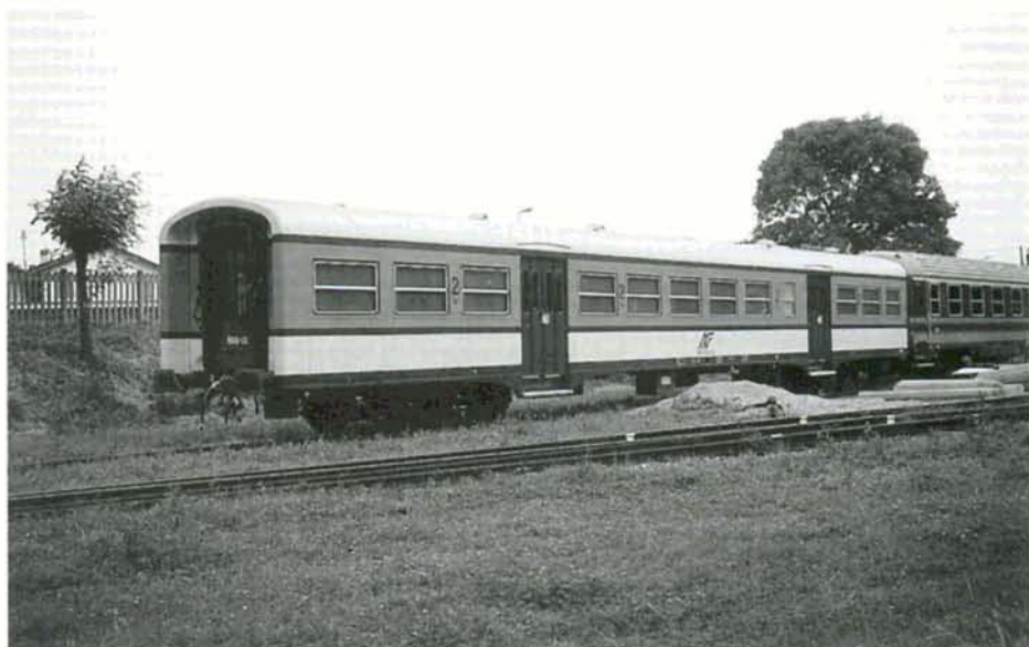
La voiture FNM EB900.11, ex. M3 SNCB, photographiée à sa sortie de rénovation à l'atelier Metalmeccanica Milanesia à Moretta, le 7 juin 1995. Photo : Michele CERUTTI.
