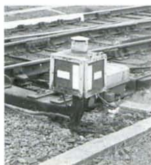
PHOTOS 28-19 et 28-20 Une curiosité ferroviaire a été démontrée à Forest-Midi : un des derniers (ou le dernier?) indicateurs de position d'aiguilles, d'origine allemande. Ph. : J-L VANDERHAEGEN.
