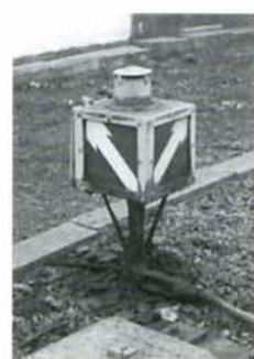
PHOTOS 28-19 et 28-20 Une curiosité ferroviaire a été démontrée à Forest-Midi : un des derniers (ou le dernier?) indicateurs de position d'aiguilles, d'origine allemande. Ph. : J-L VANDERHAEGEN.
