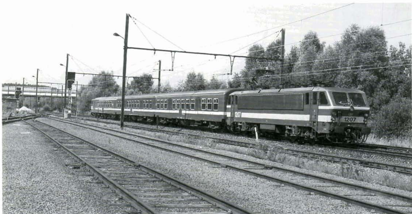
PHOTO 28-26 Assuré par une rame réversible M4 poussée par la 1207, le train L E6318 Mons-Lille passe à hauteur du faisceau abandonné de Jemappes Gare charbonnière. Ces installations sont maintenant démontées et la commande des signaux est opérée par le poste PLP de St-Ghislain. Jemappes, 16 août 1994. Photo : P. DIEU.
