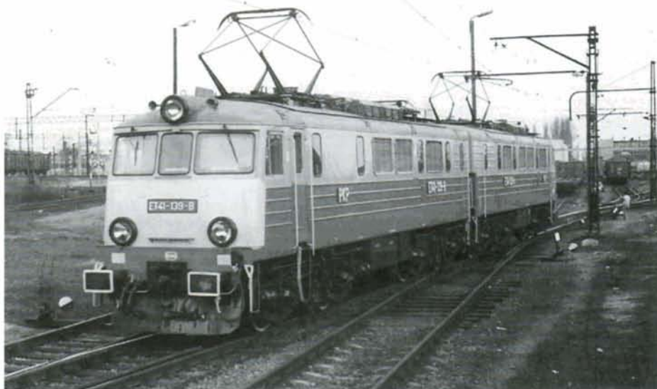
PHOTO 28-02 Lors de la visite du dépôt de Poznan-Franowo, la superbe locomotive électrique double ET41-139-B/139-A fut visible. Les PKP possèdent trois séries de machines électriques doubles, les ET40, ET41 et ET42. Au nombre de 200, les ET41 furent construites par Ciegelski de 1977 à 1985. Leur puissance atteint 4.160 kW, leur masse totale 160 à 167t, et leur longueur 31,800m. Photo : Alain DEFECHEREUX.
