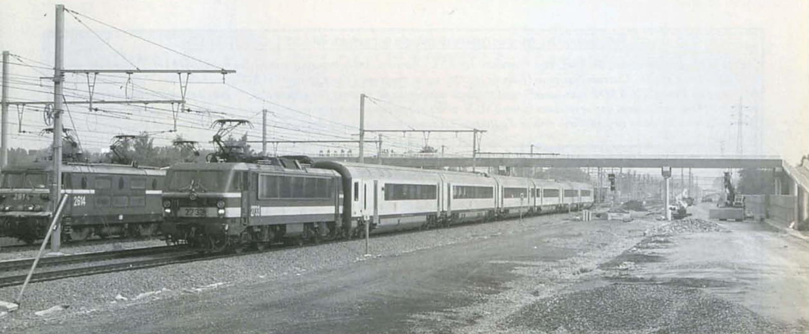
Retour vers Mons des automotrices 442 et 444 qui ont effectué des essais dans les aiguillages de Bruxelles-Midi afin de déceler l'origine de l'usure anormale des plaques de friction entre bogie et caisse. Halle, 24 septembre 1996. Photo : Christian DOSOGNE.
