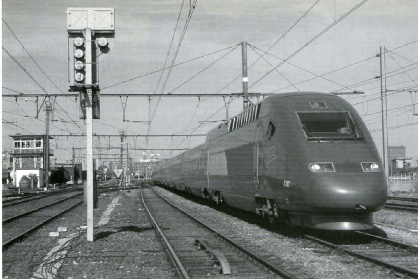
Gros plan sur la motrice dont la forme est en fait semblable aux motrices des rames TGV Duplex (à deux étages), dont on remarquera le pare-brise unique et la hauteur plus grande. Bruxelles-Petite-Ile, 20 août 1996. Photo : Christian DOSOGNE.
