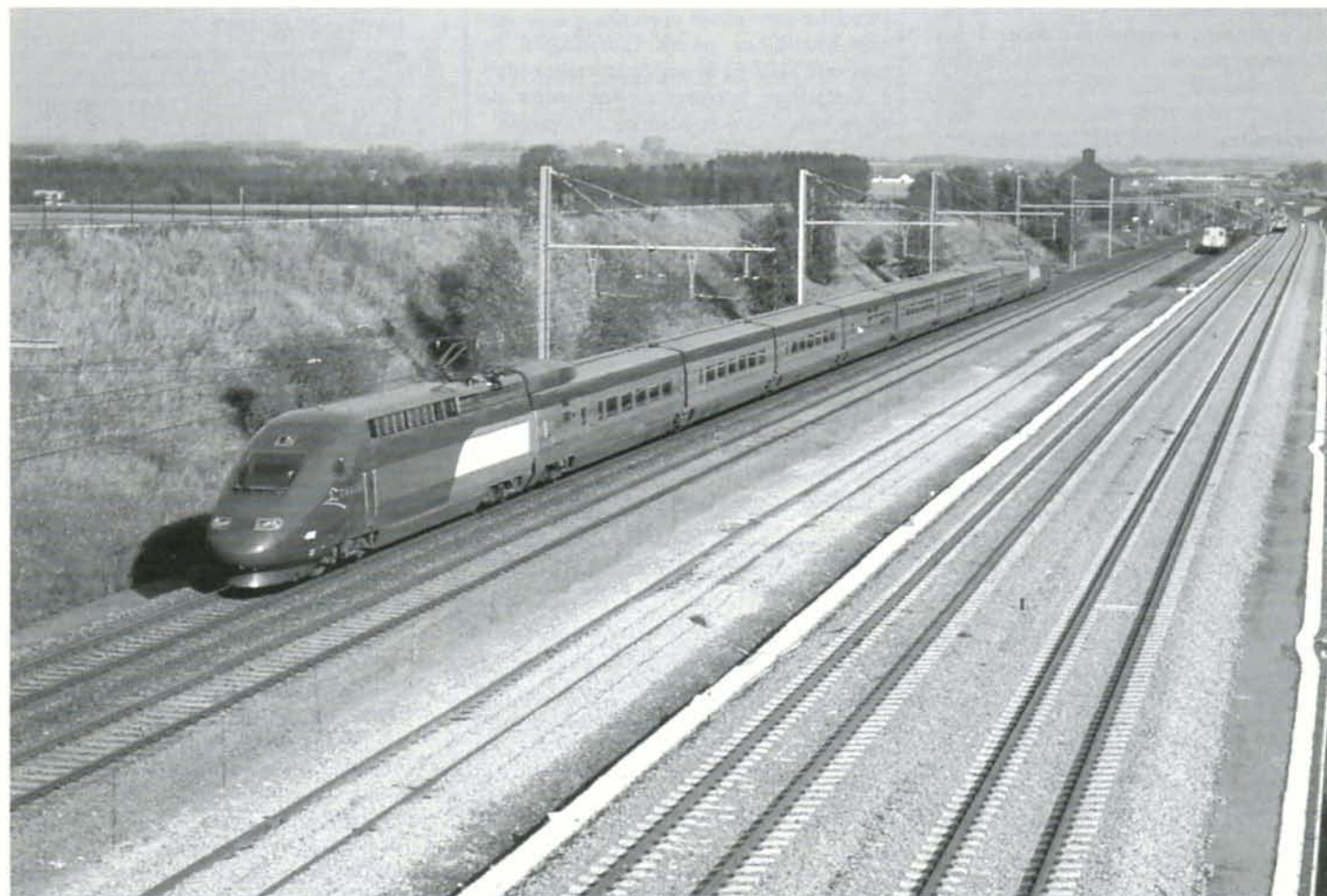
Du 16 au 25 octobre, la rame 4341 a effectué une campagne d'essais en Belgique dans le but de vérifier les spécifications techniques de l'accélération et du freinage établies par l'ACEC. Elle est photographiée le 22 octobre entre Silly et Meslin. Dia : C. DOSOGNE.
