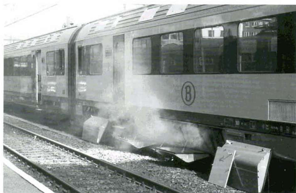
La mise au point des automotrices type 1996 semble bien difficile, comme en témoigne ce document où l'on voit l'armoire haute tension de l'automotrice 443 en feu, ce qui nécessite l'intervention des pompiers. Tournai, 5 septembre 1996. Photo : Alain ELOOT.
