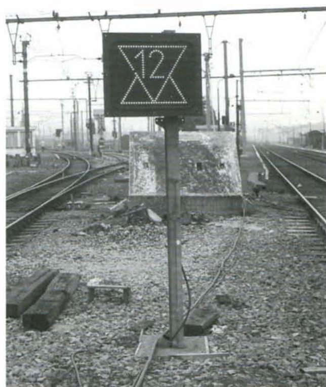
PHOTO 28-18 Le nouveau signal de vitesse sélectif implanté en gare de Forest-Midi.
