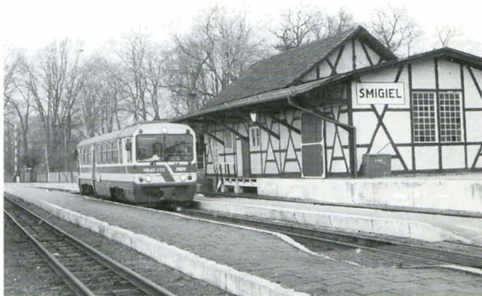
PHOTO 28-04 Le troisième réseau à voie étroite visité : la ligne reliant Stare Bojanowo à Wielichowo (voie de 750 mm). L'autorail MBxd2-226 de construction récente (FAUR 23 August en Roumanie construit à 44 exemplaires (dont 13 pour voie de 1000 mm) de 1985 à 1988, type B' 2', puissance 141 kW) marque l'arrêt dans la pittoresque gare de Smigiel, alors que la neige commence à tomber. Photo : Jean-Luc VANDERHAEGEN.
