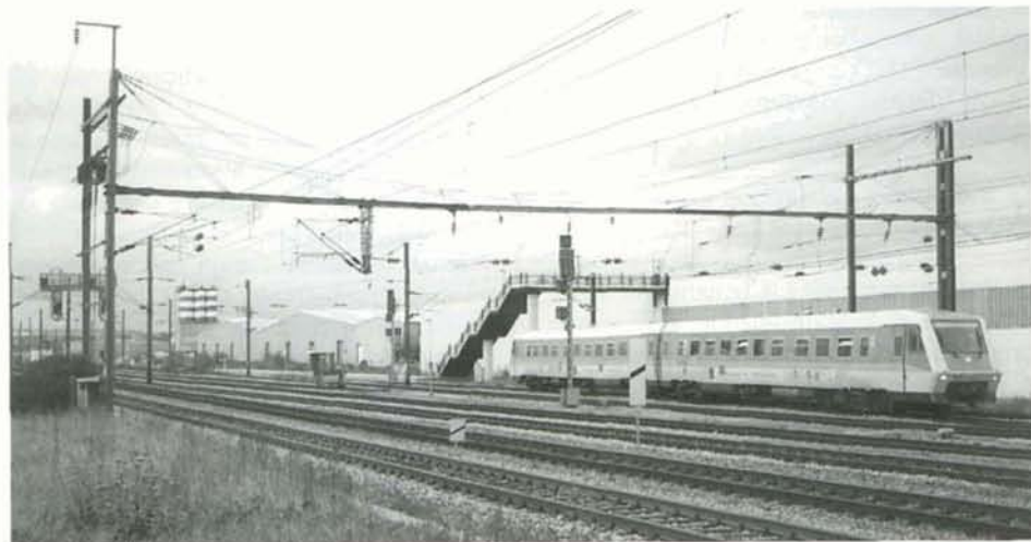
Le nouvel autorail pendulaire de la DB s'engage sur la ligne 6 pour un parcours de démonstration à destination du triage de Bettembourg. Les VT 611 possèdent une transmission hydraulique et un système électrique d'inclinaison des caisses, contrairement aux VT 610 (circulant dans la région de Nürnberg) qui sont pourvus d'une transmission électrique et d'un système hydraulique FIAT d'inclinaison des caisses. En principe, les VT 611 auraient notamment dû assurer des relations Régional Express Saarbrücken-Frankfurt depuis le début de l'horaire d'hiver 96-97, mais furent rapidement retirés du service suite à d'innombrables problèmes techniques. Luxembourg-Howald, 5 octobre 96. Photo : Pierre BERCHEM.
