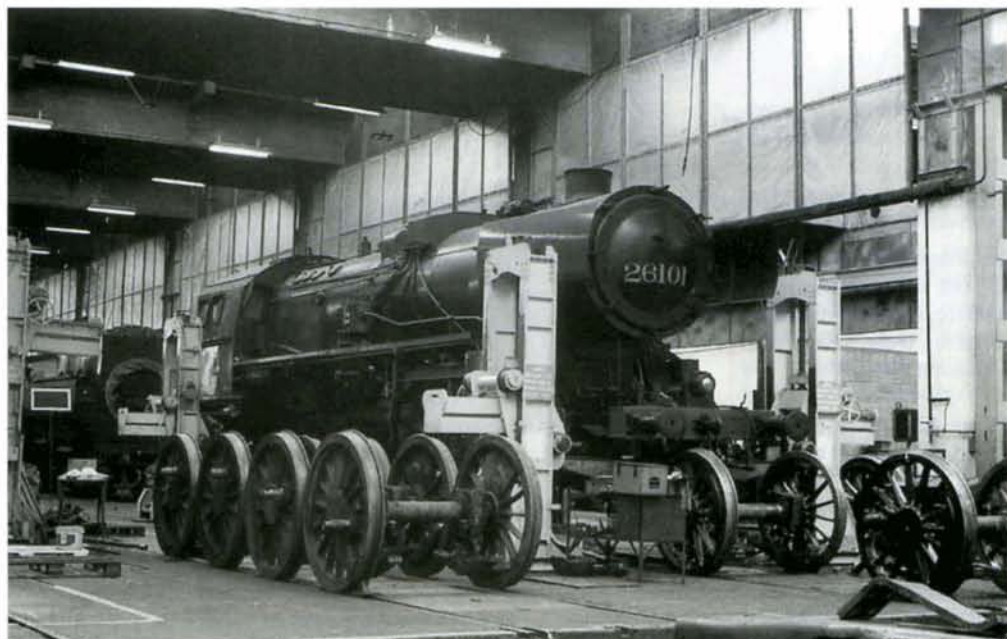
PHOTO 30-30 La 26.101 au levage. Après un examen approfondi (passage aux ultrasons, radiographies, mesures de la résistance électrique, etc.), tous les essieux ont été déclarés bons pour le service et sont prêts à être remontés sous la machine (à droite). A gauche, un train complet d'essieux de rechanges acquis en Pologne " au cas où "... a provisoirement servi en attendant le retour des essieux originaux de Salzinnes. Atelier de Schaerbeek, février 1997.
