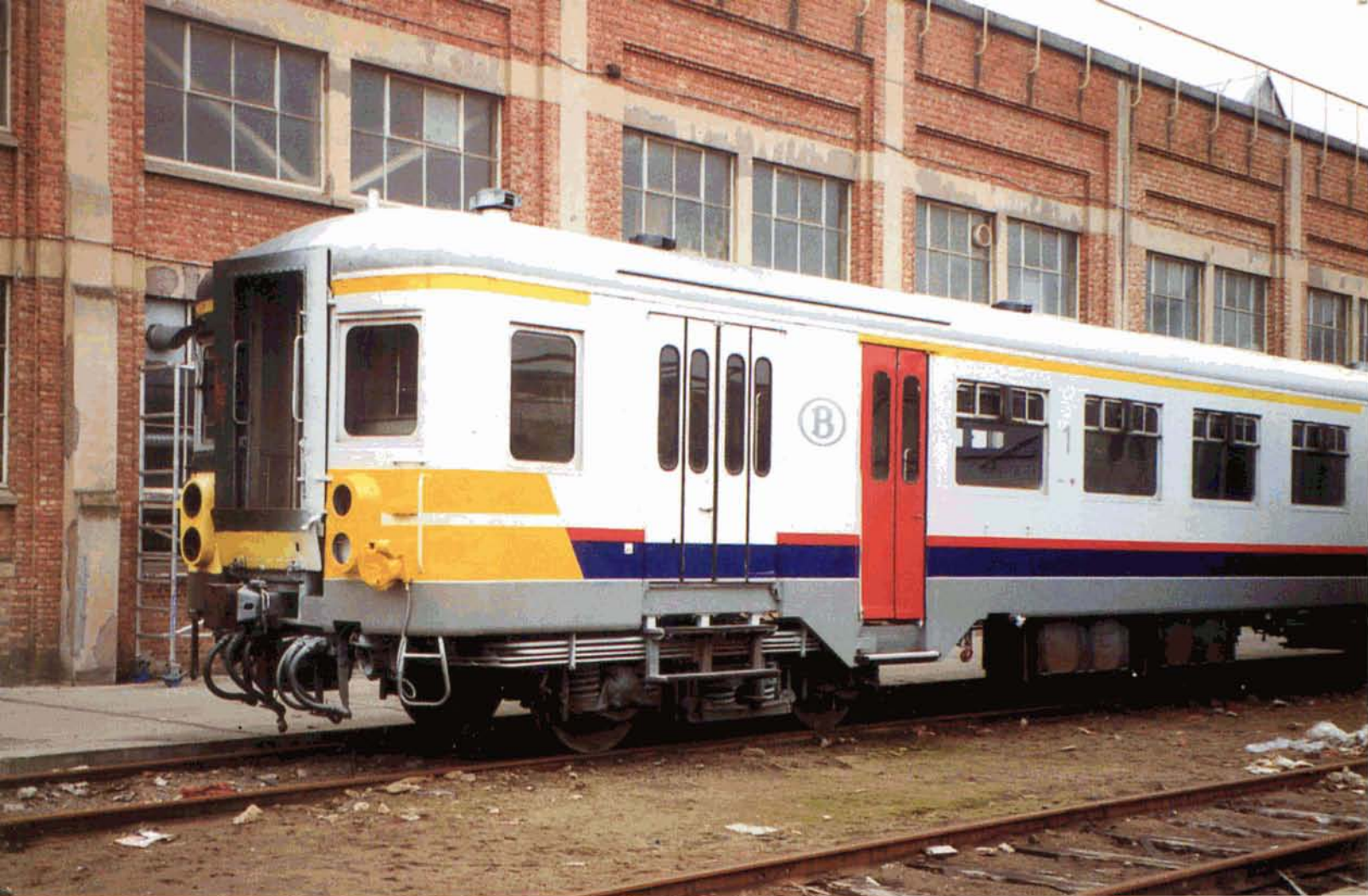
PHOTO 30-10 La modernisation prochaine des automotrices doubles classiques se concrétise peu à peu. Après la voiture B 1721 de la rame 172, la voiture ABD 1992 de la rame 199 a également été prélevée pour servir de prototype. On comparera le dessin des faces frontales des deux automotrices se distinguant par le graphisme des bandes jaunes de visibilité. AC-Mechelen, mars 97. Jan PEETERS.
