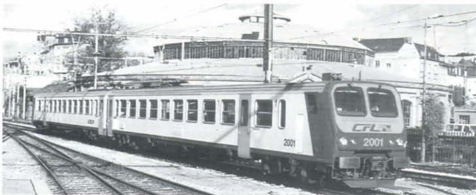
**PHOTO 33-16** *Nouveau graphisme pour les Z2. Sur les faces avant, le numéro est situé entre les phares tandis que le nouveau logo CFL est placé sous les pare-brise. En outre, les logos CFL apposés en diagonale à l'avant des parois latérales à hauteur de la petite fenêtre des cabines de conduite, ont disparu. Photo : Alain DEFECHEREUX.*
