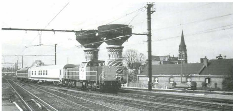
**PHOTO 34-20 ↑ et 34-21 ↓** Dans le cadre de la l'étude des futures locomotives de la série 77, des parcours d'essais de stabilité ont été réalisés avec la locomotive 6459 des NS, entre Antwerpen-Oost et Ekeren le 9 avril 1998. La rame était composée de la 6459, de la voiture de mesure 0601 et de la locomotive-musée 201.010. Ci-dessus à Antwerpen-Oost, ci-dessous à Ekeren. Photos : Yvo VAN STEENWINKEL.
