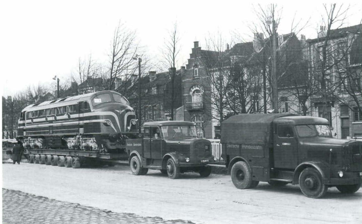
**PHOTO BD-027** La machine est chargée et le convoi, remorqué par deux tracteurs de la DB, est prêt au départ vers l'esplanade du Heysel. Photo : Bruno DEDONCKER, collection PFT ©.
