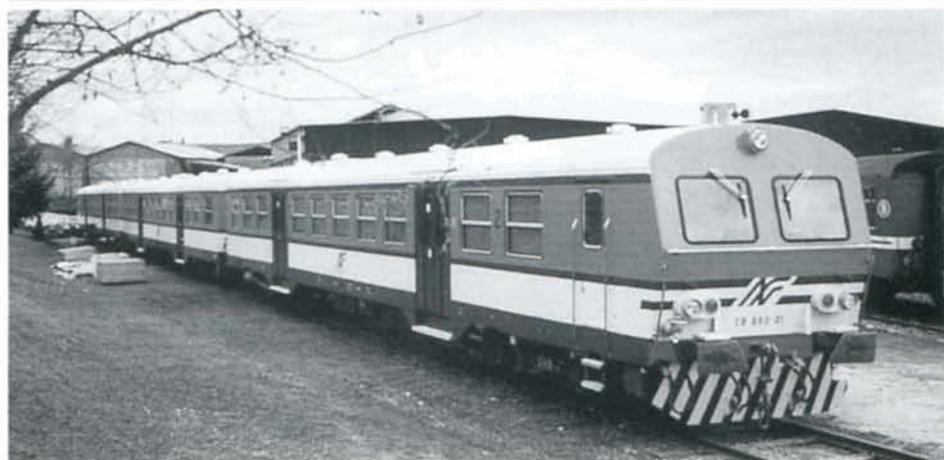
La voiture EB 880-01 du Ferrovie Nord Milano (FNM), ex. M2 SNCB, transformée avec une cabine de conduite. Cette transformation a été réalisée sur base des plans SNCB des M2 BDx électriques. Pour rappel, le FNM avait racheté en 1997 un lot de 24 voitures M2 (voir EL 32 p. 4 à 11). Atelier de Metalmeccanica Milanese, 8-12-97. M. CERUTTI.
