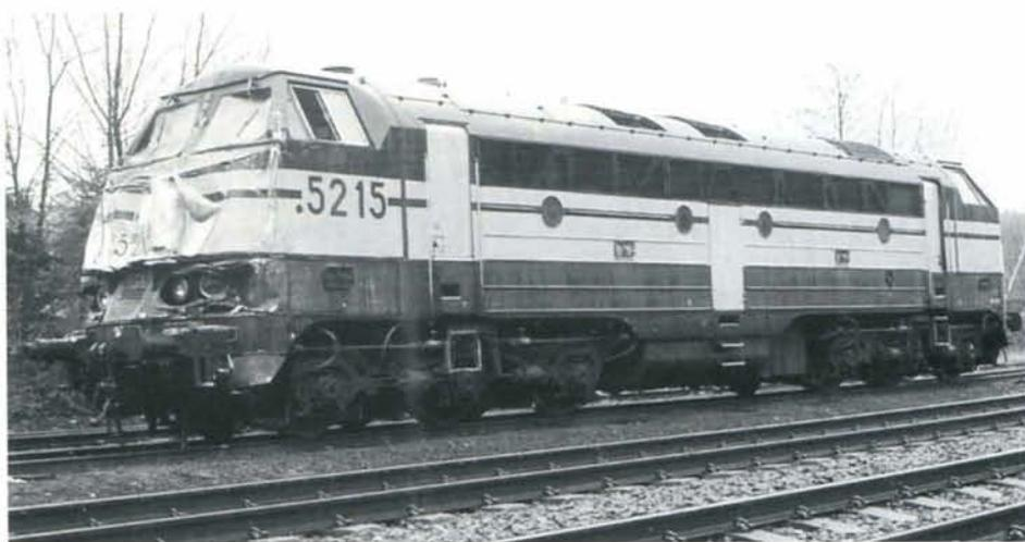
**PHOTO 34-29** Les dégâts à la 5215 sont beaucoup plus limités. La cabine sera remplacée par celle provenant de la 5217. Gedinne, 14 mars 1998. Photo : K. AVONDS.
