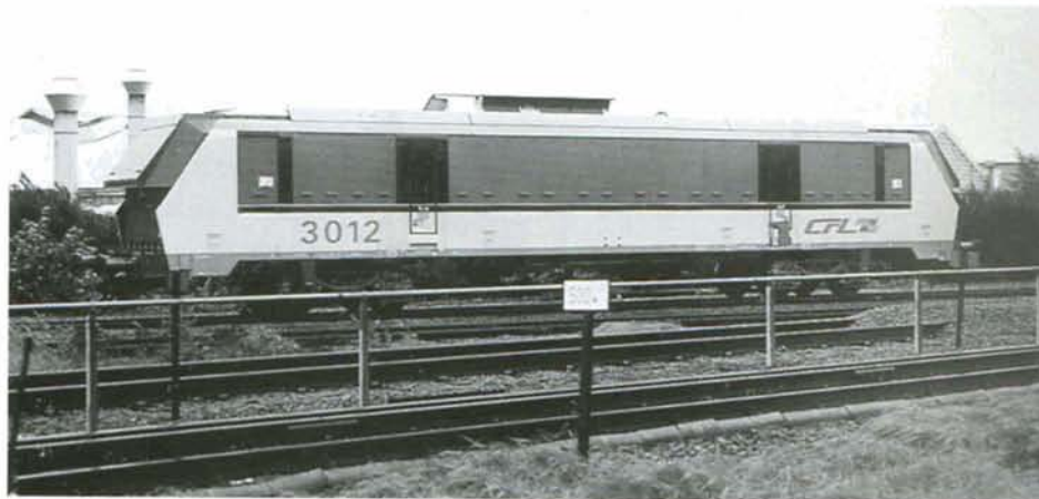
PHOTO 37-38 Les caisses des 80 locomotives sont assemblées par Alstom à Belfort. La BN à Brugge n'assure que le montage final de l'équipement, et la finition. La caisse de la 3012 à son arrivée à Brugge, le 16 octobre 1998. Photo : Jean-Luc VANDERHAEGEN.
