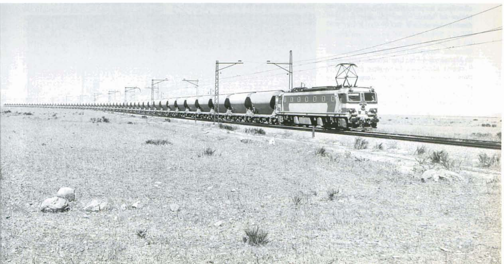
PHOTO 37-10 La E 1201 en tête de la rame vide de phosphate 665 Jorf Lasfar - Oued Zem traverse le plateau des phosphates à Sidi Hajjaj, non loin de Khouribga, le 9 octobre 1998. Cette locomotive a été fournie en 1982 par Mitsubishi (série E 1201 à 1208). Vu l'importance du trafic des phosphates, cette ligne a été électrifiée en 1927 et mise à double voie en 1964. Photo : Alain DEFECHEREUX.
