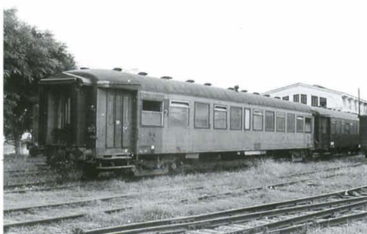
PHOTO 37-26 et PHOTO 37-27 Les voitures belges n'ont subi que peu de modifications après leur arrivée au Maroc. Parmi les plus visibles, on notera le remplacement des soufflets d'intercirculation par des caissons munis de bourrelets de caoutchouc, et l'échange de certains bogies par des bogies provenant d'anciennes voitures françaises. Seules les voitures récemment révisées ont été repeintes dans les nouvelles couleurs de l'ONCF, soit une trentaine d'unités dont les 8 K2 BD transformées en fourgon-générateur et les 10 I3; les autres voitures encore vertes n'ont jamais été repeintes depuis leur départ de Belgique. Ci-dessus à gauche, gros plan sur une plateforme d'accès de la voiture 1464, montée sur des bogies français du type Y20. Fès, 3 octobre 1998. Ci-dessus à droite : la voiture 1285, ex. K2 SNCB 50 88 21 48156-3, montée sur des bogies français du type Y26. Meknès, 5 octobre 98. Photo : J-L VANDERHAEGEN.
