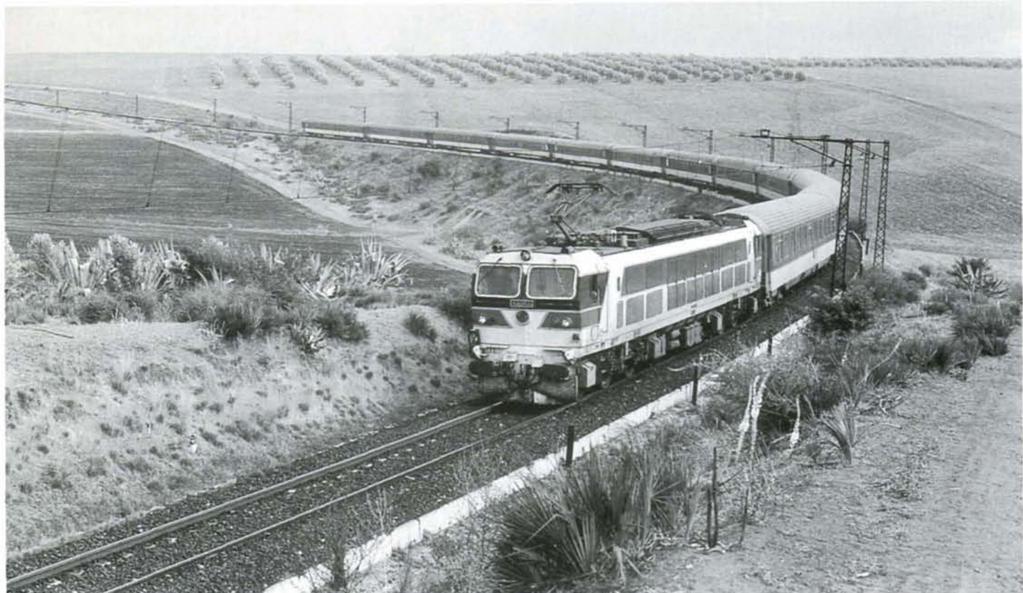
PHOTO 37-11 Les E 1251 à 1262, livrées en 1984, forment la troisième et dernière série de machines fournies par Mitsubishi. Ces locomotives sont exclusivement utilisées au trafic des voyageurs. Le 4 octobre 1998, la E 1257 remorque le train FES 2 Fès - Marrakech, ici visible dans les environs de Ain Taoujdade, sur une section à très forte rampe entre Fès et Meknès. Photo : J-L VANDERHAEGEN.
