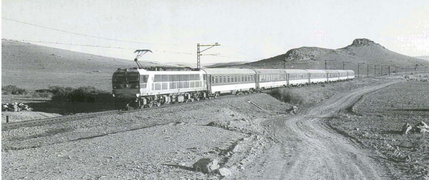
PHOTO 37-34 Dans un décor lunaire, le train MNR2 Marrakech - Casablanca Port arrive à Sidi Abdallah (section Benguerir - Sidi el Aida). A sa tête, la E 1255. Les E 1251 à 1262 sont les seules locomotives électriques équipées pour assurer l'alimentation de la climatisation des voitures, ce qui explique l'absence d'un fourgon-générateur. Photo : Jean-Luc VANDERHAEGEN, 8 octobre 1998.
