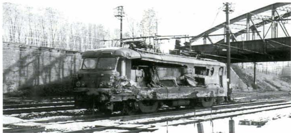
La 2602 entièrement éventrée par la prise en écharpe de Weerde le 3 décembre dernier. Photo : Paul BLOND.
