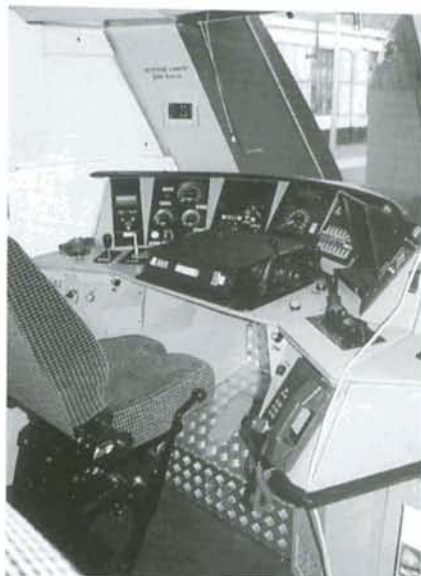
PHOTO 37-36 Vue du pupitre de conduite de la 3001 CFL. Ph. SCHOLL.
