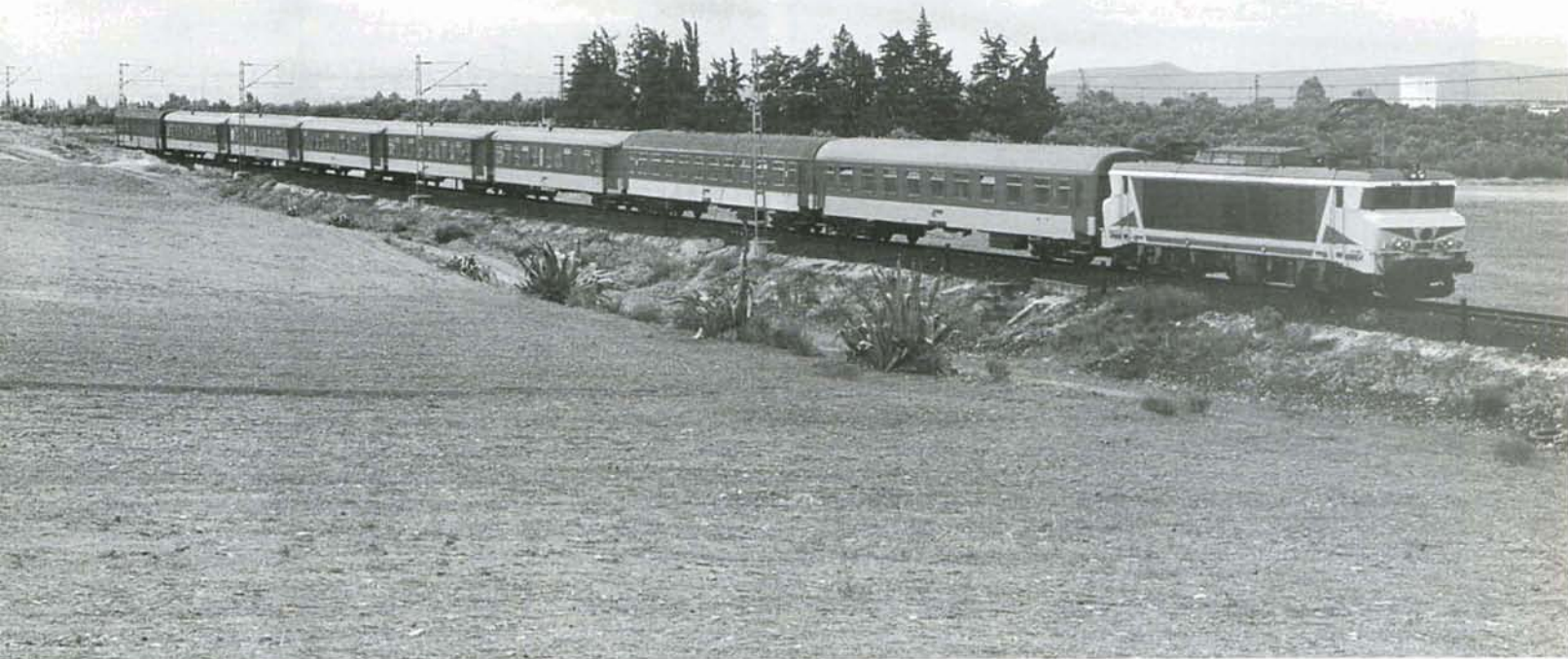
PHOTO 37-23 Le train 1 Casablanca - Fès est généralement composé de 5 voitures K2 et de 2 voitures polonaises Kolmex, accompagnées par un fourgon-générateur. Ce parcours est ici visible à Ras-el-Ma, peu avant Fès, tracté par la E 1306 le 4 octobre 1998.
