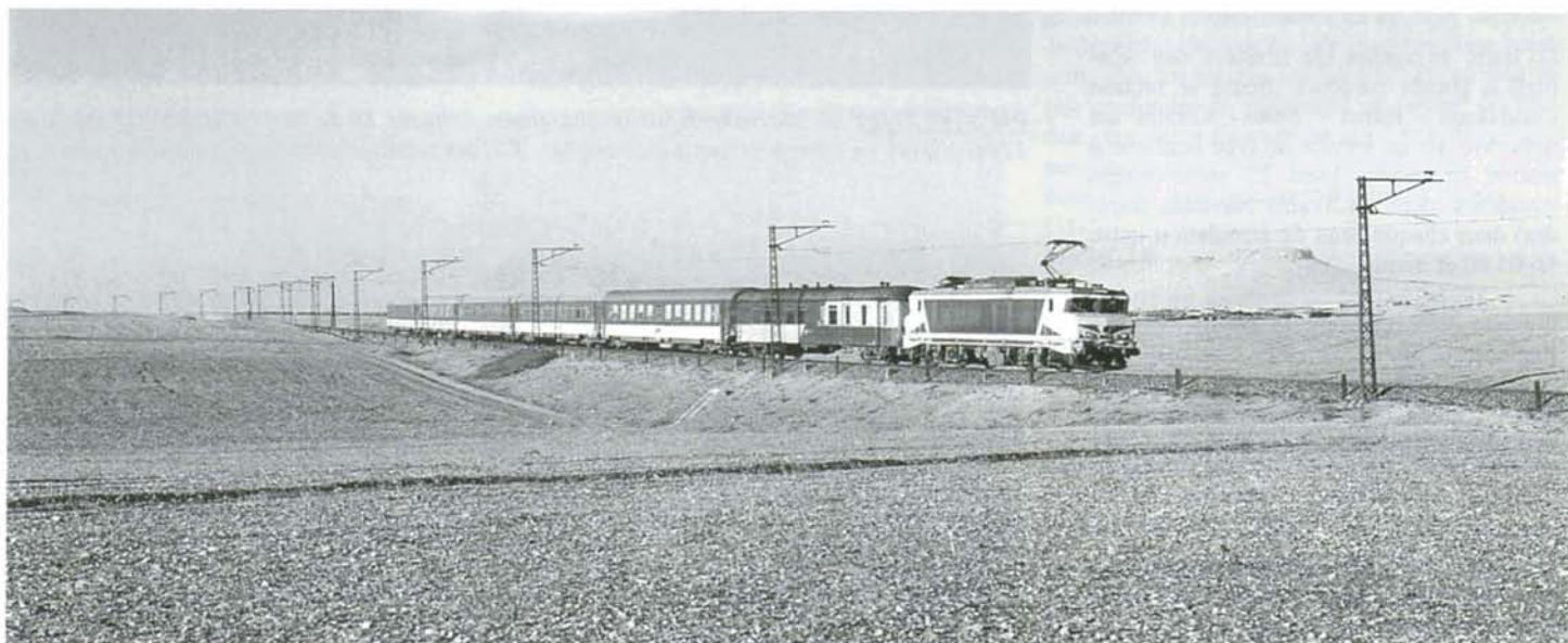
PHOTO 37-28 Le train MMN2 Marrakech - Fès remorqué par la E 1303 vient de quitter Benguerir, le 8 octobre 1998. Une voiture fourgon-générateur ex. K2 BD assure l'alimentation électrique de la rame. Photo : Alain DEFECHEREUX.
