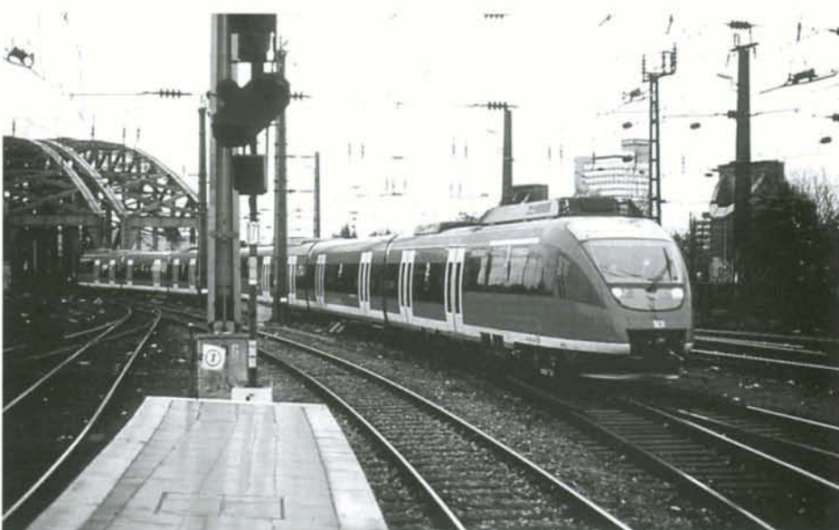
Les autorails Talent VT 644.006 et 008 photographiés lors d'un parcours d'essai à Köln-Hbf, le 2 novembre 1998. Les VT 644 sont équipés de deux moteurs Diesel de 450 kW et peuvent atteindre 120 km/h. Photo : Christian VANHECK.
