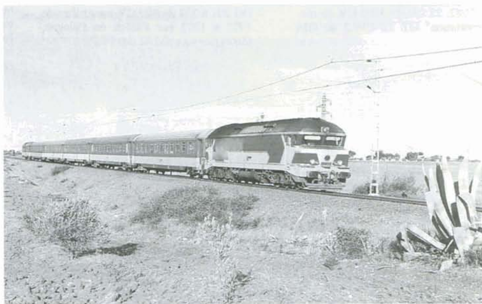
PHOTO 37-14 La DF 112 en tête du train TGR 1 Fès - Tanger, à Ras-el-Ma (ligne Fès - Meknès), le 3 octobre 1998. Alsthom livra 14 locomotives de ce type de 1968 à 1970, dérivées des CC 72.000 de la SNCF. Photo : Alain DEFECHEREUX.
