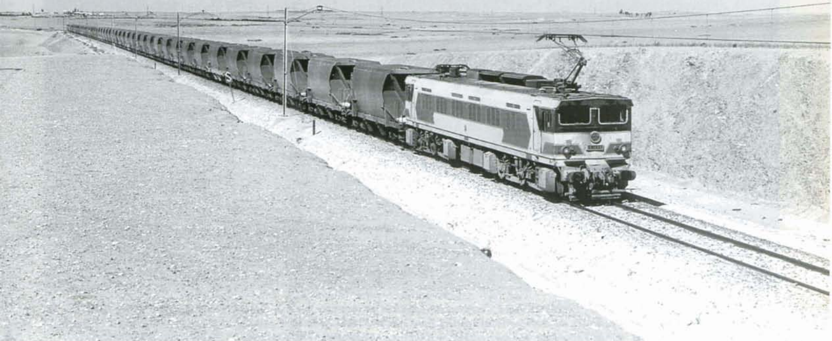
PHOTO 37-09 Le train vide de phosphate 636 Safi - Sidi Azzouz, remorqué par la E 1109, photographié à la sortie de Benguerir, le 7 octobre 1998. Cette série de 22 CC a été construite au Japon par Mitsubishi en 1976. Photo : Alain DEFECHEREUX.
