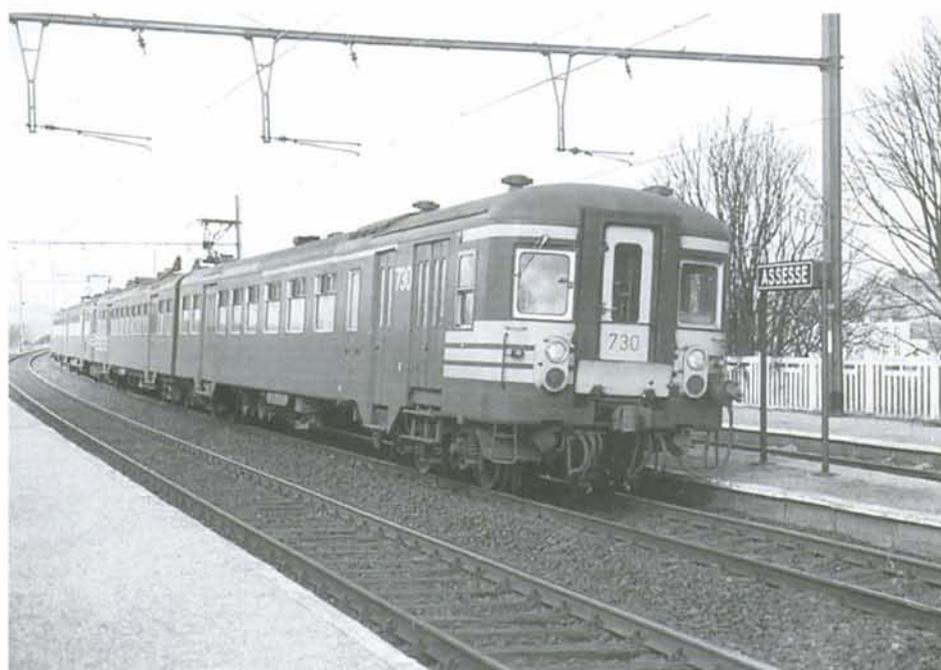
**PHOTO 39-06** L'automotrice 730 revêtue à titre d'essai des bandes de visibilité jaunes. On remarquera la grande dimension du numéro latéral. Assesse, 11 mars 1982. Photo : Jean-Luc VANDERHAEGEN.
