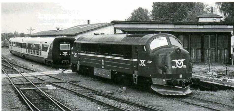
**PHOTO-THEME 32** La MX 101 du OHJ-HTJ (Odsherreds Jerbane - Hong Tollose Jerbane), devant la remise de Nykobing. A l'arrière, on distingue l'autorail double IC2 1122. Ce réseau possède quatre "gros nez" : les MX 101 à 104, ex. MX 1008, 1009, 1010 et 1029 des DSB). Photo : Yves STEENEBRUGGEN.
