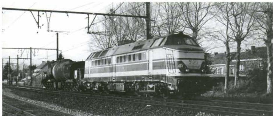
**PHOTO 39-47** Dans la perspective de l'instauration d'un nouveau trafic de fonte en fusion entre Dunkerque et Marcinelle, un train d'essai a circulé le 25 avril entre Tourcoing et Marcinelle. L'unique wagon-poche à 14 essieux était remorqué par la 5120 de Monceau, vu à la sortie de la gare de Ath. Photo : Philippe SCHOLL.
