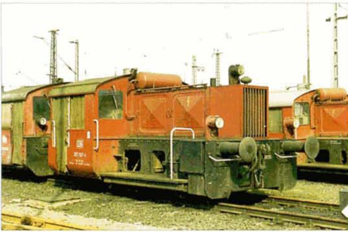
PHOTO 41-13 Le Köf II 323.507-4 de la DB garé au dépôt de Hamm, le 1er avril 1978. La cabine de conduite n'est pas modernisée et est démunie de portes et fenêtres. Jean-Luc VANDERHAEGEN.
