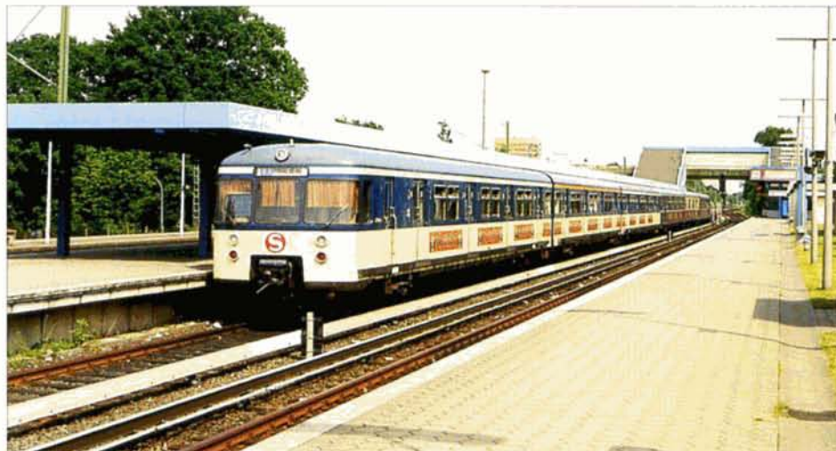
PHOTO 41-12 Les automotrices de la série 470 (ex. ET 170.1) se distinguaient de celles de la série 471 par leurs pare-brise plus larges offrant un meilleur champ de vision. Ici, deux 470 en service sur la ligne S3 Hamburg - Pinneberg, le 7 juin 1999. Pierre HERBIET.
