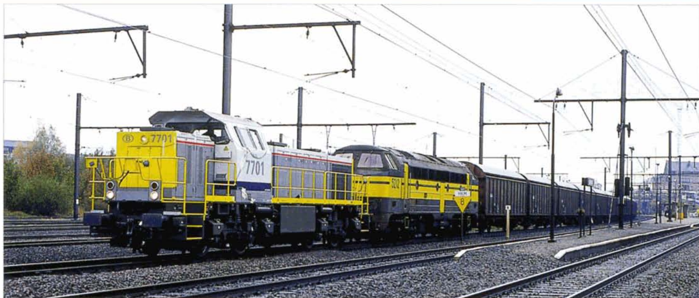
Le 26 octobre 1999, la 7701 a effectué un parcours aller-retour entre Ronet et Libramont afin de vérifier l'absence d'échauffement excessif des blocs de frein sur les longues pentes de la ligne 162. La 7701 était épaulée par la 5212. Ensembles, elles remorquaient un train de wagons vides représentant une charge de 600 t. Cette vue illustre l'arrivée à Libramont du train d'essais 95843 en provenance de Ronet. C. VANHECK.
