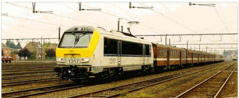
PHOTO 41-51 L'an 2000 verra, d'une part, la poursuite de la livraison des locomotives des séries 13 et 77, et des automotrices type "96" et, d'autre part, la fourniture des premiers autorails de la série 41. Le 14 octobre 1999, la 1317 fut testée en tête d'une rame de voitures M2, ici à son arrivée à Merelbeke. Jean-Luc VANDERHAEGEN.
