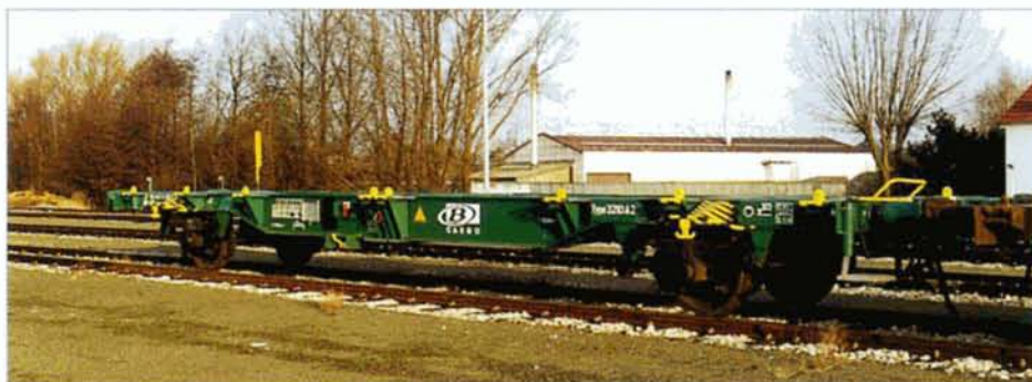
La SNCB a réceptionné au début de l'année, le dernier wagon porte-conteneur (UIC 21 88 4430 436-5) du type Lgnss (type 3210A2) faisant partie d'une commande de 100 unités auprès de la firme Astra en Roumanie. Merelbeke, 12 janvier 2000. Roger CRIKELAIRE.
