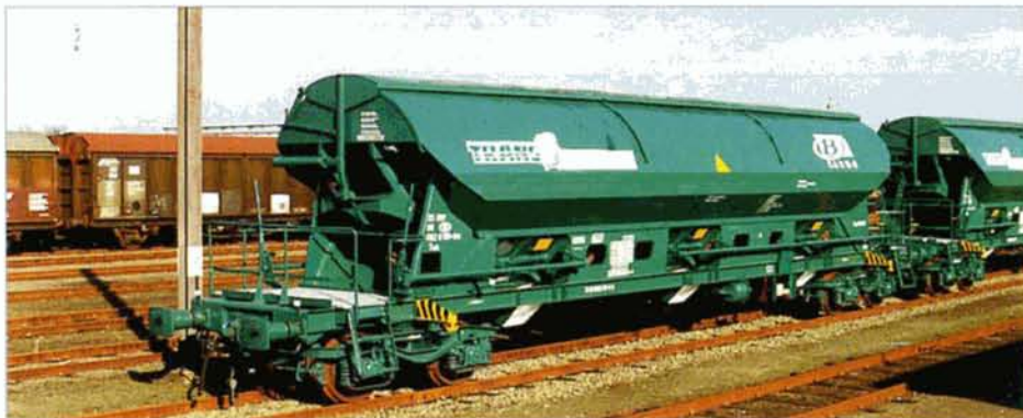
PHOTO 42-53 Depuis quelques mois, les wagons du type Tads ressortent de révision en arborant les couleurs de B-Cargo. La SNCB possède 900 Tads (500 de la série 1004D0 et 400 de la série 1004D1). Ils sont spécialisés pour le transport de calcaire, dolomie, engrais, matière poussiéreuse et pondéreuse, etc. Le Tads n° 35 88 0820 181-0 (type 1004D1) loué à Trans-Engrais, photographié à Saint-Ghislain, le 10 avril 2000. Philippe SCHOLL.
