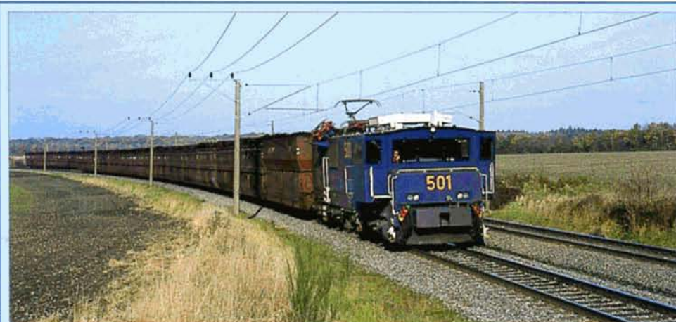
La 501, première locomotive de la nouvelle génération, en tête d'un train de lignite à destination de la cokerie de Frechen. Habbelrath, 12 novembre 1999. On remarquera son gabarit généreux (largeur 4,500 m) et, sur le bord de la toiture, le petit pantographe oblique utilisé lorsque la caténaire est excentrée pour permettre le chargement des wagons sous les trémies. Comme la densité du lignite est plus faible, les wagons destinés aux transports du lignite ne possèdent que deux bogies à deux essieux. Leur masse à vide varie de 29 à 35t, et en charge jusqu'à 125t. Christian VANHECK.
