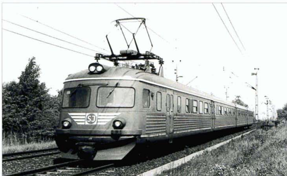
PHOTO 42-43 NB L'automotrice X9 133 photographiée dans la banlieue de Malmö, en mai 1980. Vu la faible hauteur de la caisse (+/- 3,500 m), le pantographe a dû être surélevé au-dessus de la toiture à l'aide de rehausseurs. Pierre HERBIET.
