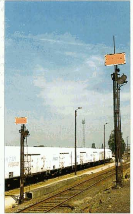
PHOTO 42-56 Les signaux d'arrêts simplifiés surélevés, à l'entrée du faisceau A.
