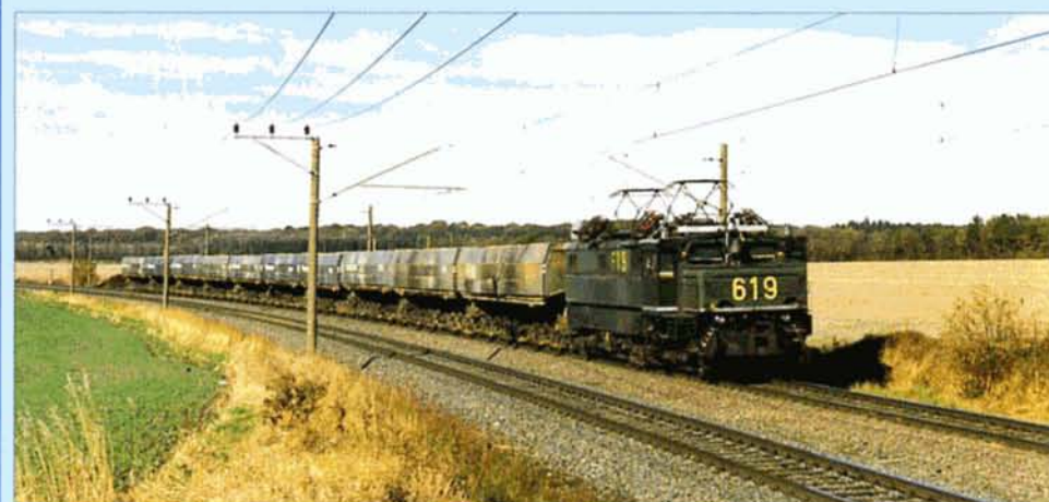
PHOTO 42-42 A Habbelrath, le 21 mars 1997, une machine de la première génération refoule une rame vide vers le site d'extraction Fortuna à Niederaussem. Ces engins, construits de 1954 à 1966 par BBC-AEG-Siemens, ont une puissance de 2640 kW pour une masse totale de 139 t. Le refoulement vers ce site est rendu nécessaire par le fait qu'il n'y a pas de boucle de retournement. C'est pour cette raison que toutes les locomotives possèdent des postes de conduite avec deux pupitres situés en dehors du gabarit de la caisse. Les wagons, destinés au transport de déblais, possèdent quatre bogies à deux essieux. Ils peuvent transporter une charge utile de 180 t, ce qui leur donne une masse totale de 240 t! Pascal DUBOIS.
