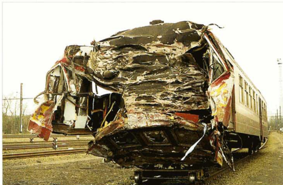
PHOTO 42-60 La voiture-pilote M2 après la collision frontale d'Herentals du 28 janvier. Les dégâts sont considérables comparés à ceux de l'automotrice 647. Eric PAULUS.
