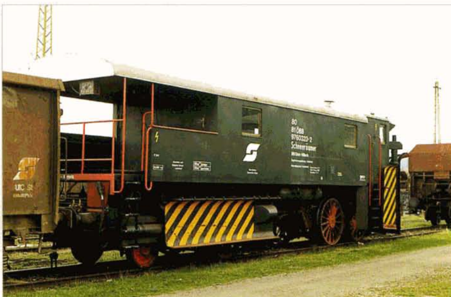
PHOTO 42-81 Le chasse-neige du dépôt de Knittelfeld. On distingue bien le bissel et les trois ex. essieux moteurs subsistants. Jean-Luc VANDERHAEGEN.
