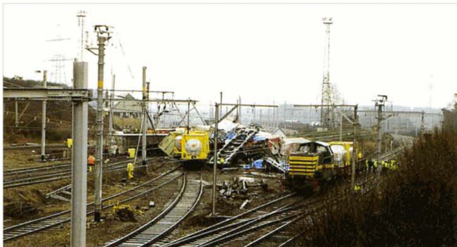
PHOTO 42-58 L'enchevêtrement des wagons de l'accident de Stockem. L'aiguillage, pris à 116 km/h au lieu de 40, est situé en bas de l'image à gauche. Marc GRIETEN, 22-01-2000.
