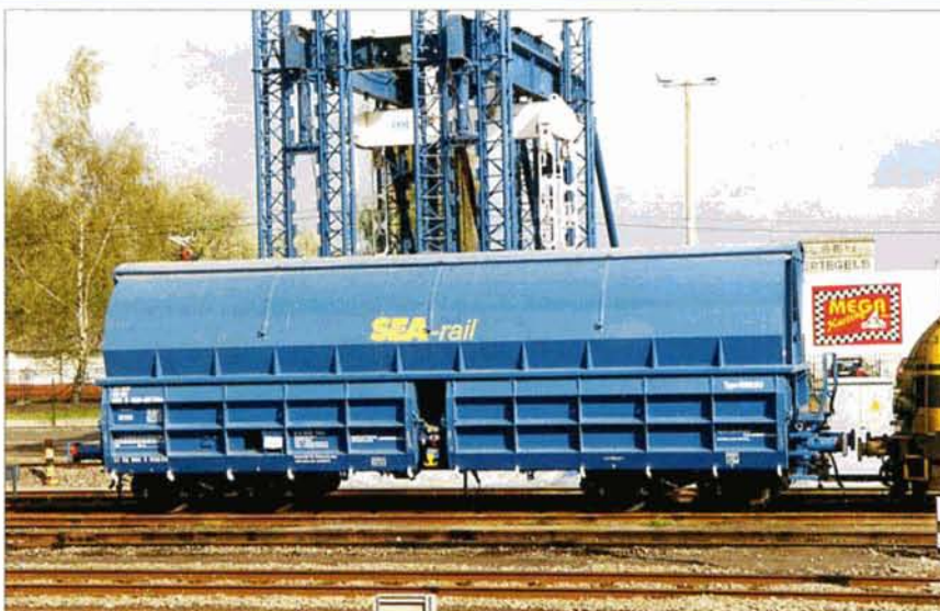
PHOTO 42-73 Le nouveau wagon Talns pour le transport de concentré de zinc (n° UIC 33 88 0665 008-5). Le déchargement du minerai du bateau, son stockage, le transbordement dans les wagons et l'acheminement vers Budel, sont gérés par ABT (Antwerp Bulk Terminal - Groupe Sea-Invest). Neerpelt, 21 avril 2000. Kristof AVONDS.
