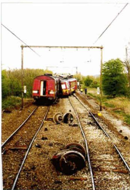
PHOTO 43-58 Après le choc entre les deux automotrices, la 819 poussa la 716 une centaine de mètres. A l'avant plan, l'essieu moteur et l'essieu porteur du premier bogie de la 716. A. DEFECHEREUX.
