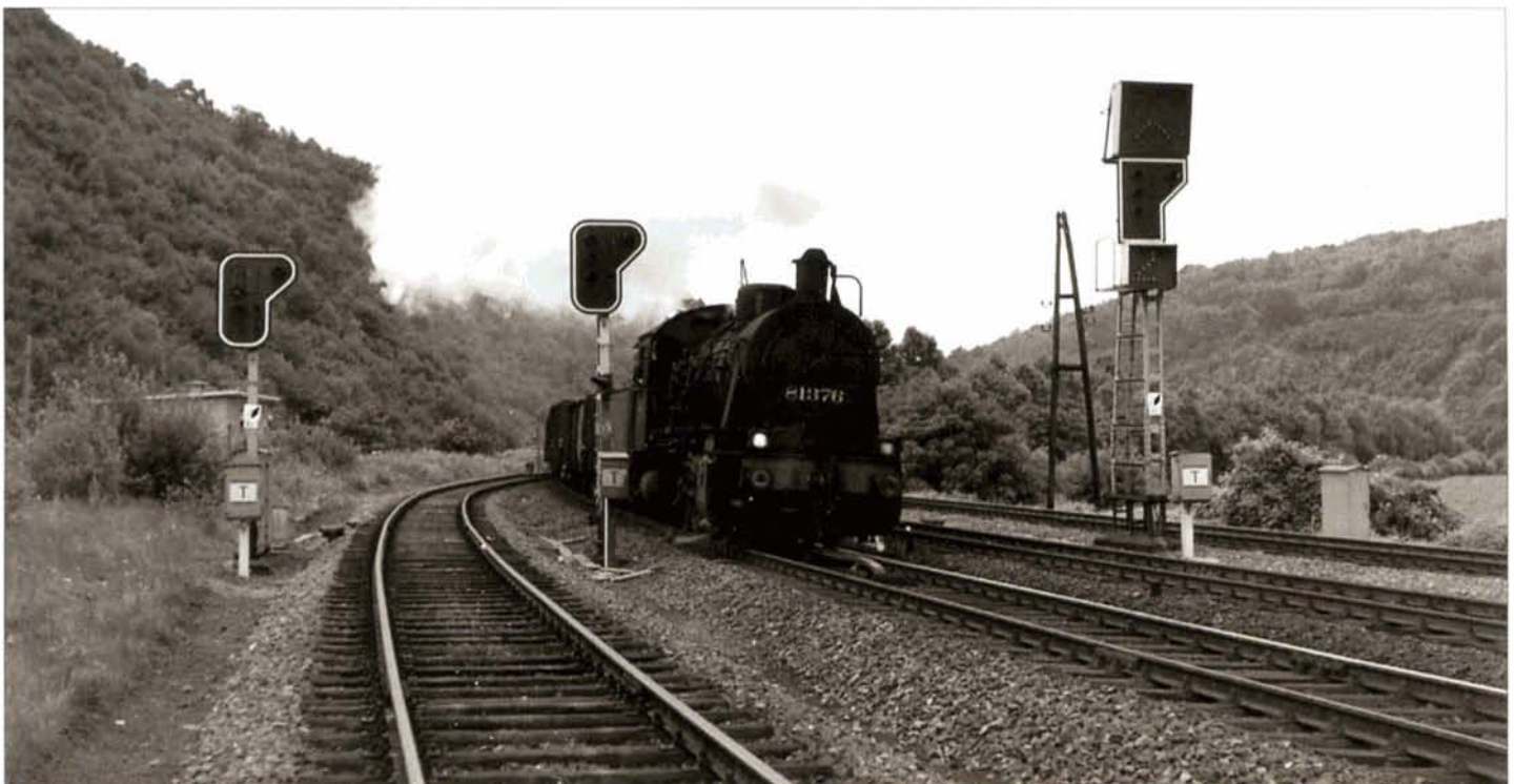
PHOTO BD-105 Vers 12.35, le train de marchandises 44355 Angleur 11.45 - Verviers-Est 12.49, passe à Olne, à contre-voie, en direction de Verviers. La 81.378, construite par Humboldt en 1916 (n° 1216), fut mise en service aux Chemins de fer prussiens avec le numéro Cöln 5170. La SNCB lui attribua d'abord le numéro 8476 puis, à partir du 01-01-1946, 81.376. Cette G8.1 sera radiée en août 1964 à Kinkempois. A Verviers-Est, après avoir manoeuvré, son service se poursuivra avec la desserte de la gare de Dolhain et retour vers Bressoux en s'arrêtant une fois de plus à Verviers-Est. Elle rejoindra ensuite Kinkempois à vide.
