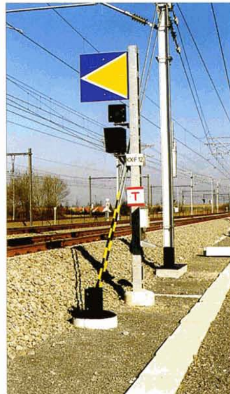
PHOTOS 43-08 - 43-09 - 43-10 Trois modèles de «grands repères» (tous trois sont des repères de contre-voie, puisqu'ils sont placés à droite de la voie parcourue): les deux premiers sont permissifs permanents ; celui de droite, muni d'un oeillette de franchissement, du panneau à deux bandes rouges et T rouge, ainsi que du boîtier pouvant présenter les feux blanc et rouge, est permissif par intermittent et transforme un grand mouvement en petit mouvement lorsque ces feux sont allumés. Philippe SCHOLL.
