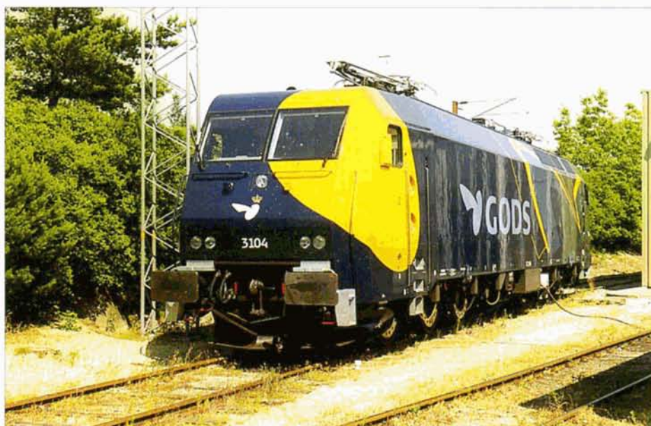
PHOTO 43-33 La EG 3104 des DSB, version lourde à 6 essieux de l'EuroSprinter, à l'atelier de Kobenhavn le 20 juin 2000. Philippe DE GIETER.
