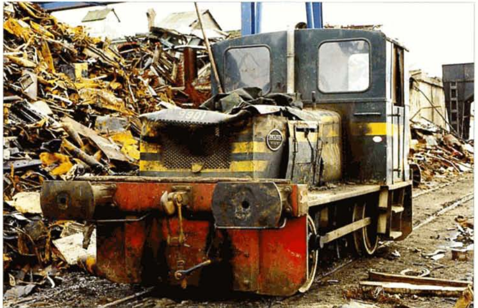
PHOTO 43-16 La 9901 vue côté capot moteur. On remarquera les plateaux élargis des buttoirs qui furent installés par la SNCB pour éviter les mariages de buttoirs lors de manoeuvres dans les courbes serrées. Ferrailleur A. Stevens, Quai des Armateurs, Bruxelles, 6 juin 1981. Jean-Luc VANDERHAEGEN.
