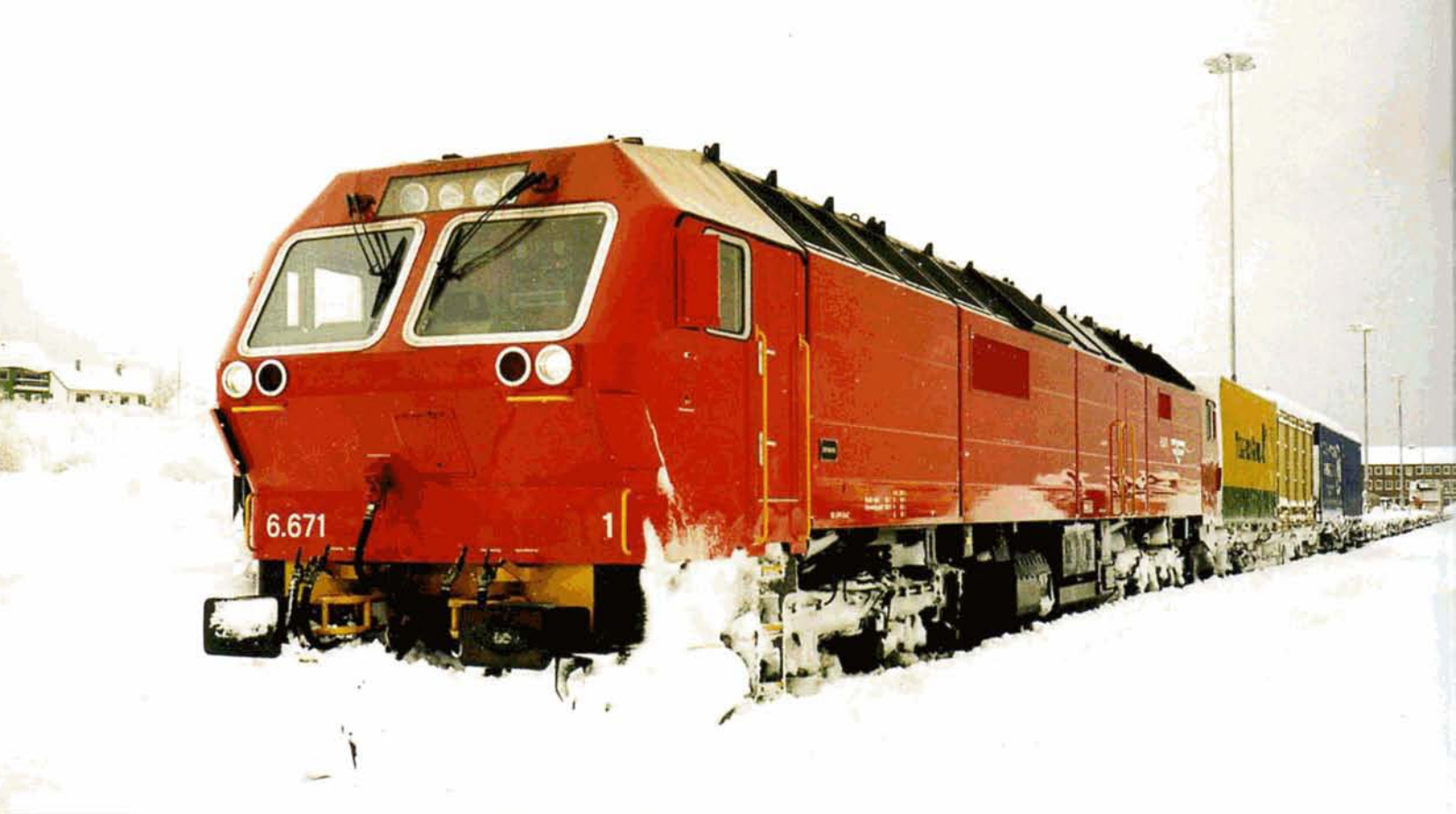
La Di6.671 des Chemins de fer norvégiens, photographiée en gare de Bodo en octobre 1997. Parmi les modifications extérieures, on remarquera le déplacement des phares de l'arête centrale du nez vers le bas (cette position élevée des phares en Norvège est dictée par la couche de neige dépassant parfois le mètre), la suppression d'un des quatre phares au-dessus des pare-brise, des rétroviseurs et de l'éperon chasse-neige, et bien sûr, la décoration. Terje OLSEN.
