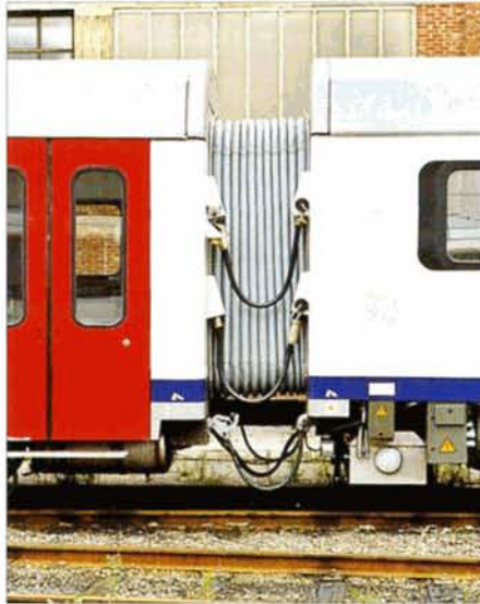
PHOTO 44-64 Gros plan sur la liaison entre les deux voitures de l'autorail. On voit les raccordements électriques et pneumatiques, l'attelage "buff and draw", et l'intercirculation, composée extérieurement d'une enveloppe en accordéon. On remarquera, sous la caisse de la voiture de droite, le réservoir de rétention du WC.
