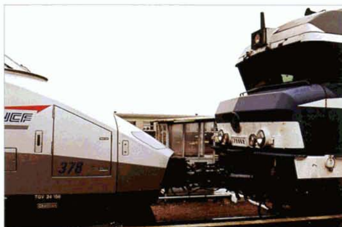
PHOTO 44-22 Gros plan sur l'accouplement entre la CC 72.062 et la rame TGV Atlantique 378. Les Sables d'Olonne, 4 juillet 2000. Marc GRIETEN.
