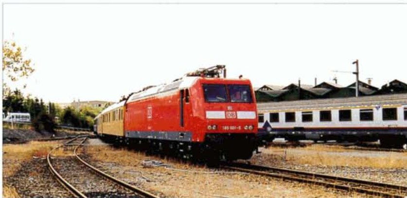
PHOTO 44-20 Du 14 au 27 août, la 185.001 fut testée sous 25 kV 50 Hz sur le réseau CFL. Elle est vue ici au dépôt de Luxembourg, le 18 août 2000. D'une puissance de 4200 kW et d'une masse de 84 t, les 185 peuvent circuler à une vitesse maximale de 140 km/h. Alain DEFECHEREUX.
