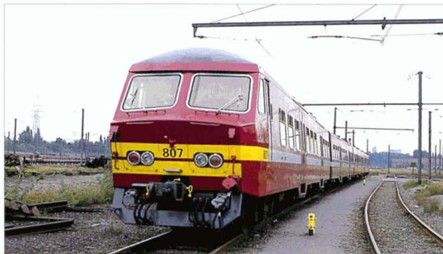
La voiture Bx de l'automotrice 807 a subi des modifications aux niveaux de ses phares. Auparavant encastrés dans le nez derrière une vitre, ceux-ci ont été déplacés vers l'extérieur. Atelier de Schaerbeek, 7 septembre 2000. Christian VANHECK.
