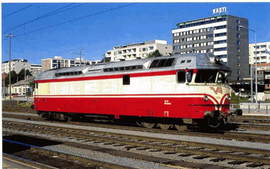
La Dr 13 2324 en gare de Tampere, le 17 août 1997. On remarquera les curieux bogies équipant ces machines, typiquement français. Le bogie arrière est vu du côté du carter de la transmission. Le bogie avant est vu du côté opposé; les roues sont entièrement dépouillées de tout élément. Christian VANHECK.
