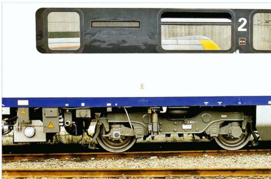
PHOTO 44-63 Le bogie moteur. La suspension primaire est réalisée par des ressorts hélicoïdaux, placés entre les boîtes d'essieu et le châssis du bogie, ainsi que par des amortisseurs hydrauliques disposés à côté des boîtes d'essieu. La suspension secondaire, située entre le châssis du bogie et la caisse, se compose d'un coussin d'air et d'un amortisseur hydraulique secondaire. On remarquera, sous la caisse, le réservoir de sable (à gauche du bogie) et les tuyaux devant les essieux. Entre les deux fenêtres de gauche, on voit un indicateur électronique de destination.
