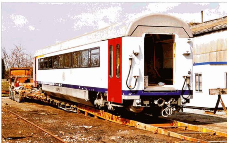
PHOTO 44-61 Déchargement de la remorque routière de la voiture ABx du 4101. On remarquera l'attelage "buff and draw" reliant les deux voitures de l'autorail, ici la partie femelle. Hasselt, 14 avril 2000. Frederik DE CLERCK.
