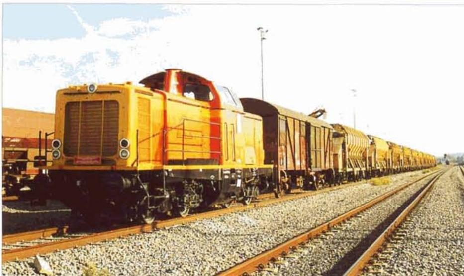
La société française SECO-DG est également présente sur le site. Deux locomotives Diesel ex. 211 de la DB l'ont accompagné : les AT3 ATA 0087 et 0007, ici visibles encadrant une rame de wagons autodéchargeurs Vads utilisés pour la mise en place de la sous-couche de ballast. Base de Voroux, 10 novembre 2000. Roger CRIKELAIRE.
