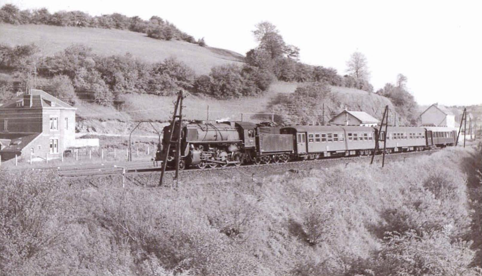
**PHOTO BD-121** Le jeudi 7 juin 1962, l'omnibus 4172 Verviers-Central 17.08 - Herbesthal 17.28, quitte la gare de Dolhain-Vicinal. La rame, composée de deux voitures du type K3 et d'une voiture BD du type K1, est remorquée par une type 29 du dépôt d'Herbesthal.
