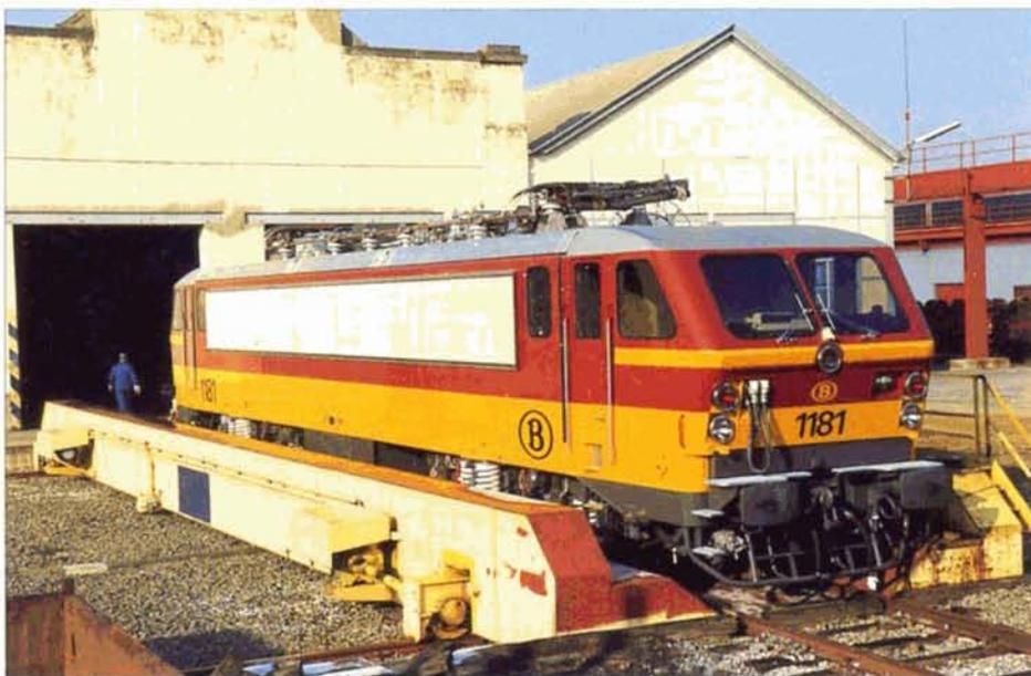
PHOTO 45-46 L'Atelier Central de Luttre disposait d'un pont à peser. A ce titre, il a procédé à de nombreux pesages d'engins, notamment ceux sortant de construction, comme ici la 1181, photographiée le 18 novembre 1985, sur un transbordeur de l'atelier. J-L VDH.
