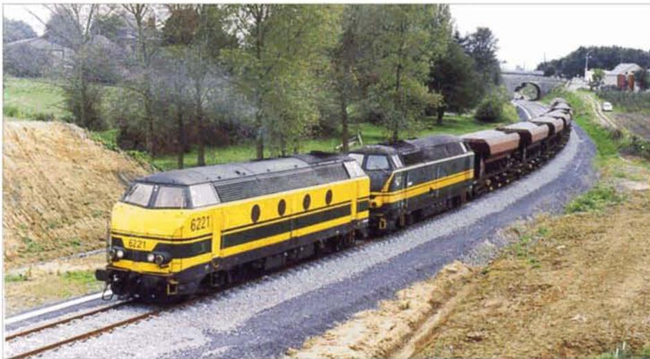
Les travaux de reconstruction de la ligne 147 se poursuivent. Durant l'automne 2000, les voies ont été ballastées, opération suivie, durant l'hiver, par l'électrification de la ligne. Ci-dessus : le 20 septembre 2000, les 6221 + 6273 remorquent une rame de ballast dans les environs de Fleurus. Ci-dessous PHOTO 45-43 ↓ Le 10 janvier 2001, la 8465 en tête d'un train d'électrification. Cédric SOLTYS et Pierre HERBIET.
