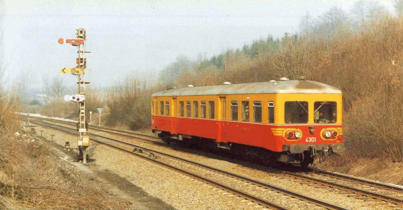
**PHOTO-THEME 38** ↑ Le 3 mars 1983, le 4301 quitte Florenville en direction de Virton. A gauche, le signal d'entrée de la gare. Il s'agissait du dernier signal mécanique encore pourvu de trois palettes : une palette d'arrêt rouge, une palette avertisseur jaune et une palette de manœuvre violette. Pierre HERBIET.
