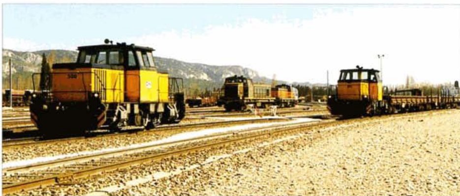
PHOTO 46-25 Les deux locotracteurs Cockerill Mechanical Industries 506 et 510 (pour rappel, construits originellement pour les Chemins de fer danois) ont été loués pour assurer les manoeuvres à la base travaux de Cheval-Blanc, près de Cavaillon. Ces engins, construits sur base de normes très strictes en matière de nuisances sonores et d'émissions des gaz d'échappement, y furent très appréciés. Le 9 mars 2000, les deux engins manoeuvraient simultanément. Philippe DE GIETER.
