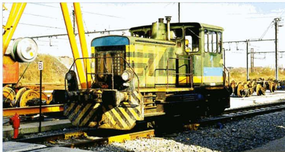
← PHOTO 46-40 La 9149 est utilisée par l'atelier de Charleroi-Sud pour manoeuvrer les automotrices. Elle a curieusement, mais non officiellement, été rebaptisée avec un numéro 1. Charleroi-Sud, 6 mars 2001. Prochainement, des chariotrac devraient reprendre les tâches des 91. J-L VANDERHAEGEN.
