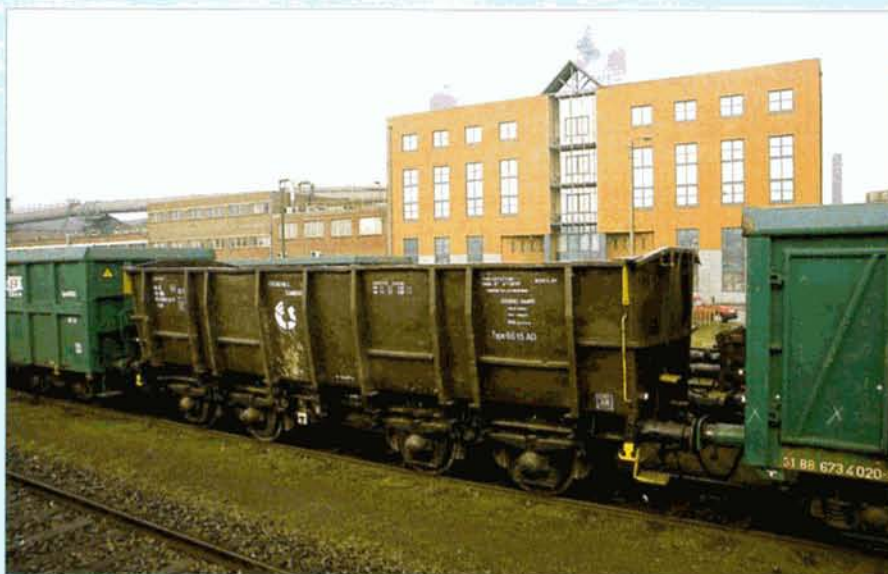
DIA 46-63 Une vue d'un autre Fall, portant le numéro 44 88 6711103-2 P, encadré par des wagons du type Fas de la SNCB. Ces magnifiques véhicules ont une capacité de 42 m 3 . D'une masse à vide de 16,5 tonnes, ils peuvent transporter une charge de 63,5 t. Marcinelle, 24 février 2001. Christian DOSOGNE.
