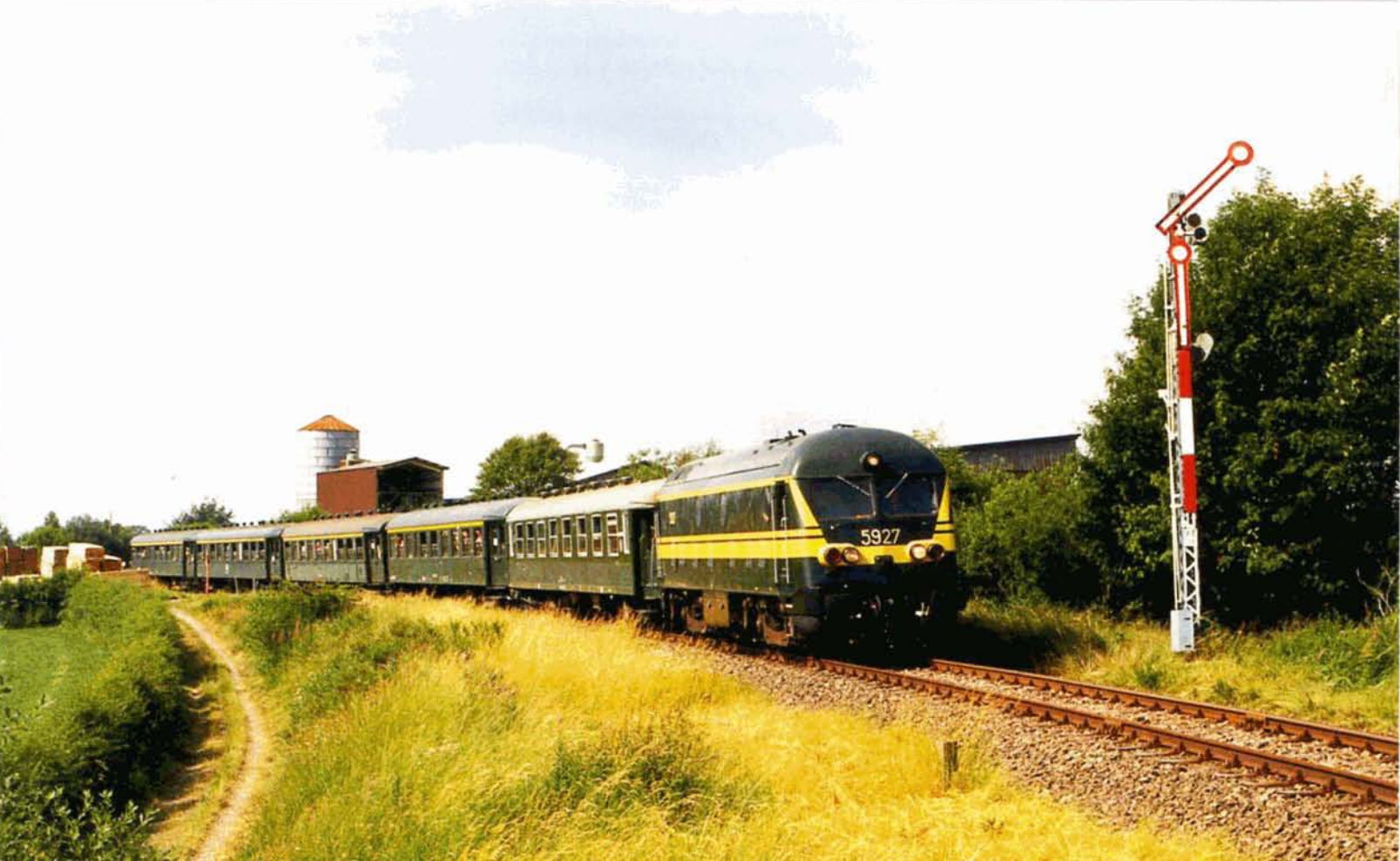
PHOTO 46-98 Le 9 juillet 1994, la 5927 du PFT quitte Sourbrodt et passe à hauteur du signal d'entrée F II de la gare, situé côté Weywertz. La palette supérieure est anormalement levée à 45°, alors qu'elle devrait être en position horizontale. Alain DEFECHEREUX.
