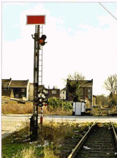
PHOTO 46-90 Toujours à Châtelet-Ville, le signal F P.N. 2 autorise le départ du raccordement. Après le PN, on voit le petit poste de commande.
