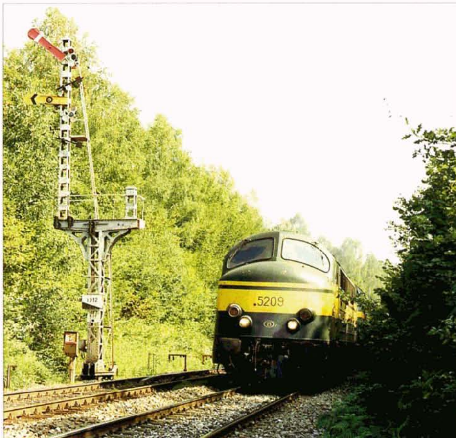
Le signal d'arrêt C37 situé à l'entrée de la gare de Saint-Vincent-Bellefontaine, côté Bertrix. Cet ancien chandelier a été amputé de son mâtereau de droite. La palette d'arrêt levée à 45° autorise le passage. La palette avertisseur jaune en position horizontale indique que le prochain signal impose l'arrêt.
