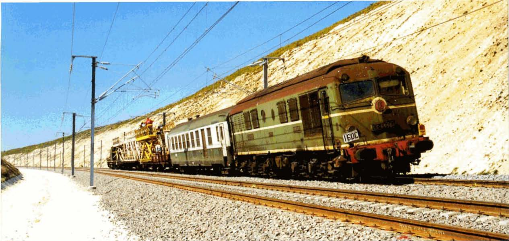
PHOTO 46-19 Le 10 mars 2000, un train de réglage des caténaires opère dans les environs d'Eguilles, non loin d'Aix-en-Provence. La rame est encadrée, en tête par la CC 65.508 et, en queue, par une BB 63.500. Grâce au TGV Méditerranée, les vénérables CC 65.500 auront bénéficié d'un ultime et dernier sursis. Pierre HERBIET.
