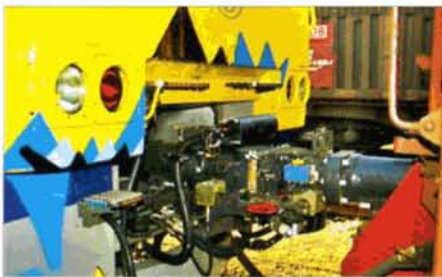
Gros plan sur le raccord spécial utilisé entre deux wagons, pour transférer entre la France et la Belgique les autorails de la série 41, dont le 4107, qui a déjà subi la visite des tagueurs... Alain JANMART.
