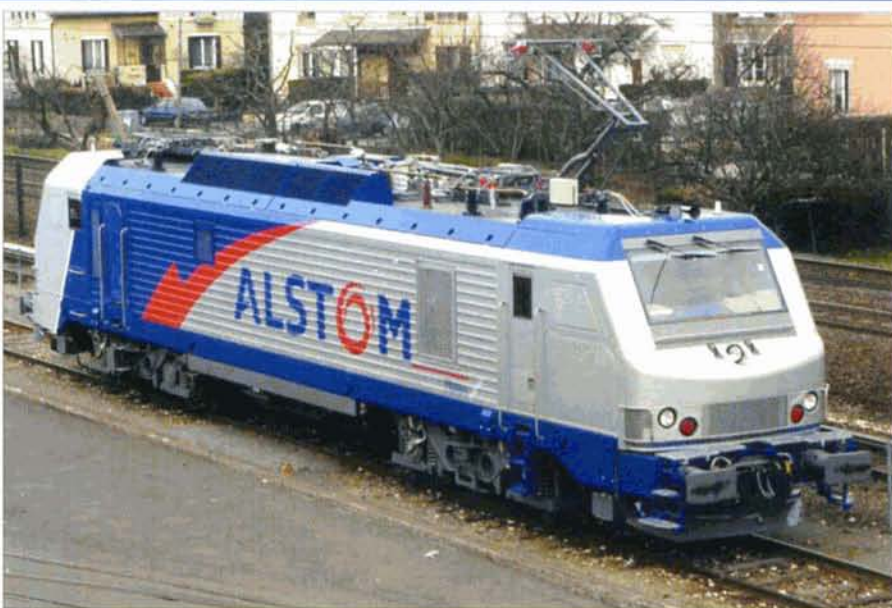
La nouvelle PRIMA d'Alstom. D'une masse totale de 90 t et d'une puissance de 4200 kW, elle sera capable de remorquer des trains de 1600 t en rampe de 10‰ à 70 km/h, et en rampe de 2‰ à 125 km/h. Elle est équipée de 4 moteurs asynchrones. Document aimablement mis à notre disposition par ACEC (ALSTOM).
