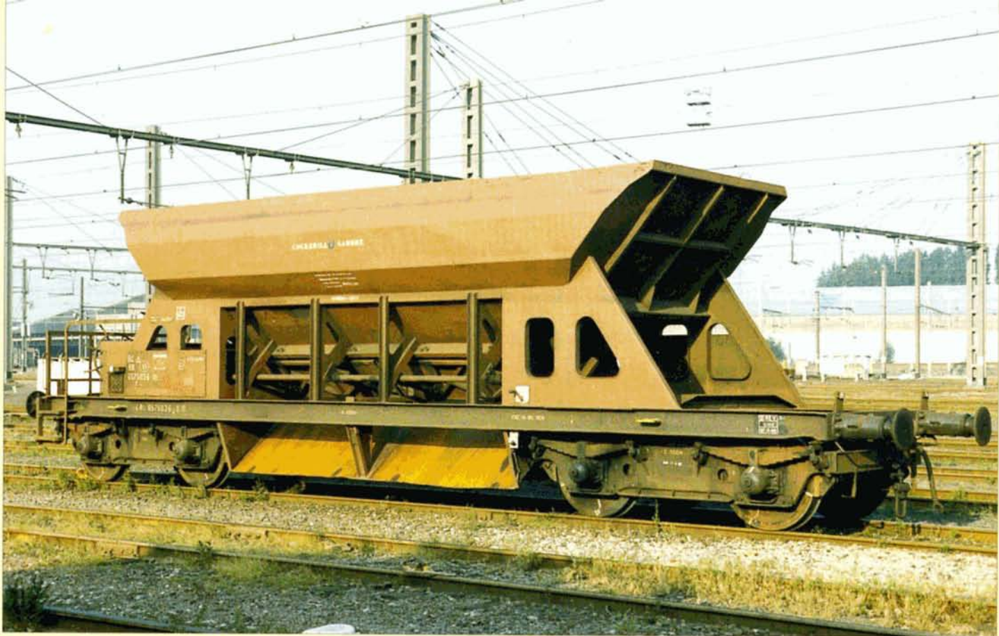
PHOTO-THEME 39 Les wagons "Hainaut - Sambre", communément appelés les "Enghien", furent construits à 93 exemplaires en 1958 par les ateliers Saint-Eloi à Enghien. Gros plan sur le F 84 88 6575036-0 P. Monceau, 8 juin 1988. Jean-Luc VANDERHAEGEN.
