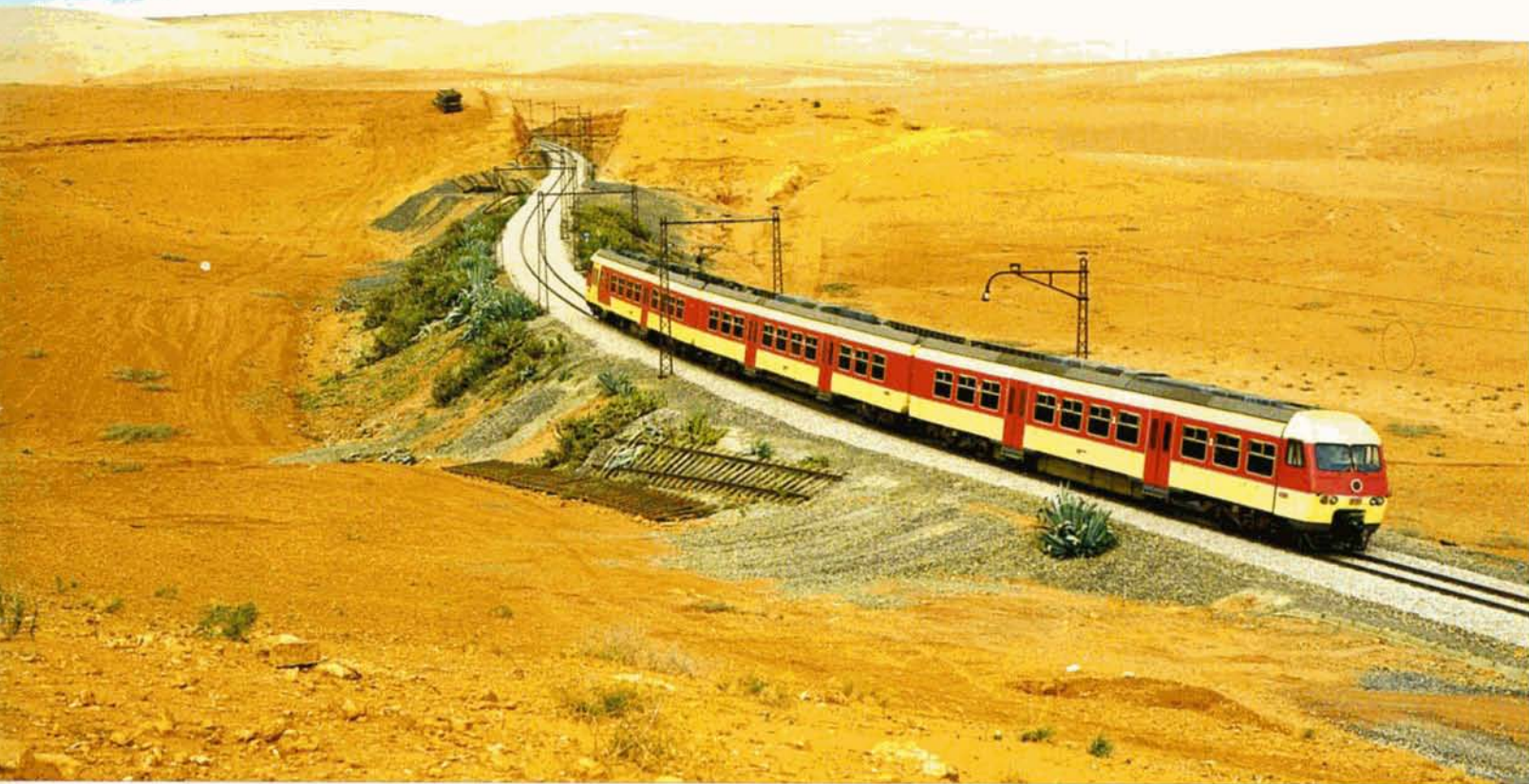
PHOTO 46-111 La ZMC-4 dans un paysage "martien", à Mechra Benabbou. On remarquera les anciennes portions de voies, posées sur le côté de la ligne, pourvues de traverses métalliques dont certaines ont été fournies par Cockerill en 1933. Jean-François HUART.
