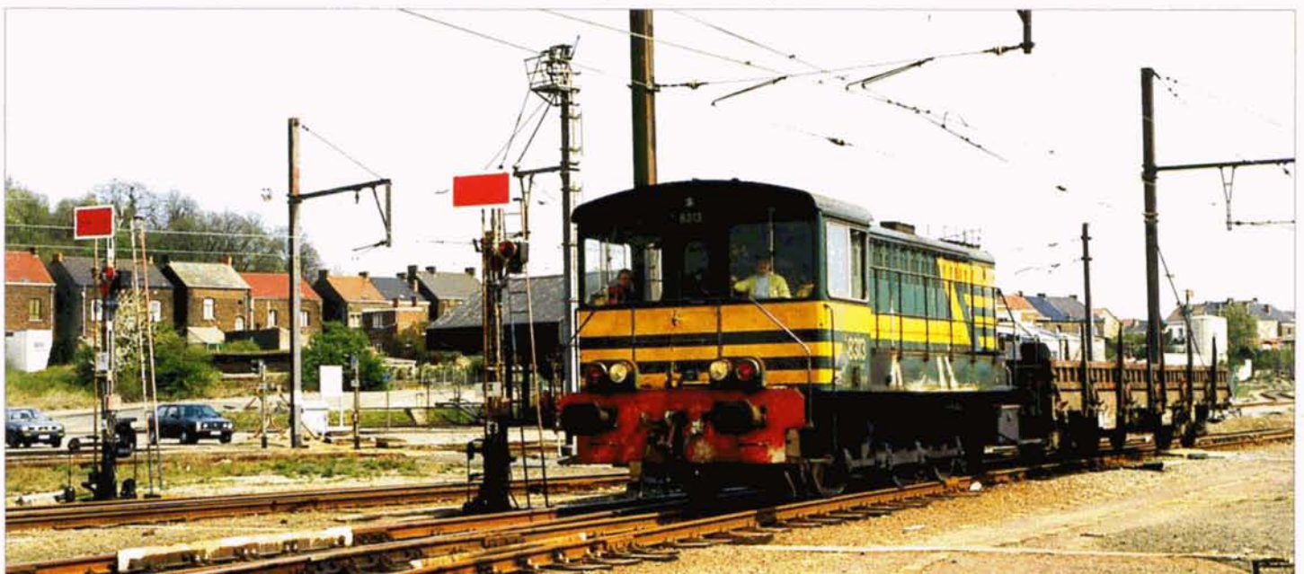
PHOTO 46-84 La gare de triage de Châtelet possède encore neuf signaux mécaniques, constituant ainsi la plus grande panoplie du réseau. Le 22 avril 1994, la 8313 manoeuvrait à proximité des signaux d'arrêt simplifiés surélevés K IV et C IV. J-L VANDERHAEGEN.
