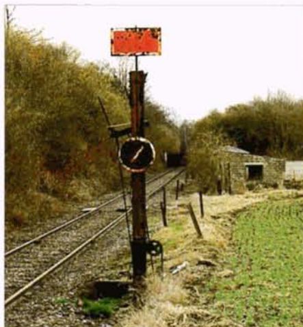
PHOTO 46-96 Le signal d'arrêt simplifié surélevé donnant accès à la cokerie d'Anderlues. Jean-Luc VANDERHAEGEN.
