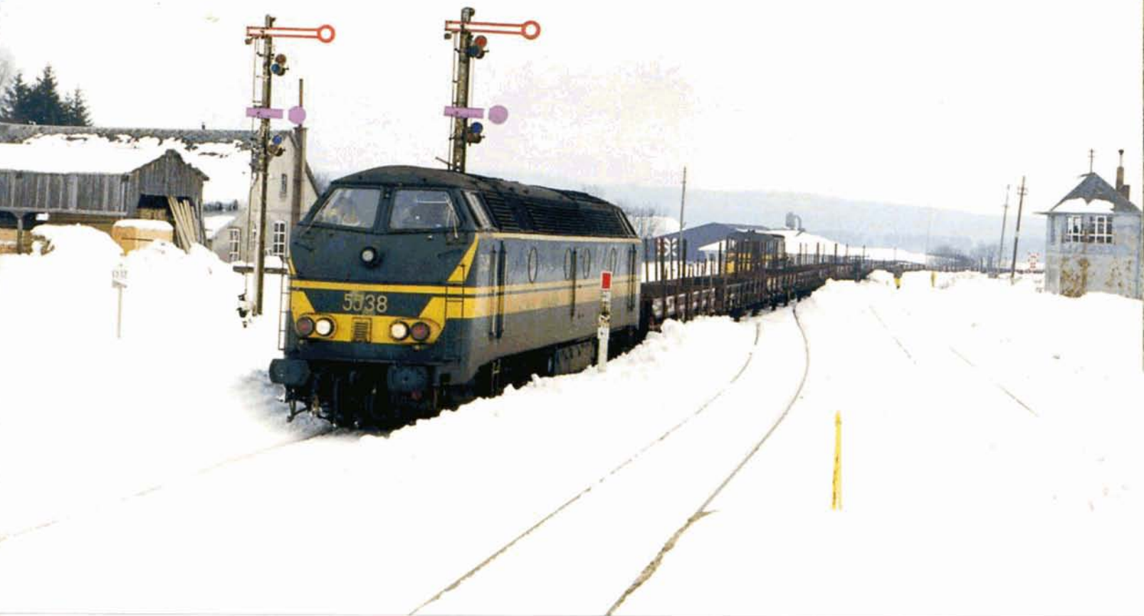
PHOTO 46-97 La gare de Sourbrodt est toujours équipée d'une signalisation mécanique. Ici, on voit deux des trois signaux implantés du côté nord de la gare (vers Raeren) et portant le littéra C I et G I. La palette de manoeuvre violette n'est pas d'origine allemande. Le 9 mars 1988, un train militaire en provenance de Raeren entre en gare, laquelle est recouverte d'une épaisse couche de neige. Jean-Luc VANDERHAEGEN.
