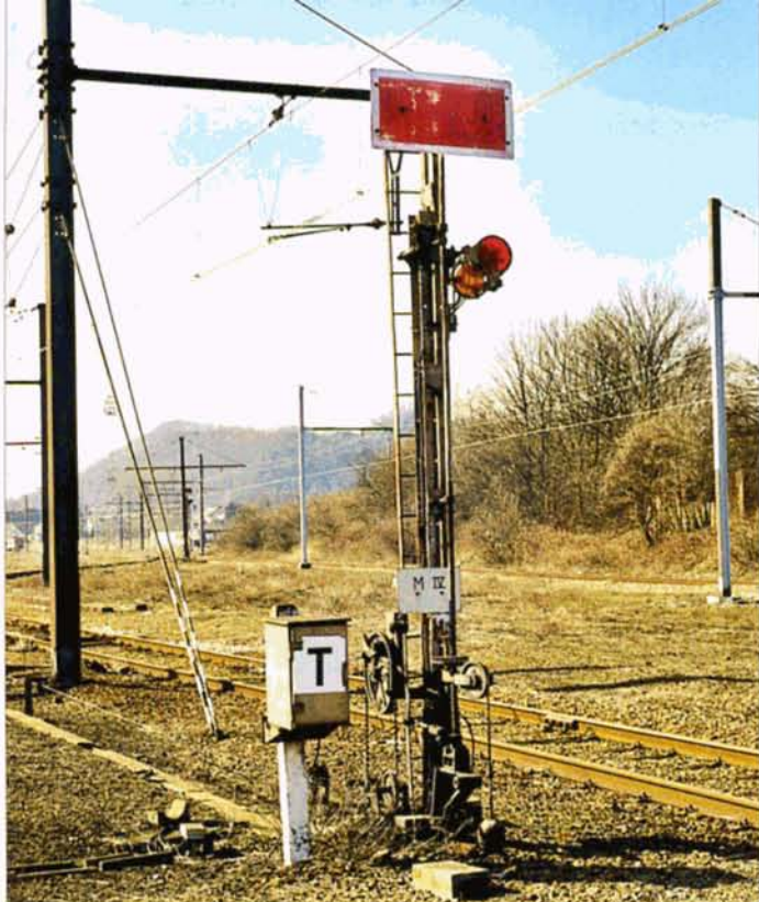
PHOTO 46-85 Le signal d'arrêt simplifié surélevé M IV de Châtelet. Lorsque le signal autorise le passage, la plaque rouge pivote de 90°, le feu rouge est alors remplacé par un feu jaune. Jean-Luc VANDERHAEGEN, 3 mars 2001.
