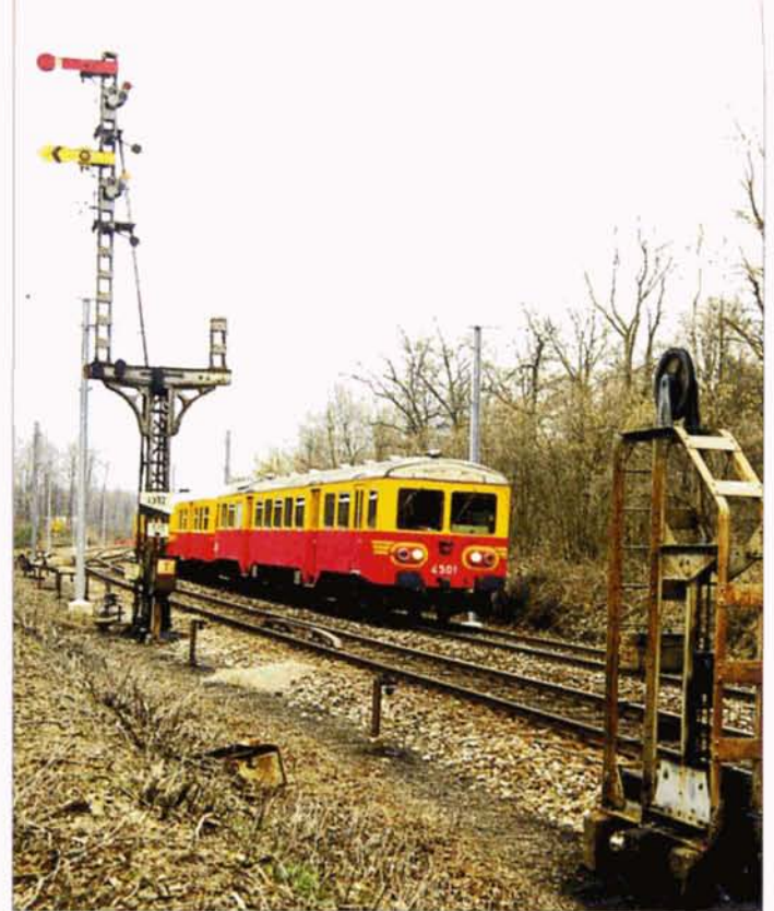
PHOTO 46-83 Une autre vue du signal C37, prise lors d'un voyage PFT, le 20 mars 1999. En signalisation mécanique à deux positions, la palette rouge porte à son extrémité un disque, tandis que la palette jaune est en forme de flèche et est arrondie en son milieu. Chaque palette ne peut occuper que deux positions : horizontale ou levée à 45°. Alain DEFECHEREUX.
