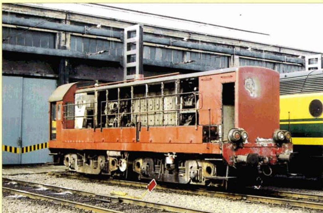
PHOTO 48-09 Depuis le mois de septembre, l'essentiel de nos efforts sont concentrés sur la restauration de la 7005. On la voit ici partiellement peinte en anti-rouille, dépourvue des portes du capot moteur. Dans quel version réapparaîtra t-elle ? Surprise ... Alain DEFECHEREUX.
