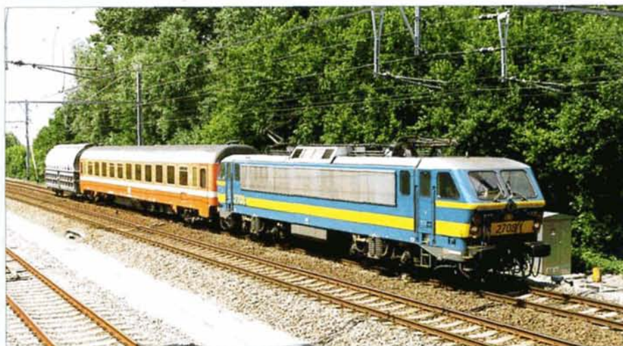
PHOTO 48-40 ↑ PHOTO 48-41 ↓ Le 22 juin, la SNCB a procédé entre Ath et Silly à des essais de freins avec un wagon du type Talns pour le transport de zinc (voir EL 42 p. 39). Nos deux documents montrent le passage de la rame juste au moment du décrochage du wagon. La distance de freinage du wagon sera ensuite mesurée. Ph. SCHOLL.
