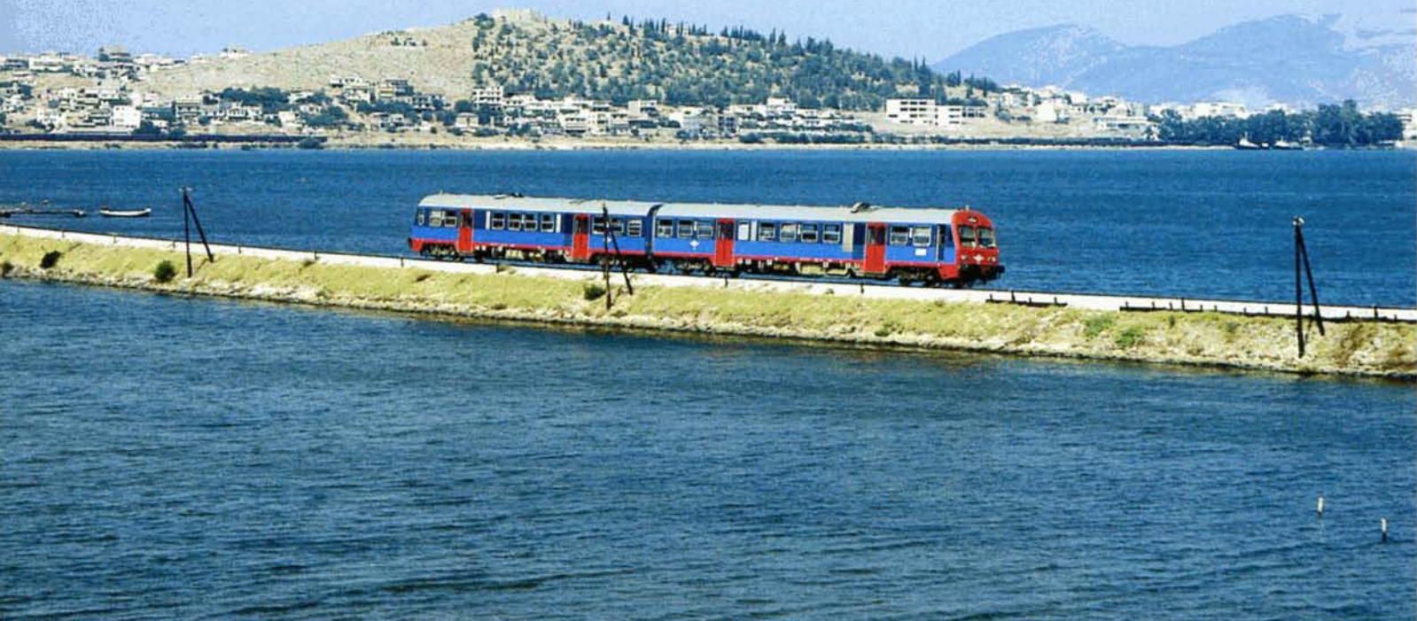
L'autorail 715/716 photographié sur la ligne Chalkis - Inoi, le 14 août 1991. Ces autorails doubles construits sous licence en Grèce de 1990 à 1991, sont équipés de deux moteurs Diesel MAN de 305 kW, un par voiture. La transmission hydraulique entraîne tous les essieux de la rame. Ils peuvent transporter 144 voyageurs assis, à 120 km/h. Tomas MEYER-EPPLER.
