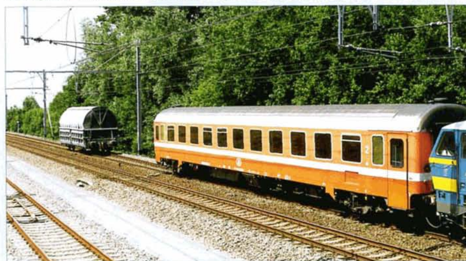
PHOTO 48-40 ↑ PHOTO 48-41 ↓ Le 22 juin, la SNCB a procédé entre Ath et Silly à des essais de freins avec un wagon du type Talns pour le transport de zinc (voir EL 42 p. 39). Nos deux documents montrent le passage de la rame juste au moment du décrochage du wagon. La distance de freinage du wagon sera ensuite mesurée. Ph. SCHOLL.
