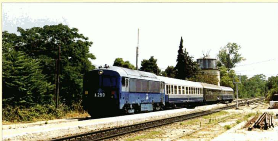
PHOTO 47-25 Le train Pireia - Larissa marque l'arrêt dans la petite gare de Sfendali, le 7 août 1996. En tête, la A-259, une des dix locomotives construites par Ganz-Mavag en 1982, identiques aux M41 hongroises (1325 kW, transmission hydraulique, 66 t, 103 km/h). Ces machines, numérotées A-251 à A-260, sont toutes réformées.
