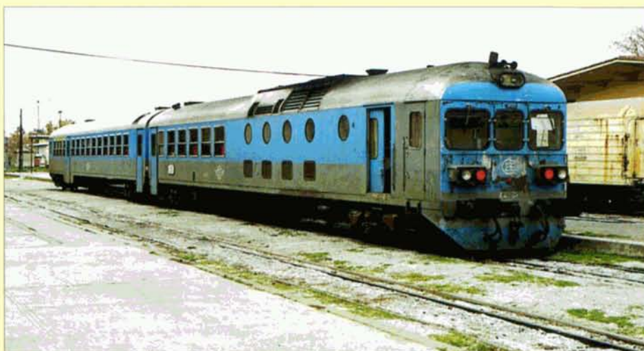
L'autorail 715/716 photographié sur la ligne Chalkis - Inoi, le 14 août 1991. Ces autorails doubles construits sous licence en Grèce de 1990 à 1991, sont équipés de deux moteurs Diesel MAN de 305 kW, un par voiture. La transmission hydraulique entraîne tous les essieux de la rame. Ils peuvent transporter 144 voyageurs assis, à 120 km/h. Tomas MEYER-EPPLER.
