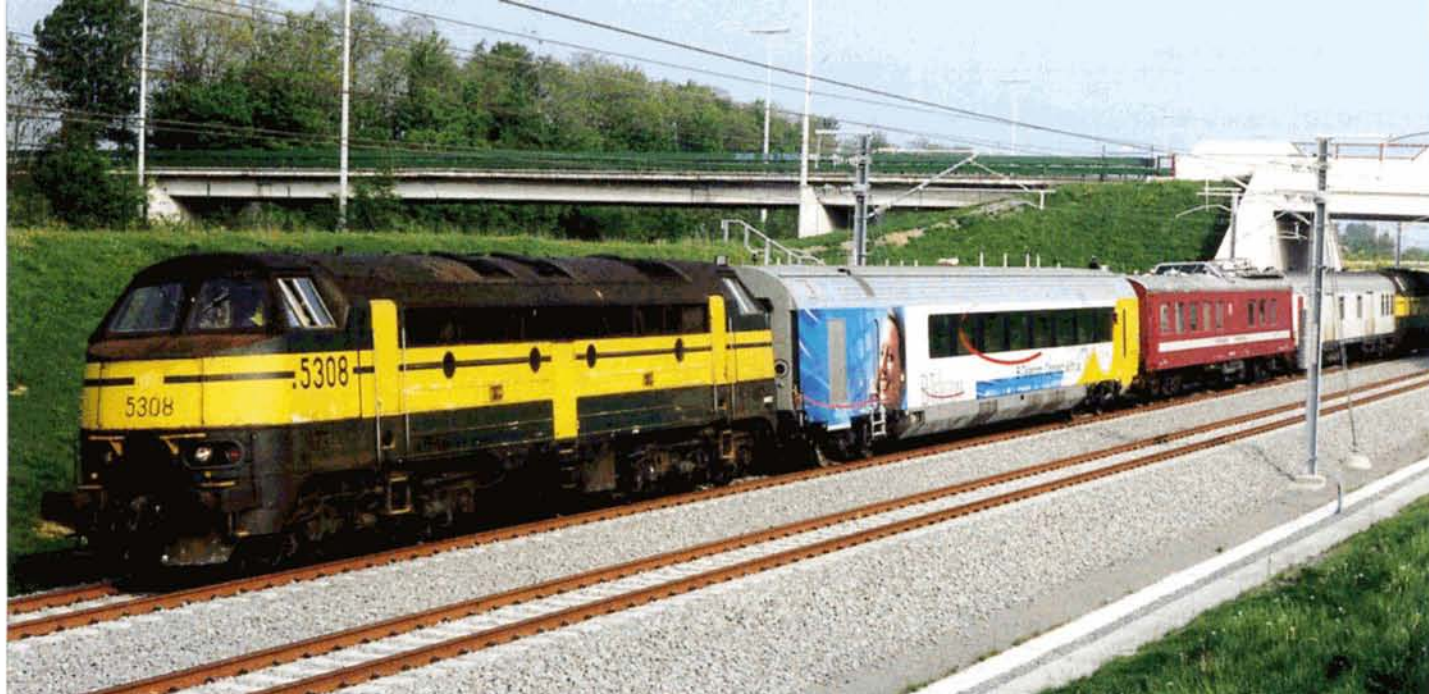
Le 8 mai, un train de mesures a circulé sur la LGV2 avec pour but la vérification de la qualité de la couverture de la liaison sol-train. La rame, composée de la voiture B-Télécom 00800, Ide a voiture ES 601 et d'un fourgon Dms, était encadrée des 5308 et 5307. G BRIDOUX, Hoegaarden.
