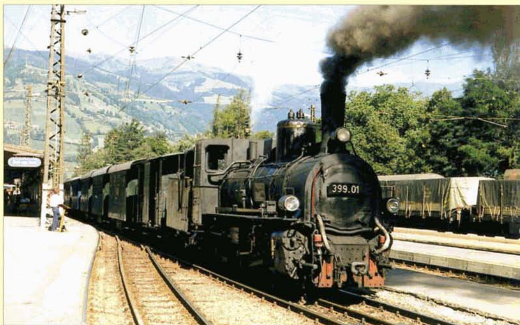
PHOTO 51-18 La 399.01 (Krauss 5431/1906) prête au départ en gare de Zell am Zee, en tête d'un train touristique à destination des chutes de Krimml. On remarquera la voie à deux écartements différents. Jean-Luc VANDERHAEGEN, 28 août 1991.
