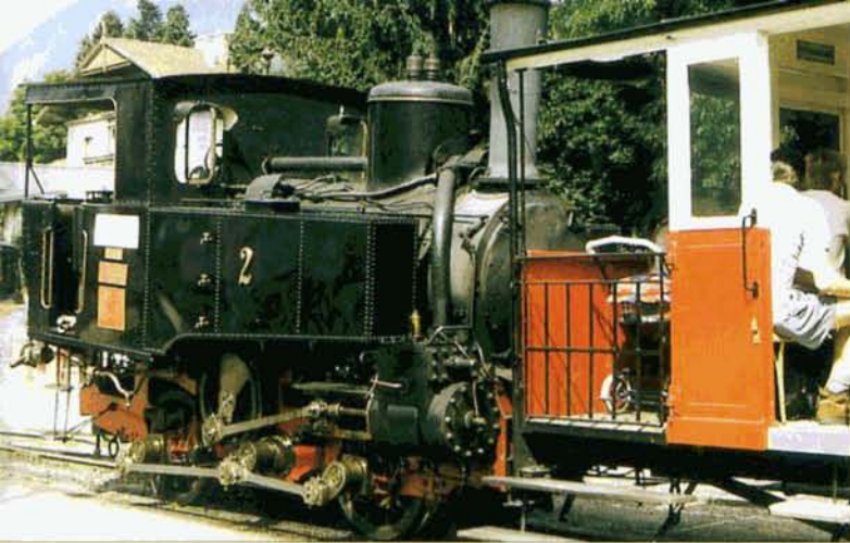
PHOTO 51-24 Le 14 juillet 1997, à Jenbach, la machine n° 2 attend le départ pour une nouvelle ascension de l'Achensee. Les bielles motrices entraînent une roue dentée, qui actionne à son tour, par engrenages, un faux-essieu relié par bielles aux deux essieux moteurs. Walter PINET.
