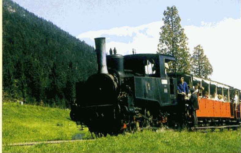
PHOTO 51-25 Le 14 septembre 1984, après avoir effectué un changement de front à Eben, la locomotive n°1 se prépare à parcourir la dernière section de la ligne qui mènera le train au terminus : Achensee-Schiffstation. Vu le profil facile, ce tronçon n'est pas équipé de crémaillère. Walter PINET.
