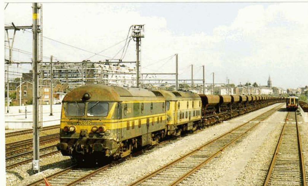
PHOTO 54-37 Le train de cylindrage de la LGV2, en gare de Ans, le 7 août 2002. La rame, composée de 25 wagons totalisant 2000 t, est remorquée par les 5946 et 5916. Serge MARTIN.
