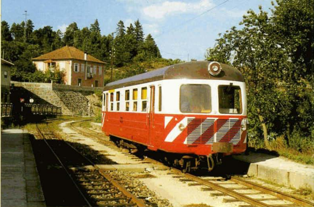
PHOTO 54-18 Encore l'autorail 9103, au point d'arrêt de Vila Caiz, le 10 septembre 1998. Les trois petits autorails de la série 9101 à 9103 furent construits par NoHAB en 1949. Ces engins à bogies, utilisés sur la ligne de Livraçao à Amarante, ont été retirés du service en juillet 2002. Ils étaient pourvus de deux moteurs Diesel Scania de 137 CV et d'une transmission hydraulique. Ils pouvaient circuler à 70 km/h et transporter 36 voyageurs assis, dont 8 en première classe. Philippe DE GIETER.
