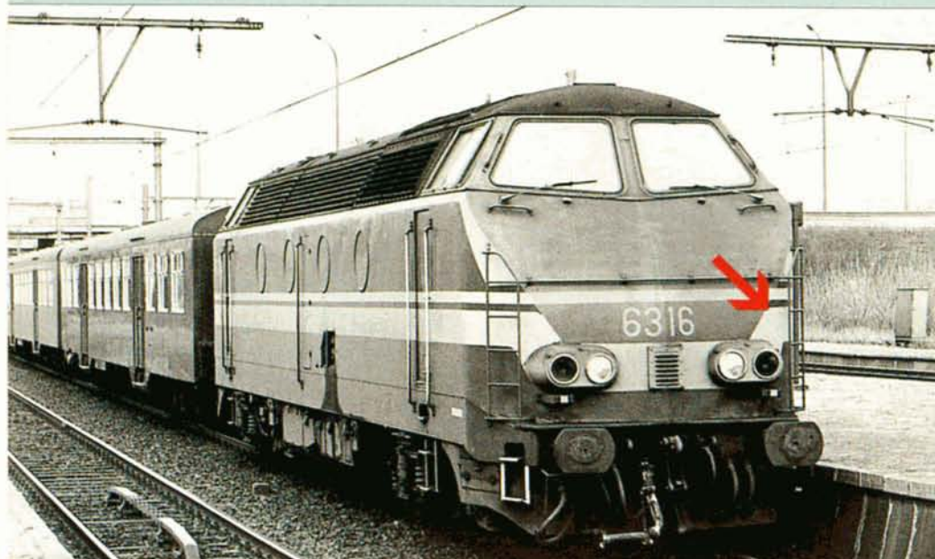
PHOTO 54-12 NB La 6316 fut la première locomotive de sa série à avoir revêtu la livrée "1970". Accidentée le 2 février 1971, elle fut réparée à l'Atelier Central de Salzignes du 4 février au 4 mars 1971. A ce moment, Salzignes appliquait encore des angles arrondis sur le raccord vers les phares (voir flèche sur la photo). Elle fut ainsi la seule 62/63 sortie de Salzignes avec les angles arrondis. En mai 1978, elle fut repeinte à Hasselt, son dépôt titulaire, toujours en vert "1970" mode "Salzignes", mais avec cette fois ses angles droits. Elle conservera cette robe jusqu'en 1986 (repeinte en jaune le 02-05-1986). Antwerpen-Noorderdokken, 31 janvier 1978. Eric VAN HOECK.
