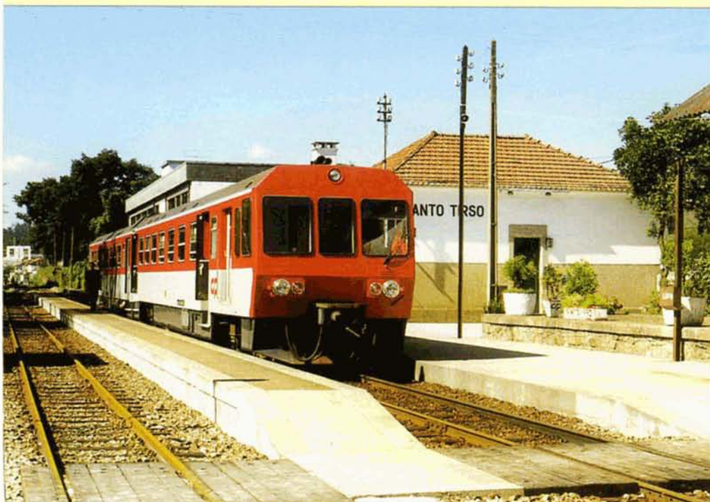
PHOTO 54-14 L'autorail double 9617 construit par Alstom en 1977, à Santo Tirso sur la ligne Porto - Guimaraes. Cette ligne a depuis été mise à voie normale. Philippe DE GIETER, 12 septembre 1998.
