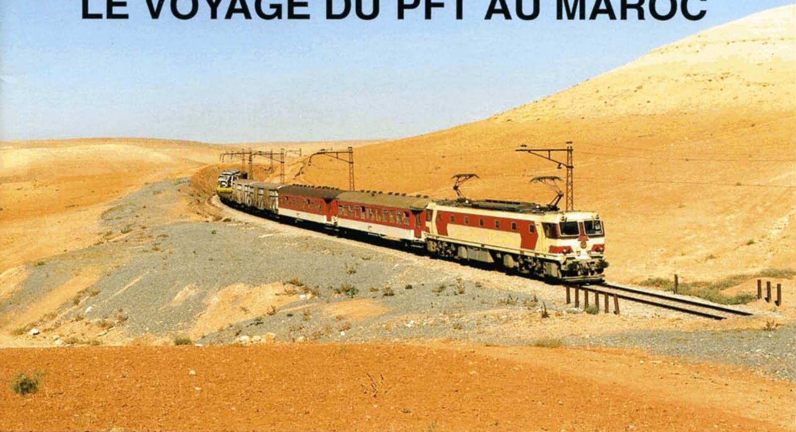
PHOTO 54-06 Notre train spécial en route vers Marrakech, ici lors d'un arrêt-photo dans les environs de Mechraa Ben Abbou. En tête, la locomotive japonaise E-1207 (Hitachi 1982 - 2850 kW - 132 t - effectif : 8 unités). Eric VAN HOECK.
