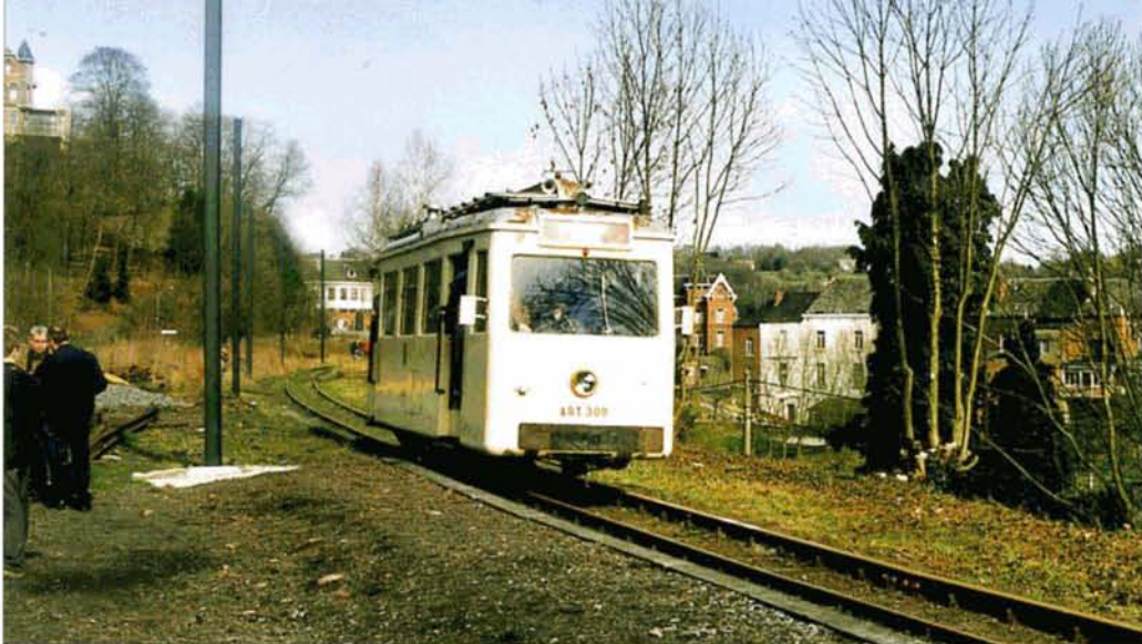
Le 31 mars 2001, l'ART 300 stationne au quai desservant le CDV, qui se trouve à gauche; la voie est celle de l'ancienne ligne SNCB 109, dont l'écartement a été réduit à un mètre. B.D.
