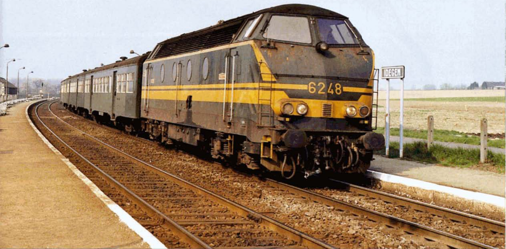
PHOTO-THEME 50 Le 23 avril 1982, la 6248 remorquait l'omnibus 5310 Ath - Denderleeuw, ici à l'arrêt de Idegem. La décoration de la locomotive est conforme au plan du 30 janvier 1970, avec ligne de ceinture interrompue (point 1). On remarquera la présence d'un troisième feu blanc, constitué par un ancien phare de locomotive à vapeur. Jean-Luc VANDERHAEGEN.
