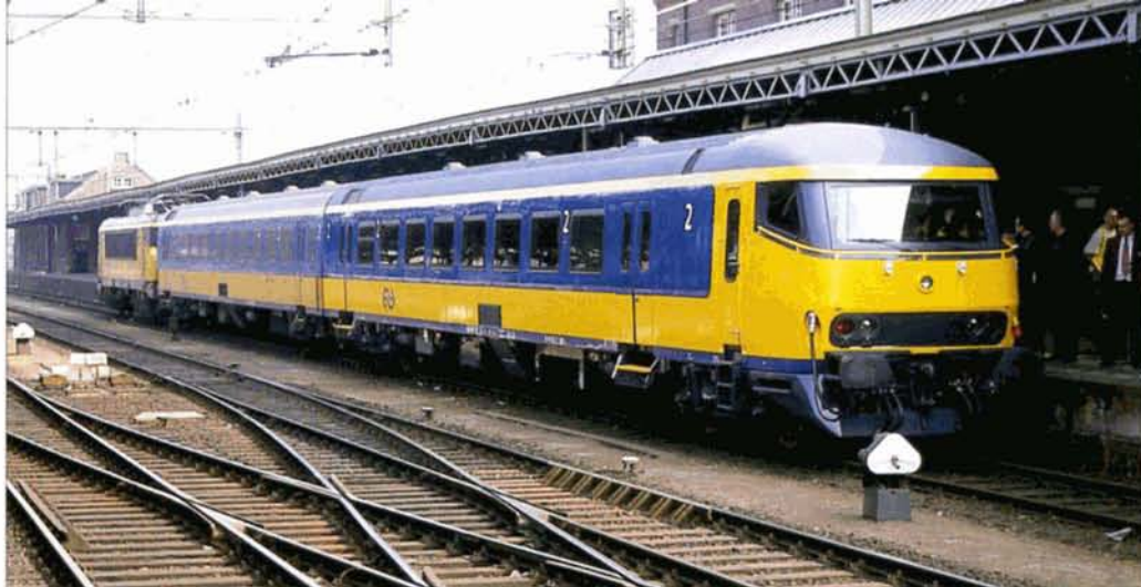
Les NS transforment actuellement plusieurs voitures du type ICR en voiture-pilote, selon le même plan que les voitures-pilotes Benelux. Elles permettront de constituer des rames réversibles, remorquées ou poussées par les locomotives de la série 1700. Le 25 mars, la voiture 50 84 82 77001-2 fut testée entre Tilburg et Roosendaal, poussée par la 1777.
