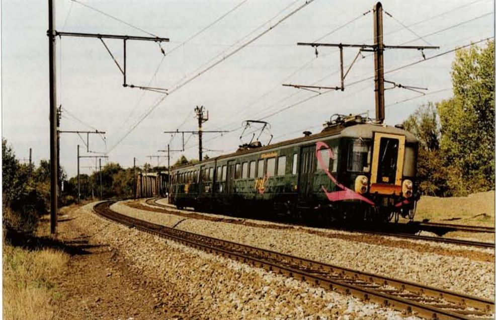
Depuis le début de l'automne dernier, l'automotrice expérimentale 106 effectue une tournée d'inspection sur l'ensemble des lignes électrifiées en 3.000 V, pour contrôler le bon fonctionnement des dispositifs de répétition des signaux. Ci-dessus, elle vient de traverser la canal Charleroi - Bruxelles à l'entrée de la gare de Luttre. *Dominique ALLARD, 25-09-2003.*
