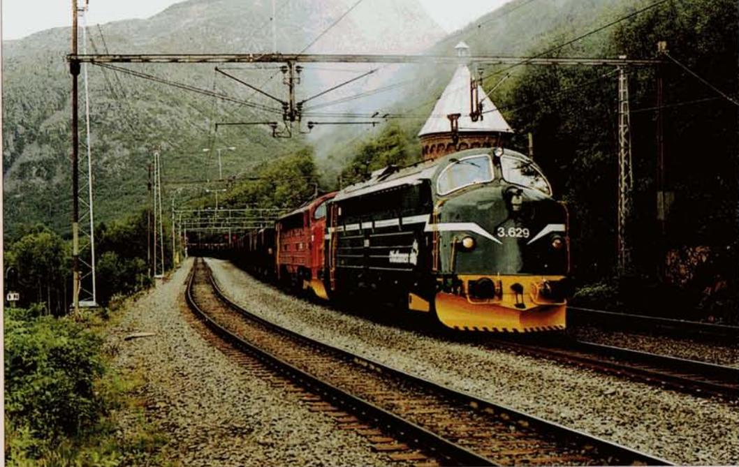
**PHOTO 59-19** Passage à Rombak du train de minerais MTAB 10091 Narvik - Lulea, allégé par les Di3.629 + 623. La locomotive est munie d'une caméra au-dessus du nez, ce qui permet de manoeuvrer dans les gares sans changer de cabine de conduite. Philippe DE GIETER, 20 août 2003.
