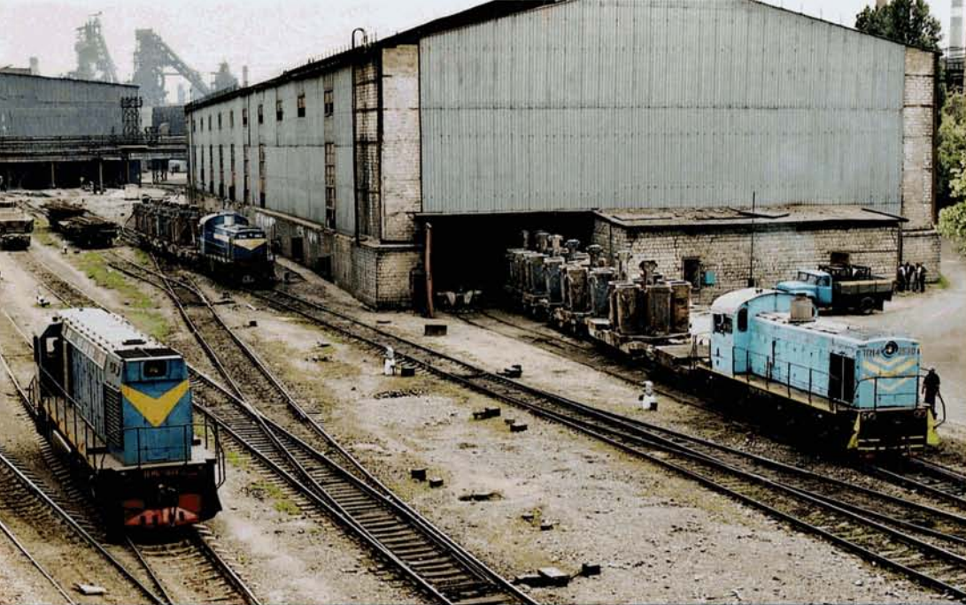
PHOTO 60-10 Dans le vaste complexe de l'usine sidérurgique de Donetsk, Donetzii Metaalurgickche Zavod, le va-et-vient des trains est incessant. De droite à gauche : la TGM4-2530, la TGM4-1962 et la TGM6-1239. Les deux machines à droite manoeuvrent des trains de lingotières. Donetsk, 20 mai 2003. Kristof AVONDS.
