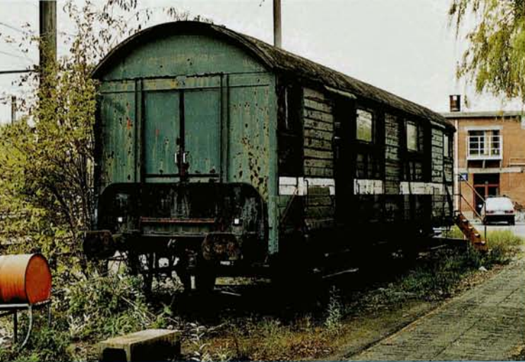
PHOTO 60-12 Un ancien wagon Hbckss à trois portes latérales fut réutilisé jusqu'à la fin des années 1980 dans le train de relevage de Schaerbeek. Par la suite, il fut placé sur le côté des voies du grill de l'atelier Diesel de Schaerbeek pour servir de local. On remarquera que la passerelle d'intercirculation et le boyau de chauffage à vapeur sont toujours présents. Ce véhicule a été démoli le 6 décembre 2003. Jean-Luc VANDERHAEGEN, 30 octobre 2003.
