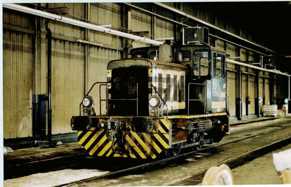
PHOTO 60-35 La machine 9150 de Merelbeke est actuellement toujours utilisée à la manoeuvre du matériel passant au tour en fosse et est d'ailleurs pourvue d'un attelage GF pour manoeuvrer les automotrices Break. Initialement prévue sortir des écritures le 14 décembre 2003, elle a été versée à la Direction M. Pierre HERBIET, 21 décembre 2003.
