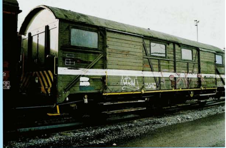
PHOTO 60-13 Un ancien wagon porte-autos fut utilisé dans les années 1990 dans train de secours de la base-travaux de Saint-Druon, ensuite à la base-travaux de Voroux. Il s'agit d'un des 15 véhicules à deux portes latérales. Il sera plus que vraisemblablement encore utilisé sur d'autres bases. Christophe HOLLANGE, 5 décembre 2000.
