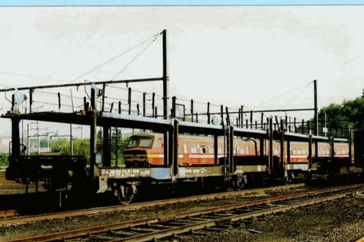
PHOTO 60-15 Deux wagons Laaeks type 3000D1 utilisés par la firme italienne Brambles Italia Milano photographiés devant l'Atelier des wagons de Schaerbeek, le 31 mai 1996. En première position, le wagon portant le numéro UIC 23 88 436 6 028-9. Jean-Luc VANDERHAEGEN.
