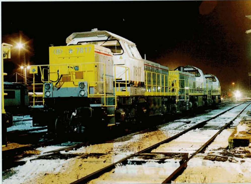
PHOTO 60-35 La machine 9150 de Merelbeke est actuellement toujours utilisée à la manoeuvre du matériel passant au tour en fosse et est d'ailleurs pourvue d'un attelage GF pour manoeuvrer les automotrices Break. Initialement prévue sortir des écritures le 14 décembre 2003, elle a été versée à la Direction M. Pierre HERBIET, 21 décembre 2003.
