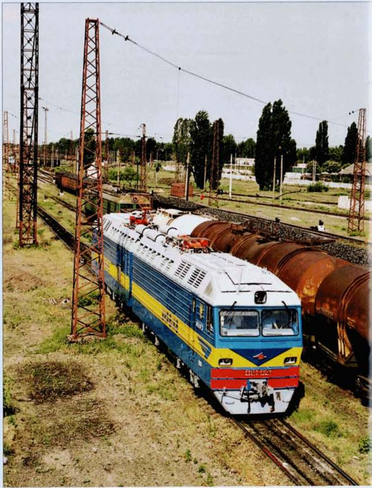
PHOTO 60-07 Une des 18 nouvelles machines doubles Bo'Bo' + Bo'Bo' de la série DE1 dans la gigantesque gare de triage de Uzel Severnykh, le 19 mai 2003. Affectées au trafic marchandises, ces machines développent une puissance de 2 x 3125 kW. Leur masse totale s'élève à 2 x 92 t et leur vitesse maximale est limitée à 100 km/h. Alain DEFECHEREUX.
