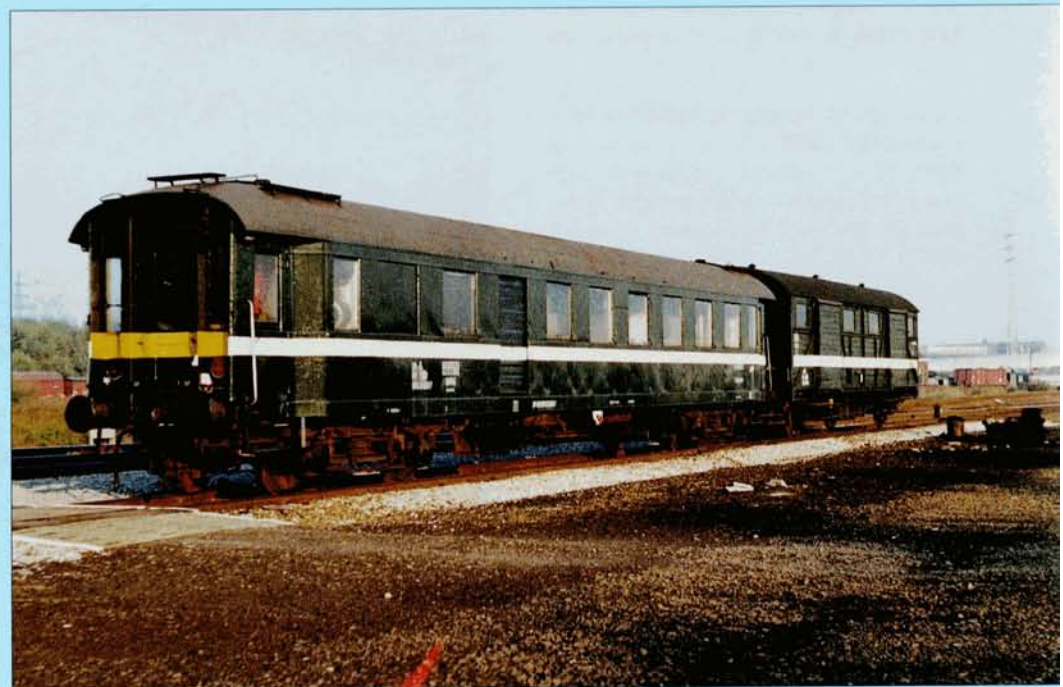
PHOTO 60-14 Le train de secours de l'atelier de Hasselt était composé d'une ancienne voiture prussienne accompagnée d'un ex. Hbckss à deux portes latérales (numéro UIC 30 88 942 1 188-1). Jean-Luc VANDERHAEGEN, 15 octobre 1977.
