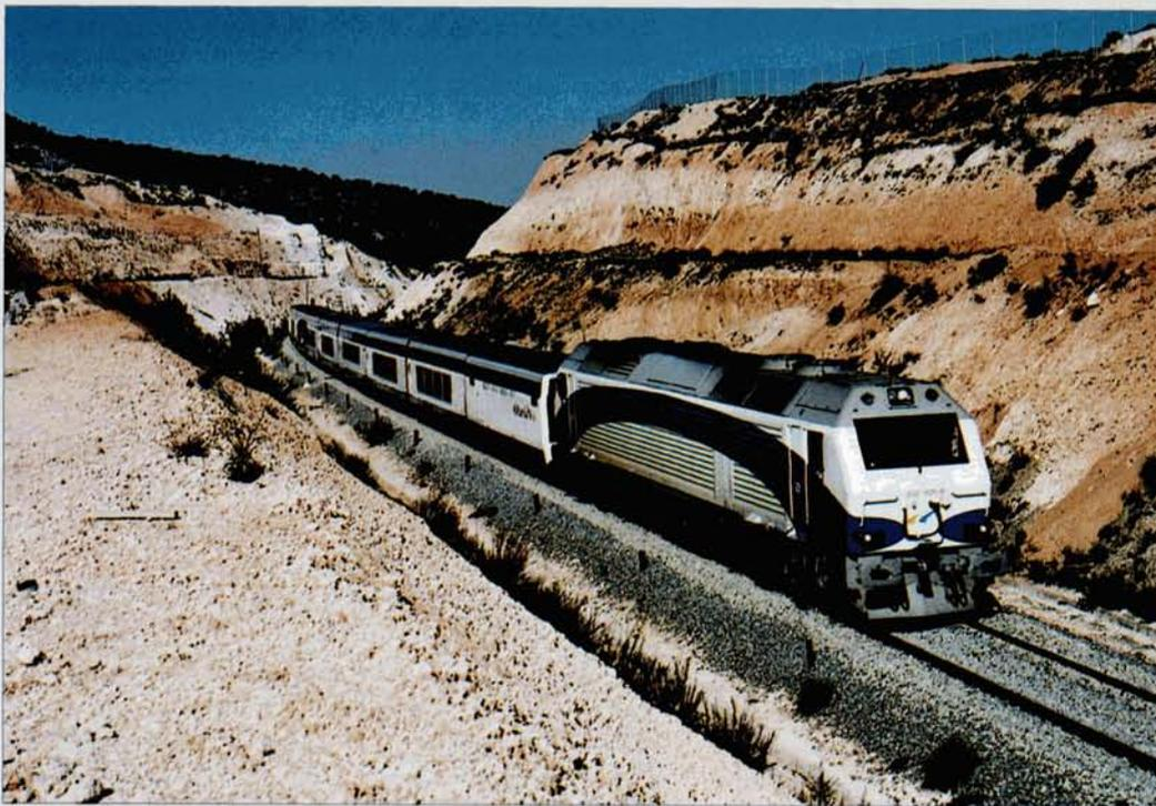
mentée à 200 km/h. La transformation sera réalisée par *Alstom* pour un montant de 72 millions. Leurs bogies à 3 essieux CoCo seront remplacés par des bogies à deux essieux BoBo. Comme les autres 333 transformées,
