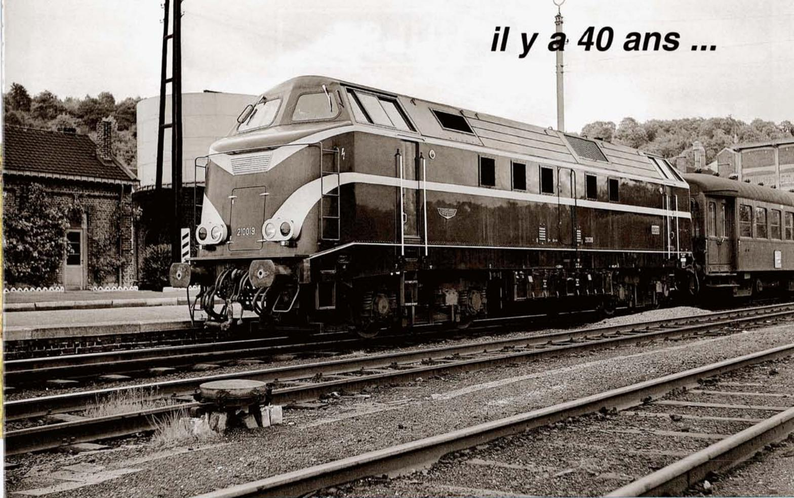
**PHOTO BD-187** Le 30 mai 1964 était livrée la première locomotive Diesel de série du type 210 : la 210.007, future 6007. Elle sera suivie jusqu'en 1966 par les 210.008 à 091 (6008 à 6091) et 210.201 à 215 (6101 à 6115). La 210.019 ici illustrée fut mise en service le 21 août 1964. On la voit à Statte en juin 1966, en tête d'un omnibus à destination de Namur. Bruno DEDONCKER, collection PFT.
