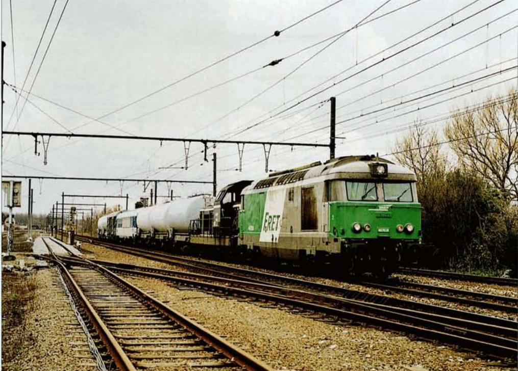
**PHOTO 62-34** Le 25 mars 2004, le train de désherbage de la SNCF a effectué une incursion sur le réseau belge, afin de traiter les deux sections frontalières entre Lille et le point-frontière de Mouscron, et entre Lille et le point-frontière de Blandain. Arrivée à Tournai du train 811764 en provenance de Mouscron, remorqué par les 467528 et 66160. Pierre HERBIET.
