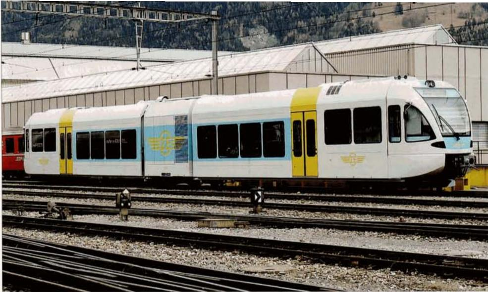
Un des 12 nouveaux autorails à voie étroite des OSE, testé en Suisse sur les Chemins de fer Rhétiques (RhB), stationne au dépôt de Landquart du RhB. Ces autorails se composent de trois éléments : deux remorques-pilotes à plancher surbaissé, entre lesquelles est intercalé un petit module moteur à deux essieux. Michel HANSENS, 13 décembre 2003.
