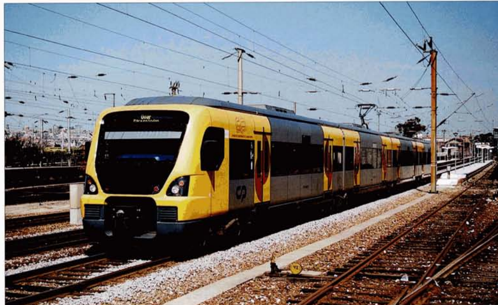
De 1998 à 1999, les CP ont mis en service 30 automotrices quadruples à 2 niveaux basées sur les Z22500 de la SNCF (constructeurs : GEC, Alstom et CAF, puissance 3000 kW, 488 places assises + 72 debout, masse vide 221 t, vitesse maximale 140 km/h, numéros : 3501/3551 à 3530/3580). La rame 3529/3579 à Linason Oriente. A. BEERLANDT, 8 avril 2004.
