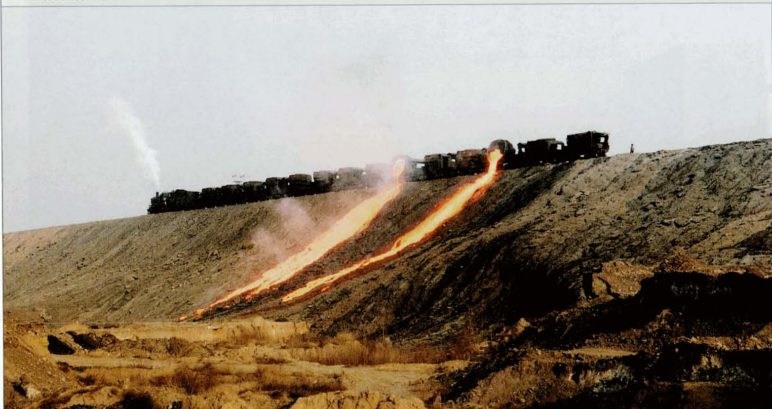
Peut-être un des aspects les plus spectaculaires de la vapeur industrielle en Chine : le déversement du laitier en fusion en provenance des hauts fourneaux, comme ici à Baotou le 22 décembre 2003. Même à cette distance, la chaleur dégagée par cette véritable lave est intense. Dave HABRAKEN.
