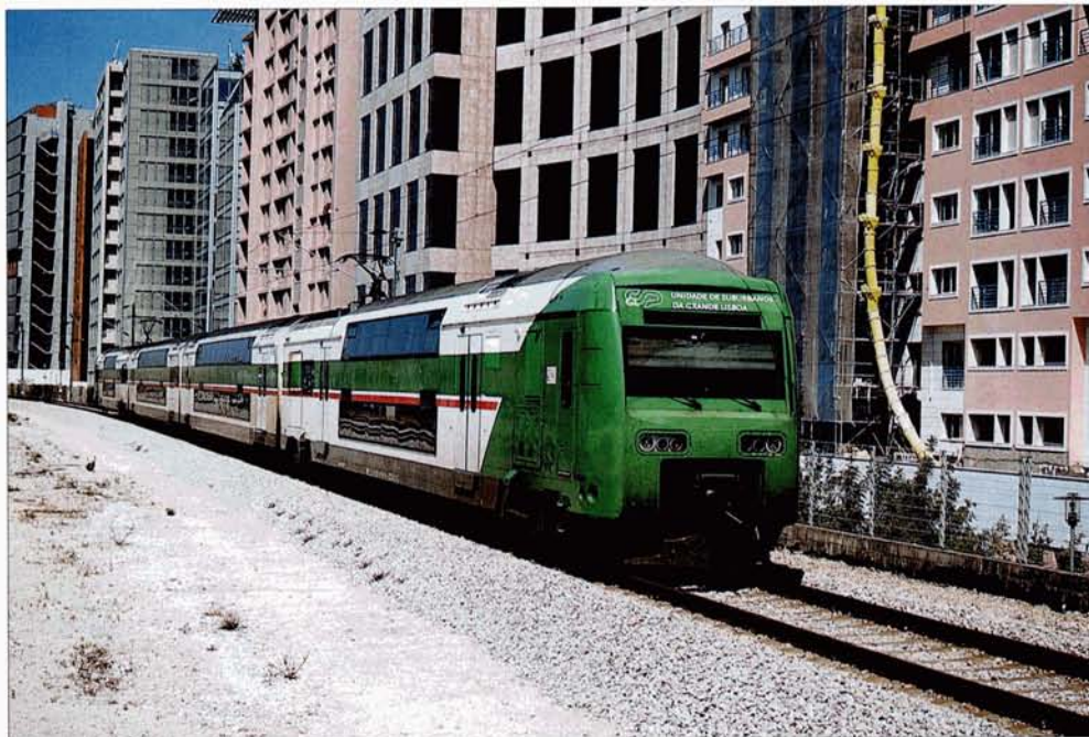
De 1998 à 1999, les CP ont mis en service 30 automotrices quadruples à 2 niveaux basées sur les Z22500 de la SNCF (constructeurs : GEC, Alstom et CAF, puissance 3000 kW, 488 places assises + 72 debout, masse vide 221 t, vitesse maximale 140 km/h, numéros : 3501/3551 à 3530/3580). La rame 3529/3579 à Linason Oriente. A. BEERLANDT, 8 avril 2004.
