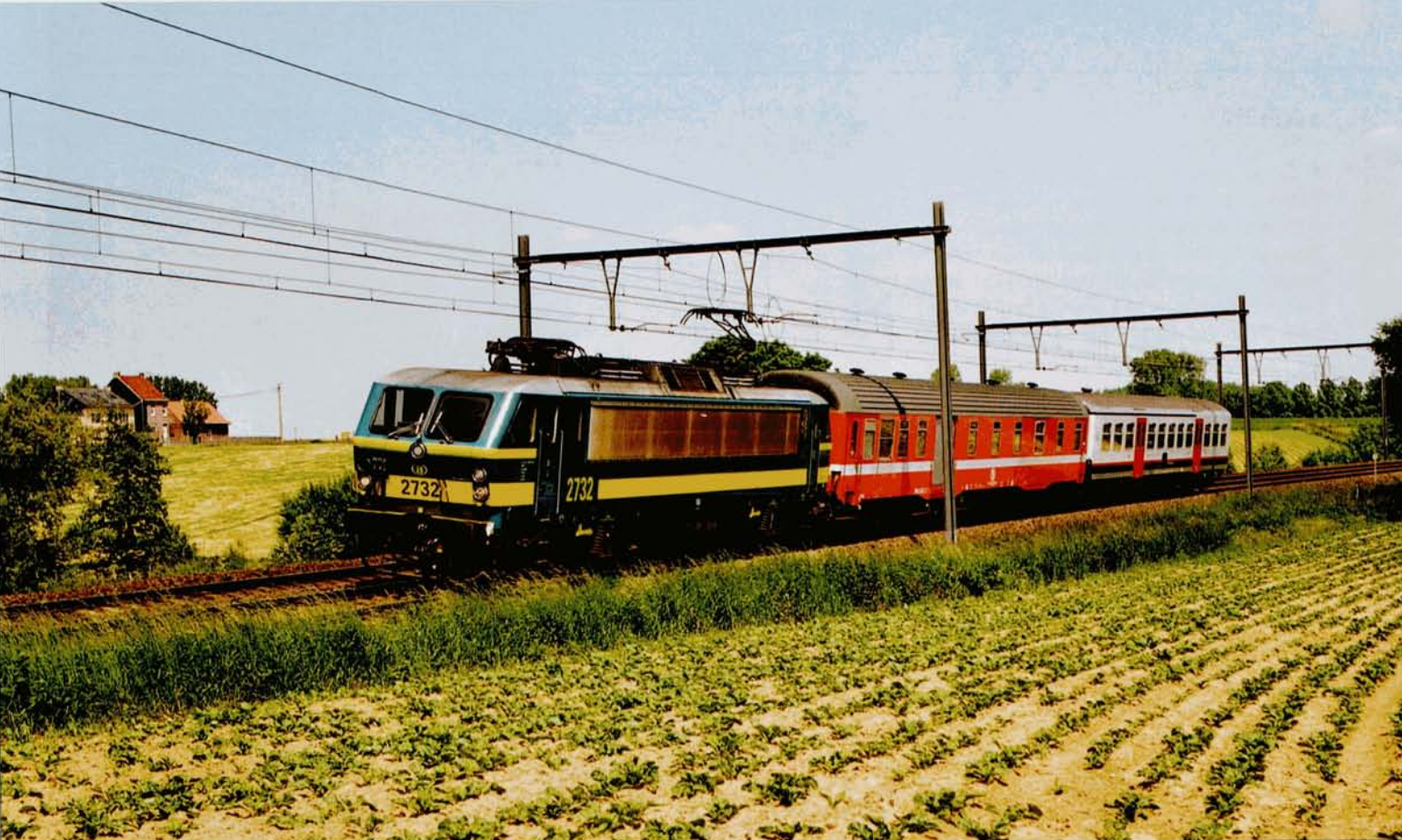
PHOTO 63-44 Du 1 au 3 juin, des essais de freinage ont été réalisées au "bois du Coucou" entre Ath et Silly avec une voiture du type M4 pourvue de nouvelles semelles de frein dans le but de réduire le niveau sonore du roulement. La voiture, accompagnée du fourgon Dms 17.401 transformé en véhicule de mesures (voir EN LIGNES 61 page 31), a été acheminée de Schaerbeek à Ath le 27 mai par la 2732, ici photographiée dans les environs de Marcq sur la section Enghien - Silly de la ligne 94. Eric VAN HOECK.
