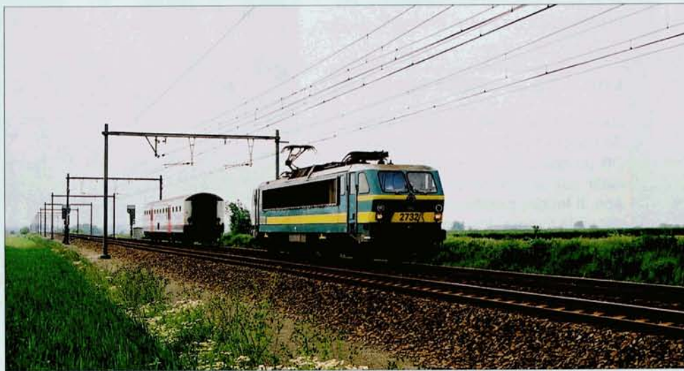
La voiture M4 est décrochée à 120 km/h avec déclenchement d'un freinage d'urgence. La distance de freinage est ensuite calculée et comparée avec les chiffres des voitures équipées de semelles normales. Silly, 2 juin 2004. Philippe SCHOLL.
