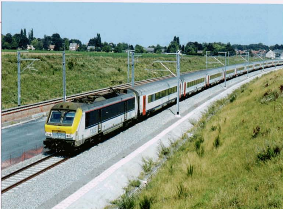
Entre les gares de Kortenberg et de Nossegem, passage de l'IC 536 Eupen - Oostende, mené par la 1325. L'assiette de la ligne 36N est terminée et attend la pose des voies.
