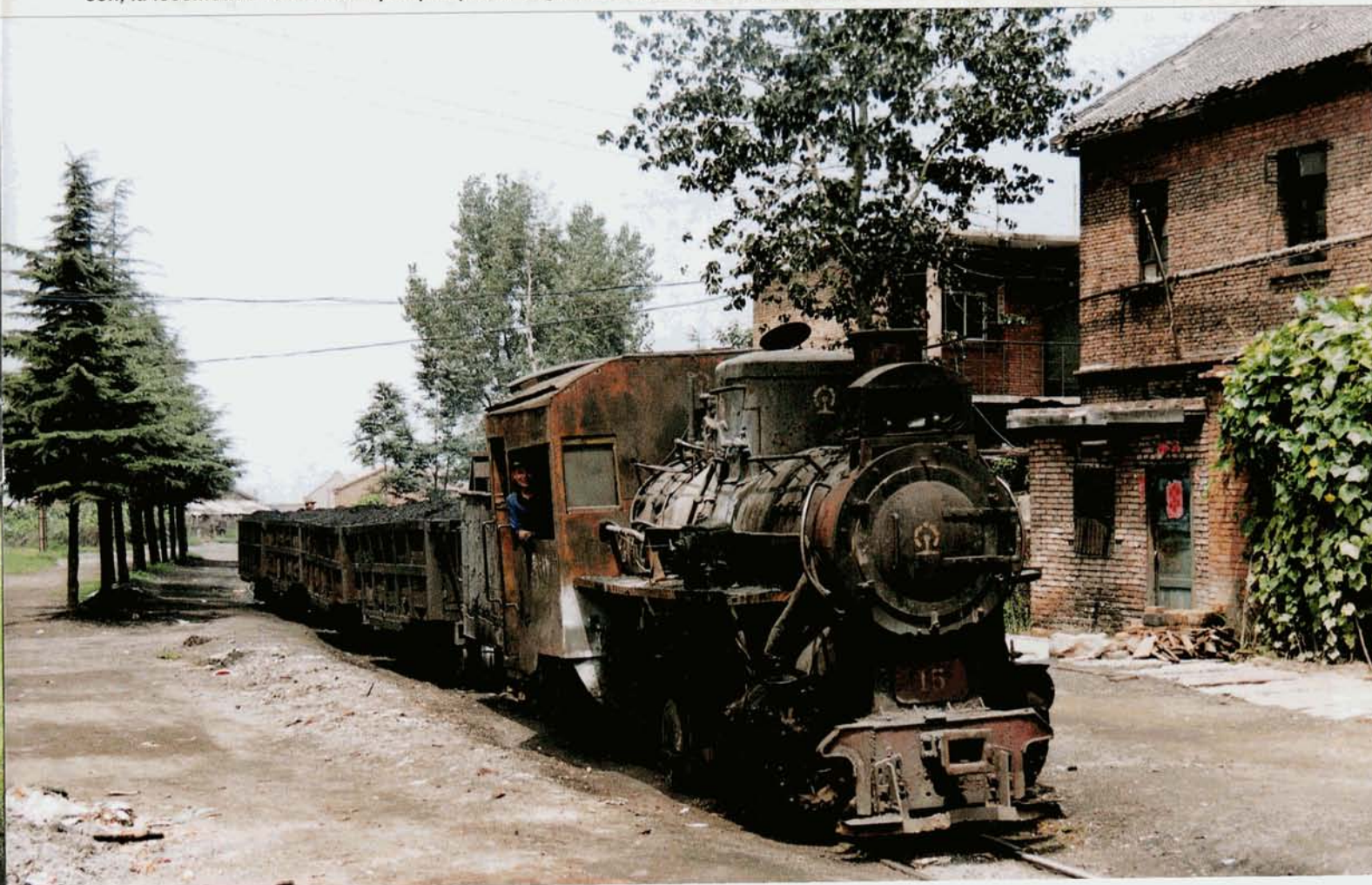
PHOTO 64-49 A Xiangyang, sur le "Yinghao Coal Railway", une courte antenne bifurque pour desservir le charbonnage de Lingwa. Sur ce court trajet établi en très forte rampe, les C2 ont le plus grand mal pour remorquer leur lourde charge. Pour cette raison, la locomotive 15 ne remorque que quatre wagons de charbon vers Xiangyang. Dave HABRAKEN, 8 août 2004.
