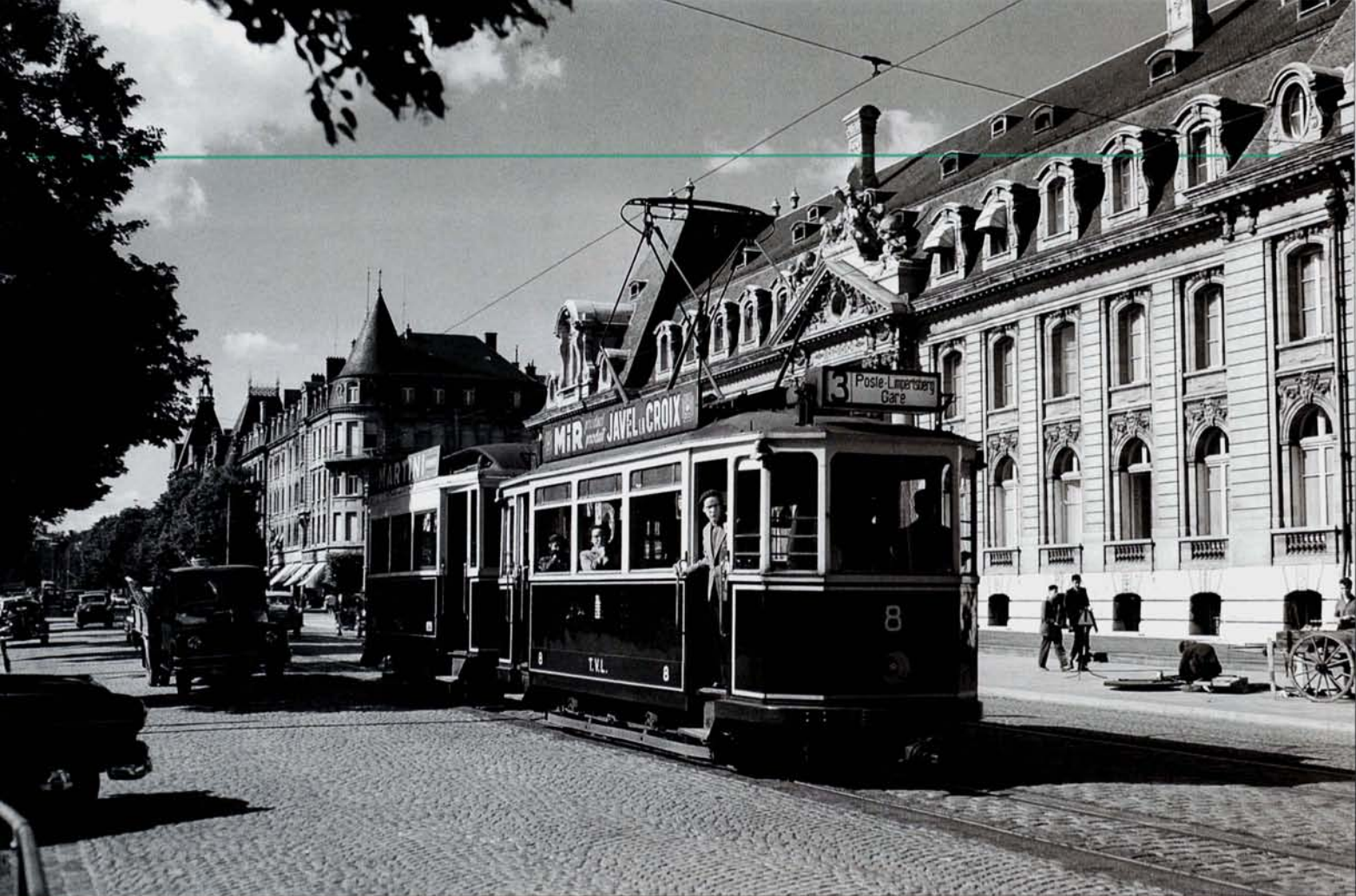
PHOTO BD-195 La motrice n° 8 et la remorque 109 photographiées le long de l'avenue de la Libération, le 30 juin 1956. Ce véhicule fait partie des premières motrices d'origine mises en service en 1908, et construites par Waggon Fabrik Uerdingen.
