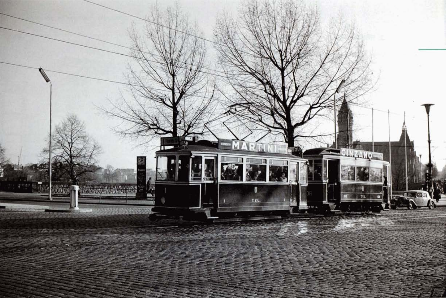
PHOTO BD-193 Le 25 novembre 1957, passage à la Place de Bruxelles en direction de la gare de la motrice n° 1 accompagnée de la remorque 108. Le réseau des TVL était électrifié à la tension de 550 V continu. Bruno DEDONCKER, collection PFT.
