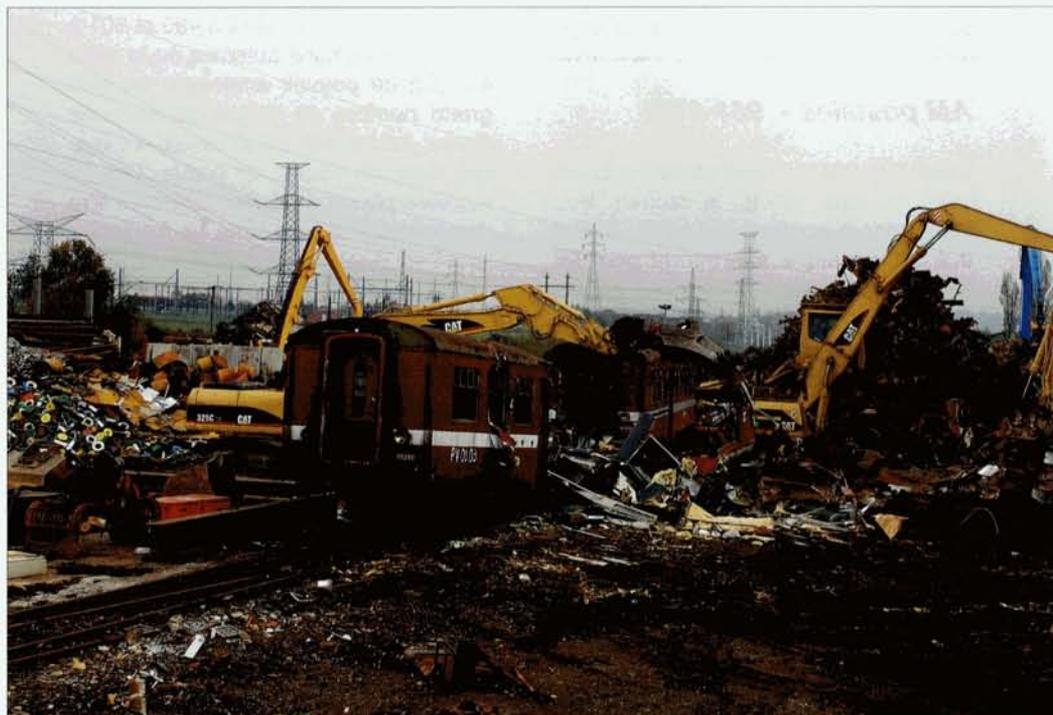
**PHOTO 65-27** Comme signalé dans les pages précédentes, en plus des locomotives des séries 22, 59, 76 et 82, le chantier de ferrailage LUXFER d'Aubange démolit également un lot de 70 voitures du type M2. Le 11 novembre 2004, les engins de démolition s'activaient sur la voiture 49310, tandis que la M2 42612 attend son tour. Il ne faut pas plus de 30 minutes pour mener à bien l'opération...
