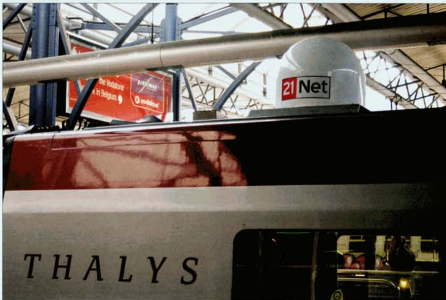
L'antenne pour la captation d'Internet de la rame TGV PBA 4540 est loin de passer inaperçue.
