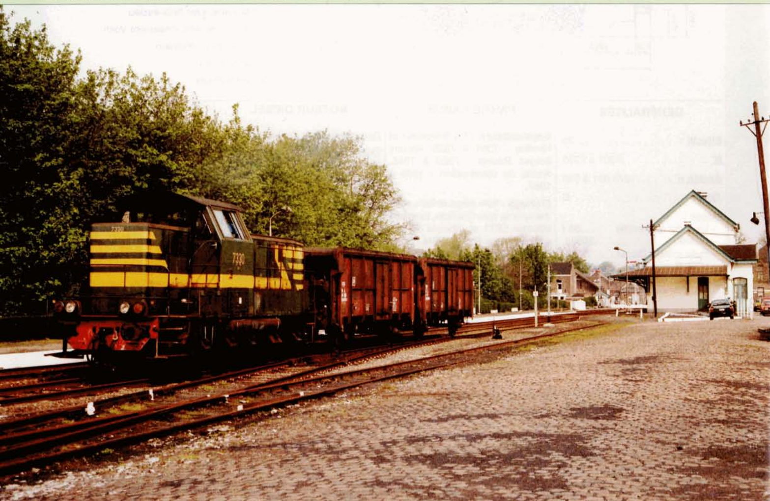
PHOTO-THEME 66 Le 3 mai 1984, deux wagons tombereaux à toiture enroulable du type Tms 1215B3, traversent, au crochet de la 7330, la gare de Courcelles-Centre en direction de Monceau. Pierre HERBIET.
