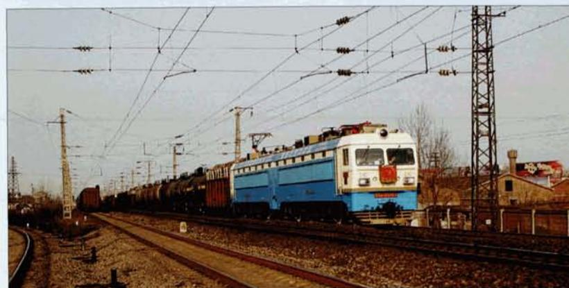
**PHOTO 68-10** Le trafic marchandises en Chine est considérable. Ici, un train mixte remorqué par la locomotive double SS4-0516 à Handan, le 4 janvier 2005. Ces machines doubles BB + BB construites depuis 1986 développent 6400 kW, pèsent 184 t et ont une vitesse limitée à 100 km/h. Photo PFT.
