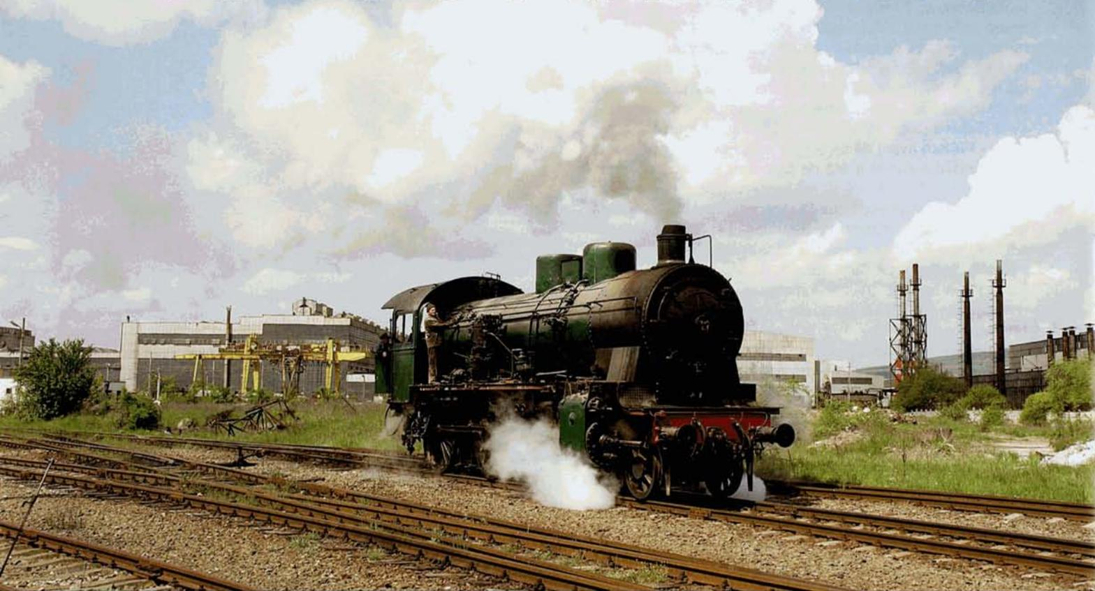
**PHOTO 68-70** La future 64.169 effectue ses premiers tours de roues en chauffe; le tender est toujours en cours de restauration et n'est pas accouplé à la machine.
