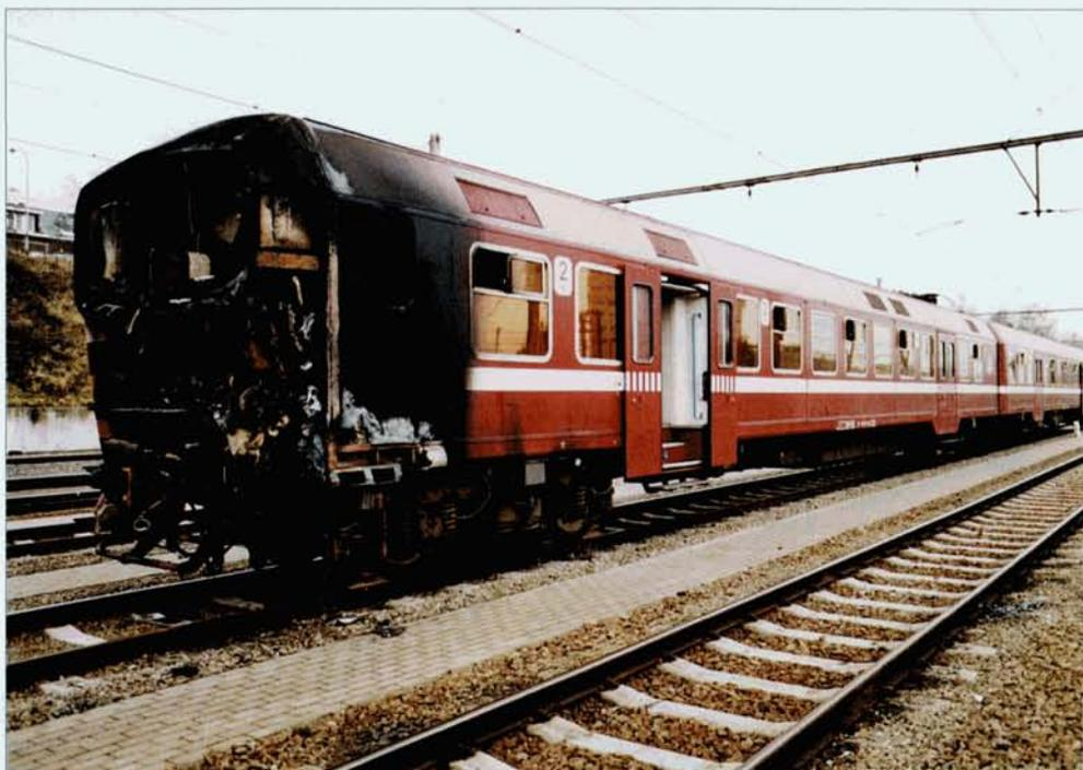
**PHOTO 68-73** En décembre 2004, l'automotrice 927 a percuté une voiture sur un passage à niveau de Wijgmaal sur la ligne 53 Mechelen - Leuven. La voiture encastrée sous l'automotrice a pris feu, lequel s'est propagé à l'avant de la 927. Leuven, 11 décembre 2004. Hans JOOSEN.
