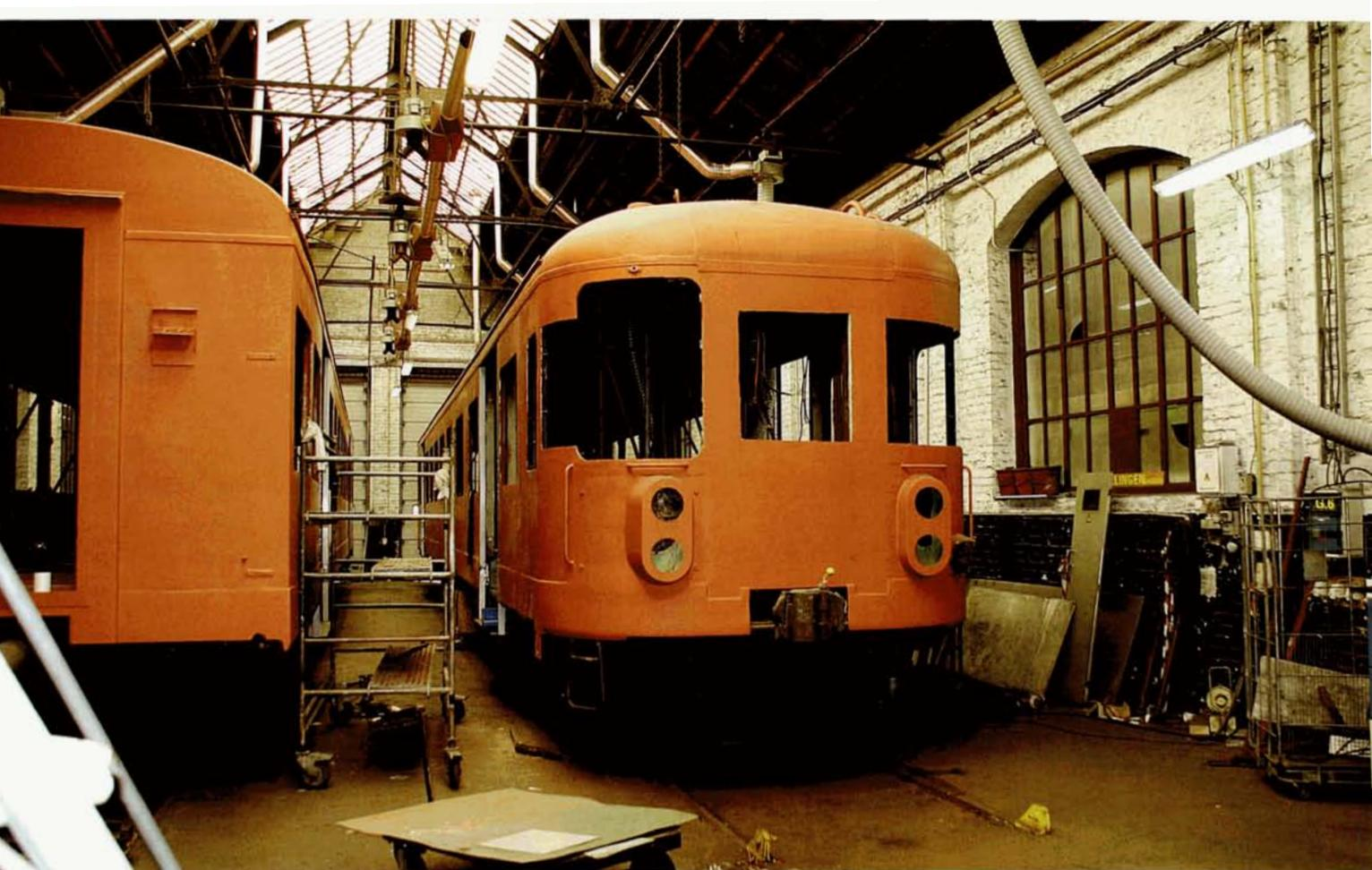
**PHOTO 68-35 ↑ - PHOTO 68-36 ↓** Deux autres vues de la chaîne de transformation. Ci-dessus : la seconde rame sur laquelle les portes d'intercirculation sont supprimées. Ci-dessous, l'automotrice qui conservera son intercirculation. On voit très bien la suppression des grands pare-brise panoramiques par des petites fenêtres.
