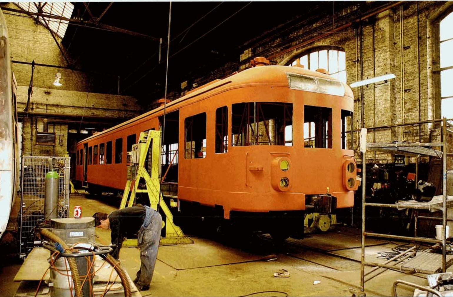
**PHOTO 68-33** Voici une des deux automotrices sur laquelle la porte d'intercirculation a été supprimée et remplacée par un pare-brise.
