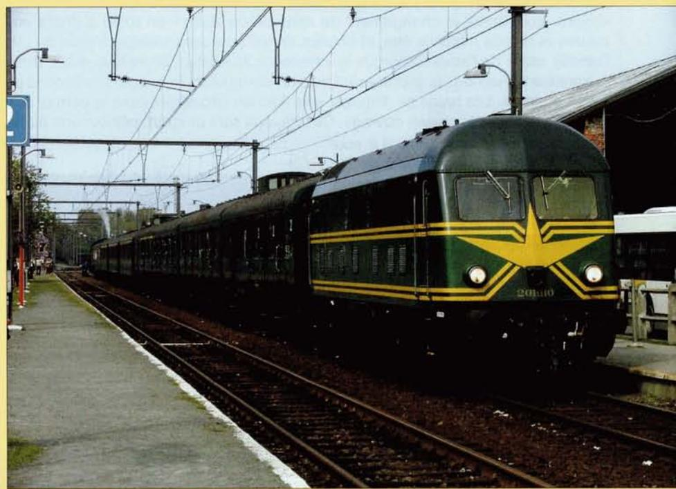
**PHOTO 68-74** Deux locomotives Diesel d'Eurotunnel expédiées de Frethun vers l'atelier de Tilburg pour révision, ont effectué une escale à Antwerpen-Noord le 14 mars 2005. Eurotunnel possède cinq machines des types DE 1003 de MaK, utilisées pour assurer les trains de maintenance et de secours. D'une puissance de 1040 kW, elles sont dérivées des 6400/6500 de Railion Nederland. Ces engins disposent d'un dispositif spécial anti-pollution. Hans JOOSEN.
