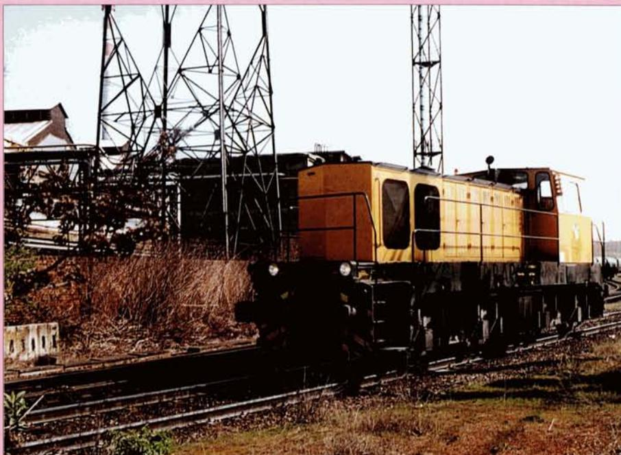
Le 12 avril 2005, après avoir amené un train dans le faisceau de La Louvière-Gare Industrielle, la 701 retourne vers le raccordement DUFERCO. Par rapport à sa version originale, on remarquera la modification des grilles du groupe de refroidissement et les nouveaux phares. La machine est revêtue de la livrée CMI jaune et noire. Roger CRIKELAIRE.
