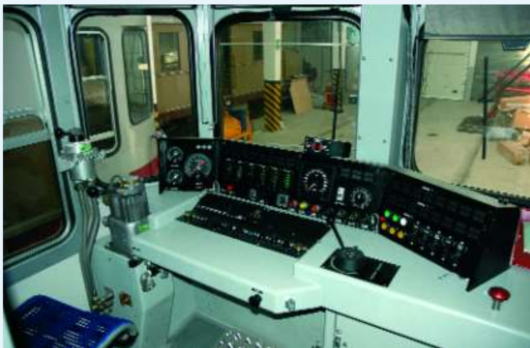
↑ PHOTO 77-11 Le pupitre de conduite a été entièrement reconstruit et disposé sur toute la largeur de la caisse. Les travaux de transformation des automotrices ont été réalisés par la société Metalmeccanica Milanese, pour un coût de € 370.000 par rame.
