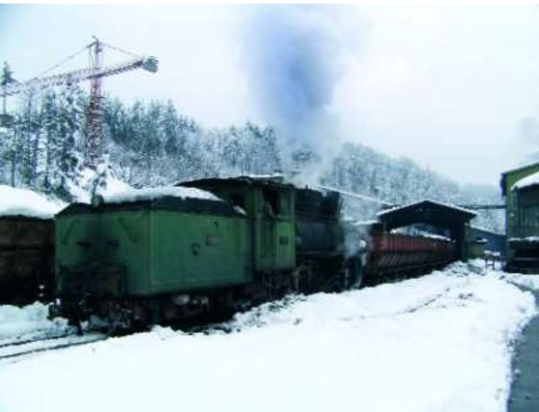
La superbe 83-159 (0-4-1 à écartement de 760 mm) à Oskova poussant un à un les wagonnets à déchargement automatique. Il s'agit de la dernière machine de ce type encore en service commercial. Elle fut construite par Duro Dakovic en 1948. Thomas VAN WETTEREN.
