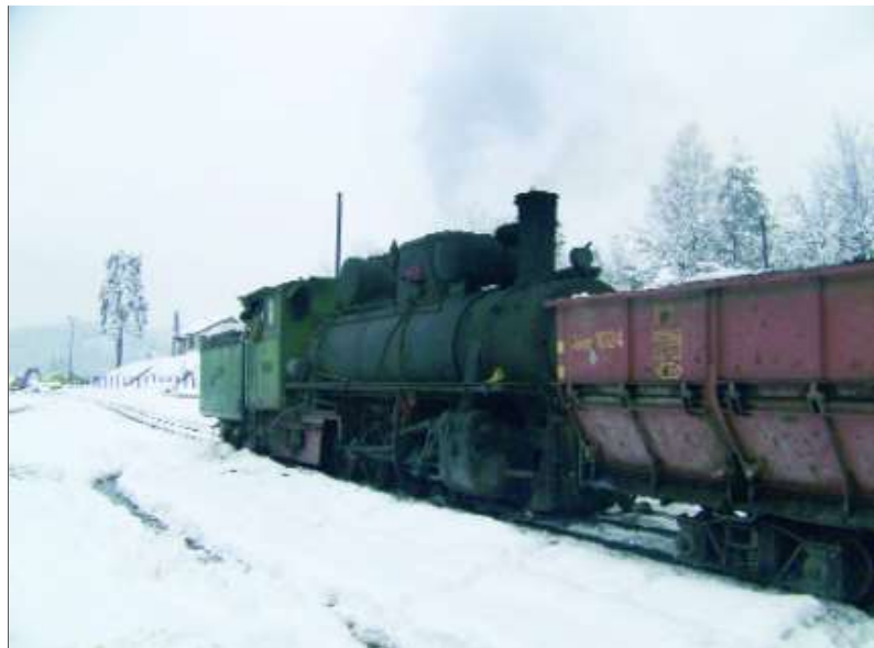
La superbe 83-159 (0-4-1 à écartement de 760 mm) à Oskova poussant un à un les wagonnets à déchargement automatique. Il s'agit de la dernière machine de ce type encore en service commercial. Elle fut construite par Duro Dakovic en 1948. Thomas VAN WETTEREN.
