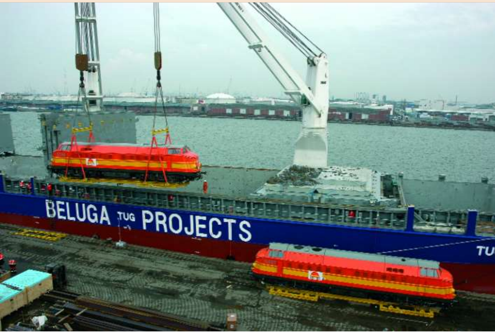
PHOTO-THEME 85 Par moment, le berceau accusera une inclinaison impressionnante, rapidement corrigée par les grutiers.
