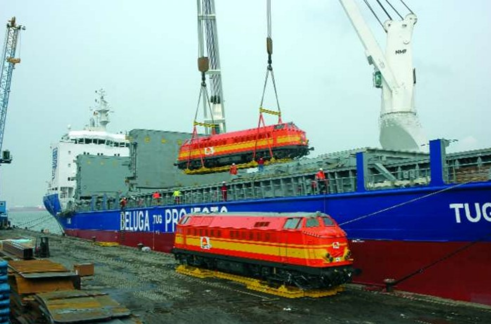
PHOTO-THEME 85 Dans un silence total, l'opération étant très délicate, la 5146 est soulevée dans les airs, suspendue par des câbles aux crochets des deux grues du cargo. La 5101 attend son tour. Dave HABRAKEN.
