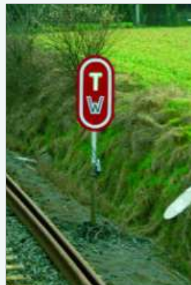
signal d'arrêt, les lettres T et W clignotent en vert
