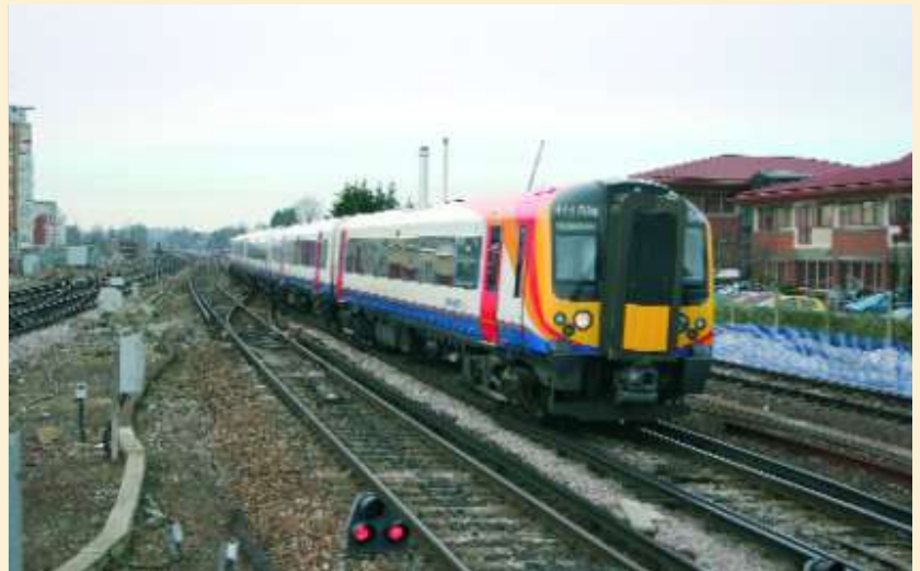
PHOTO 85-24 Le modèle Desiro UK est totalement différent, conçu spécialement pour la Grande Bretagne. Ici, l'automotrice électrique (750 V par troisième rail) à cinq éléments 444 038 de South West Trains (45 automotrices mises en service en 2004, utilisées au départ de London Waterloo), à son arrivée à Basingstoke le 11 février 2006. Philippe DE GIETER.
