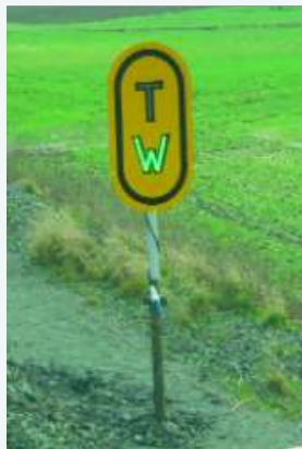
signal avertisseur, les lettres T et W clignotent en vert
