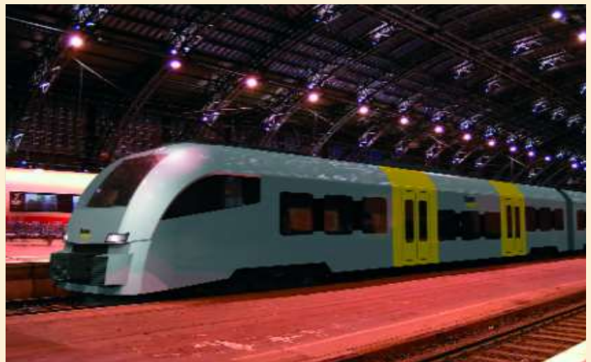
PHOTO 85-24 Le modèle Desiro UK est totalement différent, conçu spécialement pour la Grande Bretagne. Ici, l'automotrice électrique (750 V par troisième rail) à cinq éléments 444 038 de South West Trains (45 automotrices mises en service en 2004, utilisées au départ de London Waterloo), à son arrivée à Basingstoke le 11 février 2006. Philippe DE GIETER.
