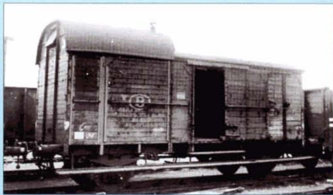
Le fourgon 4020(1) n°13.467 faisait partie des fourgons allemands de la série 13.000 à 13.700 hérités par la SNCB. C'est le châssis de ce type de véhicule qui sert pour la construction des nouveaux fourgons 13.601 à 13.603.
