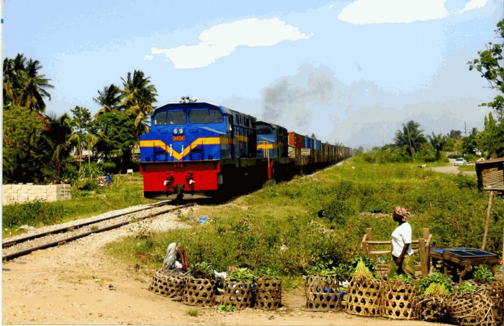
PHOTO 92-64 Le 11 janvier 2009, départ de Dar es Salaam d'un train de marchandises remorqué par deux locomotives de la série 8800. Ces 1Co'Co'1 furent produites à 35 unités en 1972 et en 1979 par la MLW au Canada. Puissance : 1880 CV; masse totale : 103 t, vitesse maximale : 72 km/h. Yves STEENEBRUGGEN.
