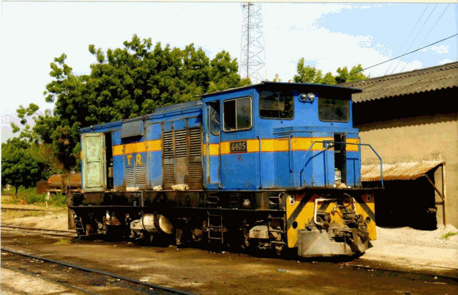
PHOTO 92-65 Thyssen Henschel a livré en 1979 une série de 24 B'B' à transmission hydraulique, formant la série 6400 (puissance 740 CV, masse totale 38,6 t, vitesse 72 km/h). Voici la 6405 au dépôt de Dar es Salaam le 10 janvier 2009. Thierry NICOLAS.
