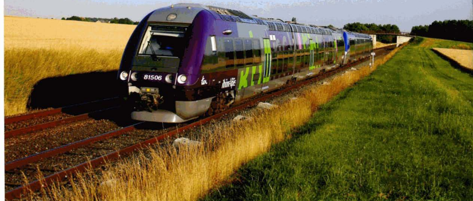
PHOTO 92-55 Le 10 juillet 2008, passage à Osmoy (ligne Tours-Nevers) de deux automotrices AGC bimode B-81500. La première (B-81506/505 a reçu une livrée pour la région Rhône-Alpes. A noter que chaque voiture motrice à son numéro propre. Philippe DE GIETER.
