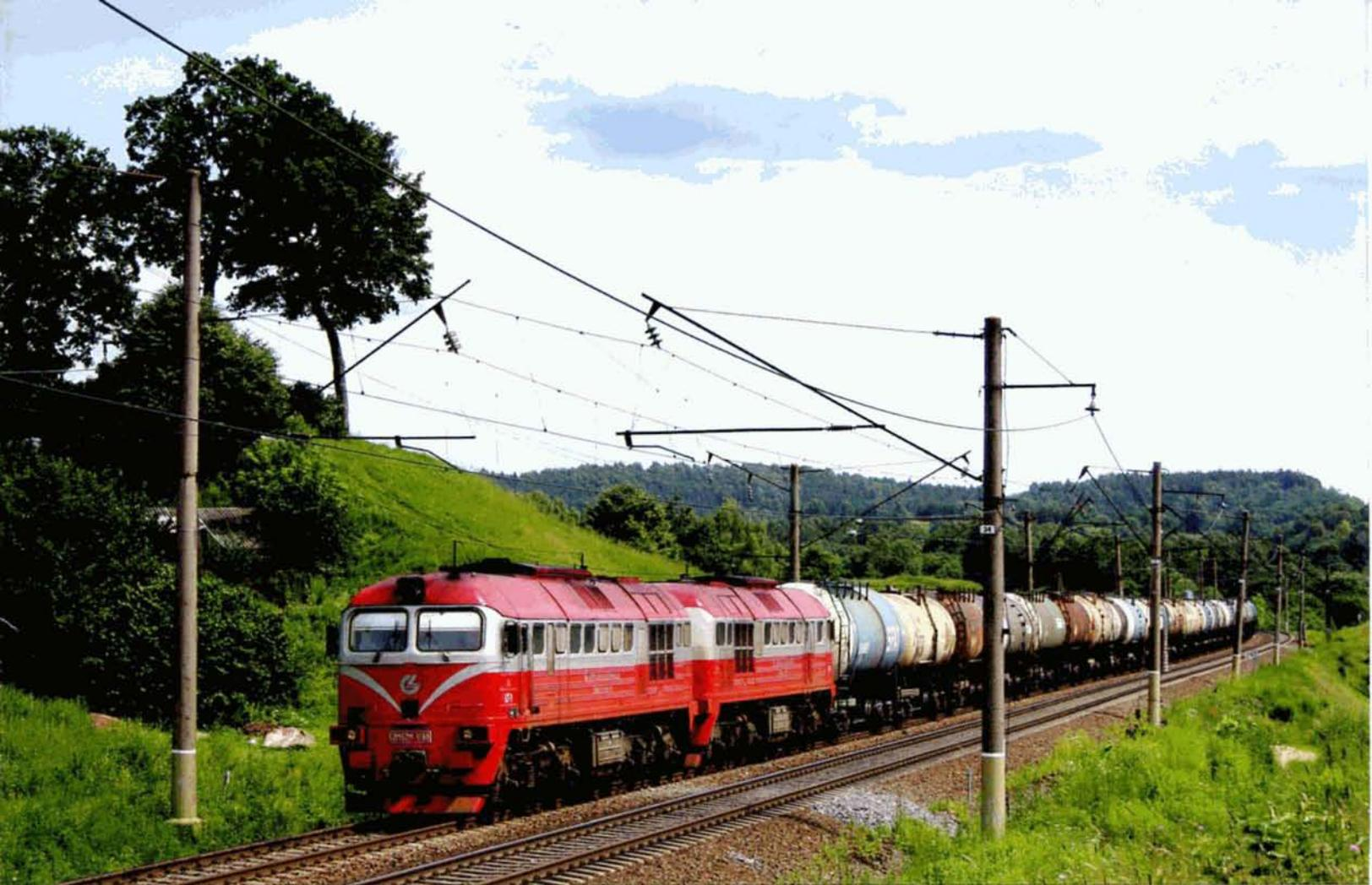
**PHOTO 93-70** En 2005, les LG ont entamé la modernisation de 40 locomotives Diesel doubles du type 2M62, équipées de nouveaux moteurs Diesel Caterpillar. Le 1er juillet, arrivée à Vilnius de la 2M62 1198 récemment repeinte. Lars LAENEN.
