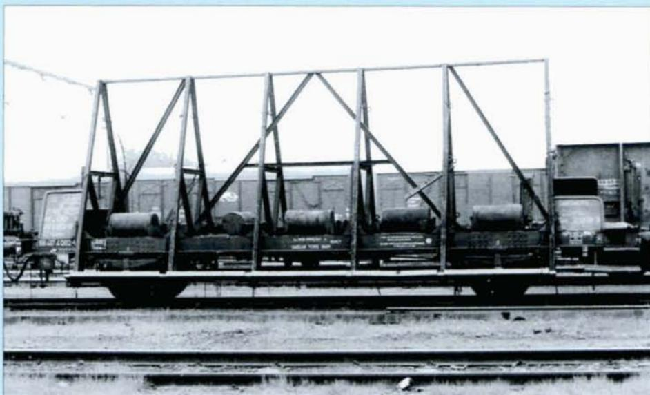
*Le wagon 3000B3 Lklps, n° UIC 21 88 417 4 002-8, photographié en 1984. On remarquera les contrepoids sous forme de rouleaux, permettant d'équilibrer le wagon.*
