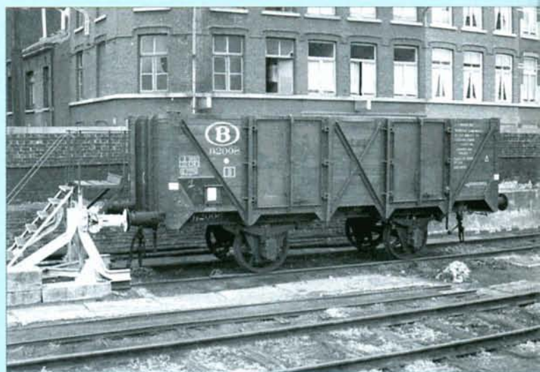
PHOTO BD-9806 Les wagons de service étaient numérotés dans la tranche 84.001 à 94.000. Voici le tombereau 92.008 pour le transport d'immondices. Il s'agit d'un wagon "Armistice" devenu plus tard le type 1211A(3). Liège-Guillemins, 2 juillet 1962. Photo Bruno DEDONCKER, collection PFT.
