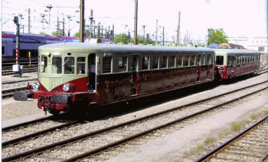
Après sa restauration, l'autorail De Dietrich Z105 et sa remorque RZ 1011 devraient à nouveau être autorisés à circuler sur le réseau CFL pour l'automne, après que tous les problèmes administratifs aient été résolus. La photo a été réalisée aux ateliers de Pétange lors des essais d'embrayage, le 22 mai 2010. Christian SCHMIDT.
