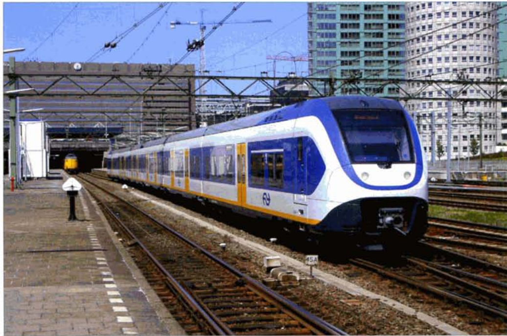
PHOTO 98-69 Les automotrices SLT à six caisses ont une longueur de 100 mètres et offrent 610 places (dont 322 assises). La 2624, livrée le 1er avril 2010, quitte Den Haag CS comme Sprinter 9851 pour Utrecht, le 3 juin 2010. Philippe DE GIETER.
