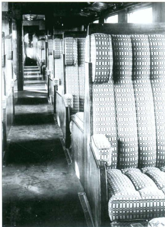
L'aménagement intérieur de la deuxième classe comportait des fauteuils très confortables, rembourrés et pourvus d'accoudoirs. La disposition était de 2 + 2 places de front, avec couloir central. Photo SNCB.
