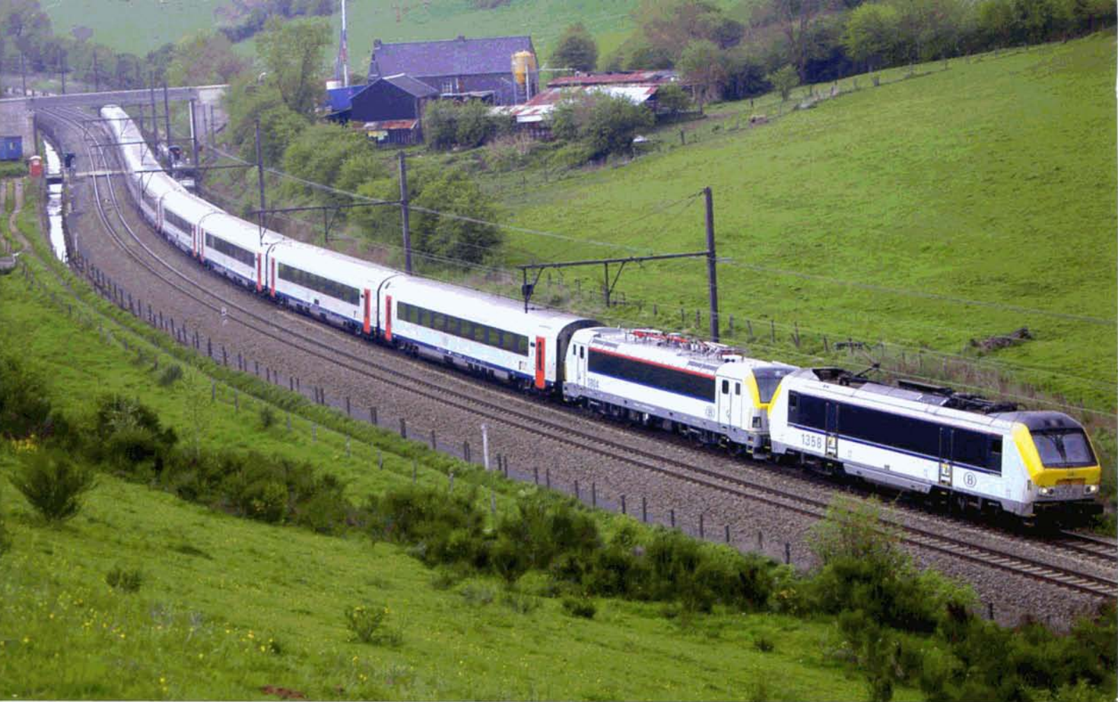
PHOTO 98-18 ↑ Durant plusieurs jours, la 1804 fut intercalée dans une rame assurant les IC-A Eupen - Oostende. Le but de ce test était de mesurer l'usure des plaquettes de frein. Le 15 mai, passage à Ruyff (peu après Welkenraedt) de l'IC-A 541 à destination d'Oostende. Jean-Yves LAMBIET.
