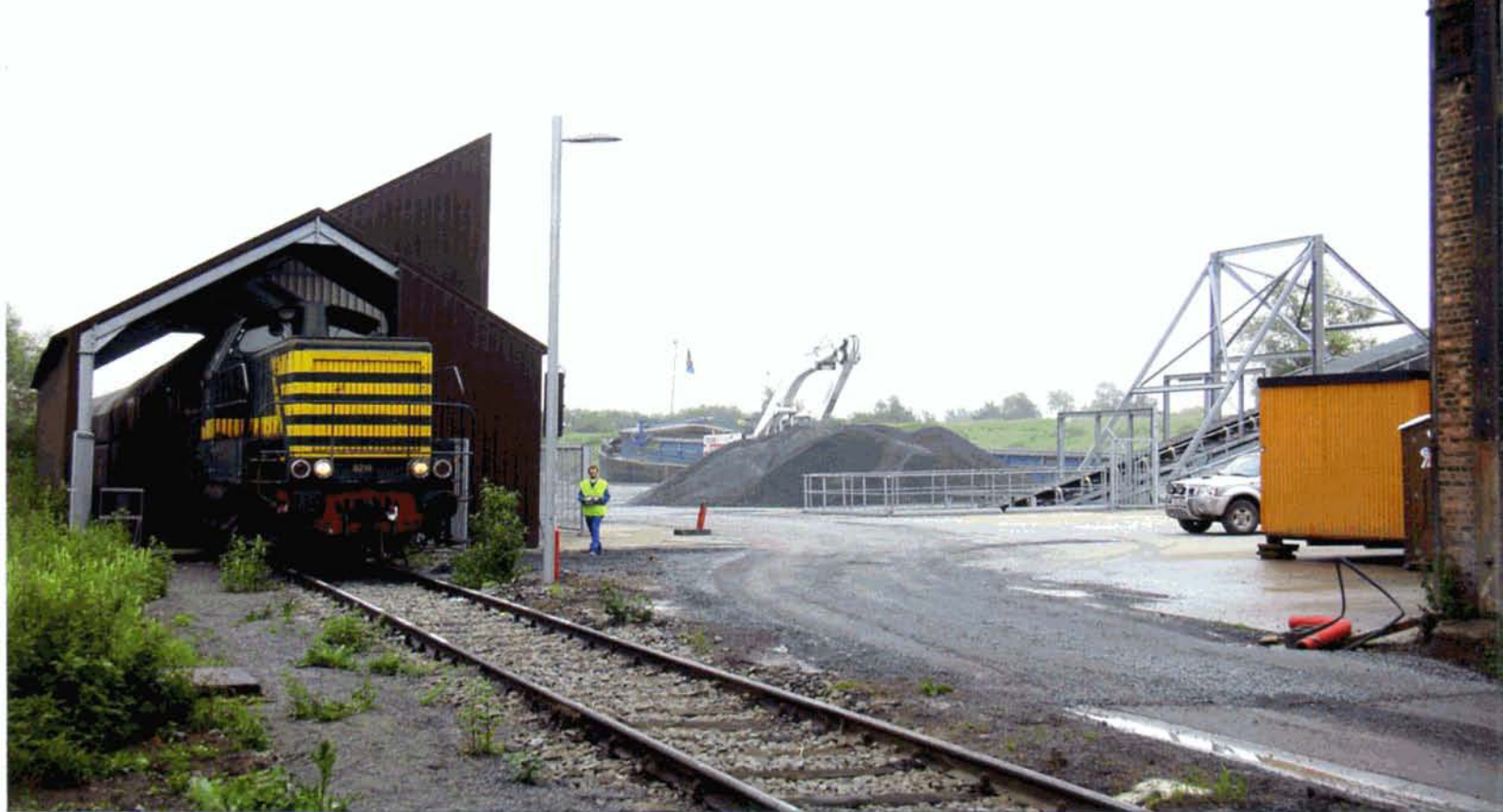
PHOTO 98-23 ↑ Depuis le 10 mai, la 8214 est utilisée par OSR (On Site Rail), une filiale d'Inter Ferry Boats - voir EN LIGNES 96 pages 14-16) le long du canal à Clabecq, pour manoeuvrer les wagons chargés de ballast en provenance de la carrière de Quenast. Le 10 juin, elle manoeuvre une rame au-dessus de la trémie de déchargement qui amène les pierres directement dans les péniches, à destination des Pays-Bas. Pierre HERBIET.
