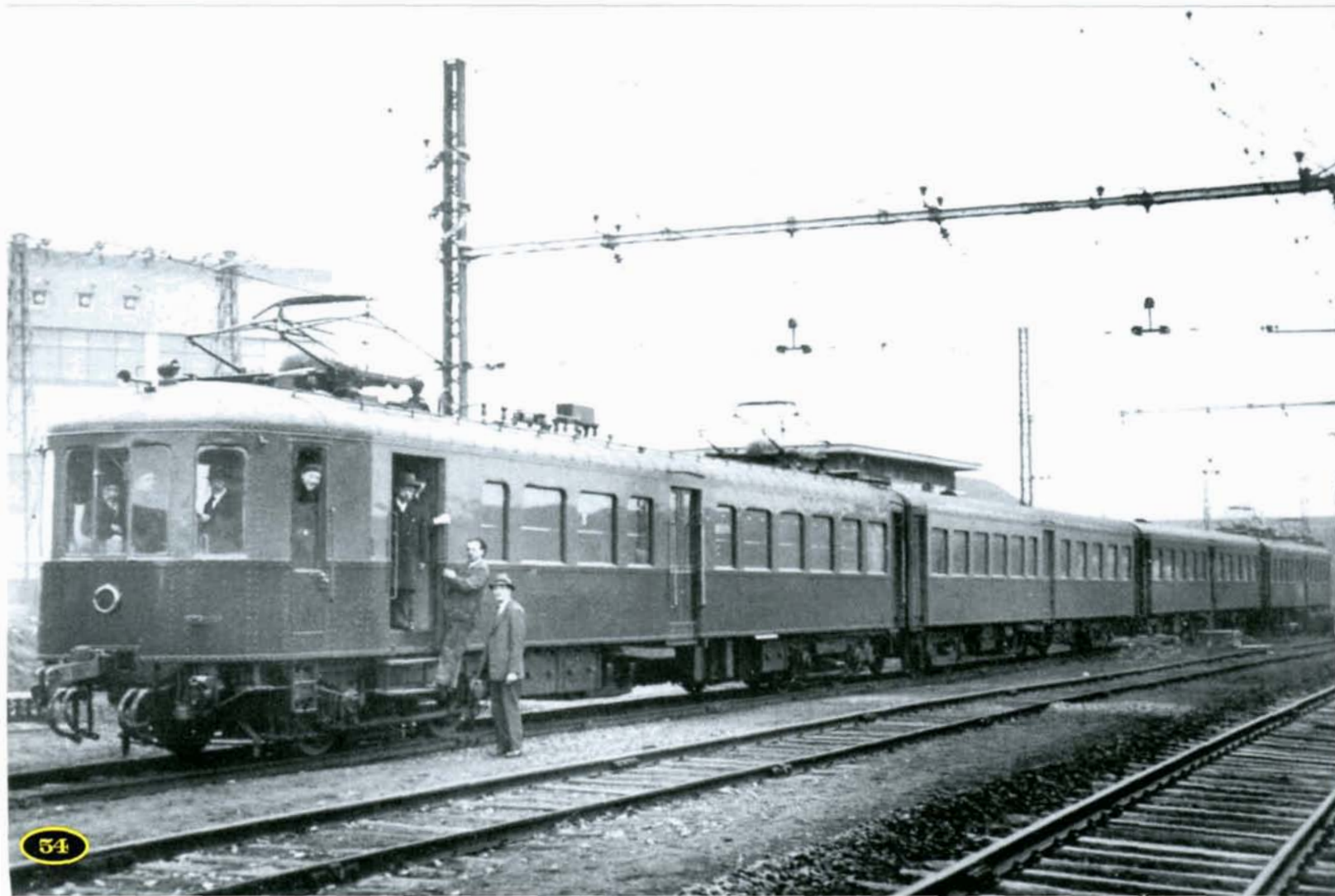
Le 5 janvier 1935, moins de deux ans après la décision d'électrification, une rame complète, mais sans aucun marquage, s'apprête à effectuer le tout premier parcours d'essai vers Mechelen. Un attelage de secours est monté sur l'attelage Henricot. La photo a été prise à la sortie de Schaerbeek, à hauteur de la sous-station d'Haren, laquelle est visible à gauche. A l'avant-plan en bas à droite, on voit la voie A vers Antwerpen de la ligne 25. Au fond de l'image à droite, on devine le talus de la ligne 26. Photo SNCB.
