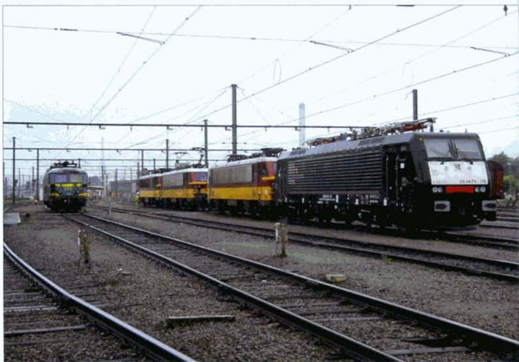
PHOTO 98-57 ↑ Le week-end des 12 et 13 juin, l' EuroSprinter quadritension ES 64 F4-115 (E 189-115) appartenant à la société de leasing japonaise MRCE-Dispolok, a subi les tests de compatibilité électromagnétique au site du Coucou entre Ath et Silly. La photo ci-dessus montre la locomotive en escale à l'atelier de Schaerbeek avant son transfert à Ath, le 11 juin 2010. Pierre HERBIET.
