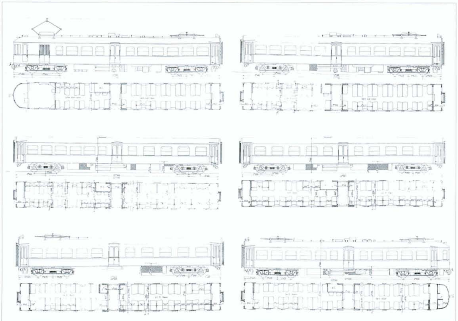
Voici un projet réalisé par Baume & Merpent qui ressemble beaucoup au projet final des automotrices de 1935, mais avec 6 voitures. On remarquera que les voitures 2 et 5 sont également motrices avec un bogie moteur, et pourvues d'un pantographe. Collection PFT.
