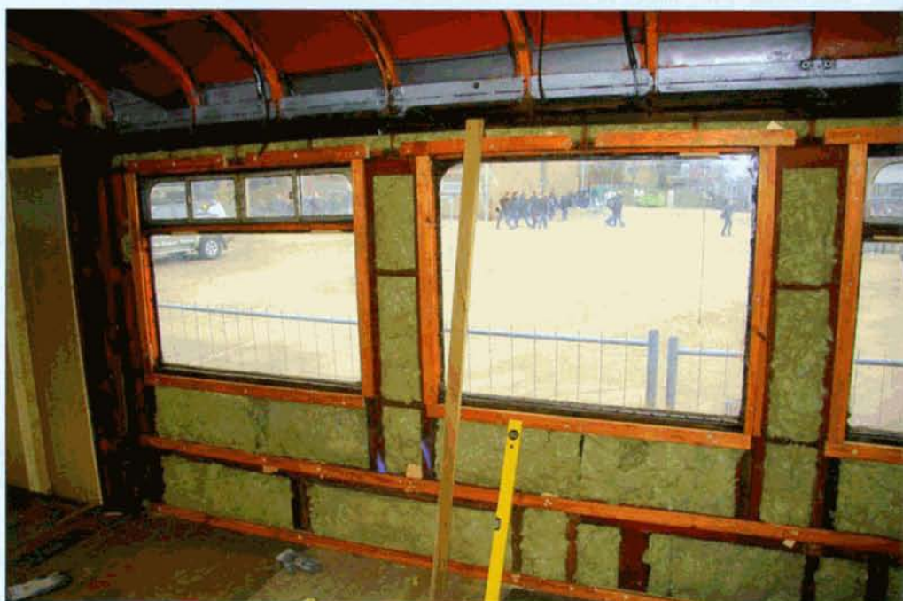
Deux vues de la restauration du 551.26 réalisée par les étudiants de l'école technique TIO à Overpelt. Les parois et le plafond ont reçu un nouvel isolant. PFT / Freddy DELARBRE.
