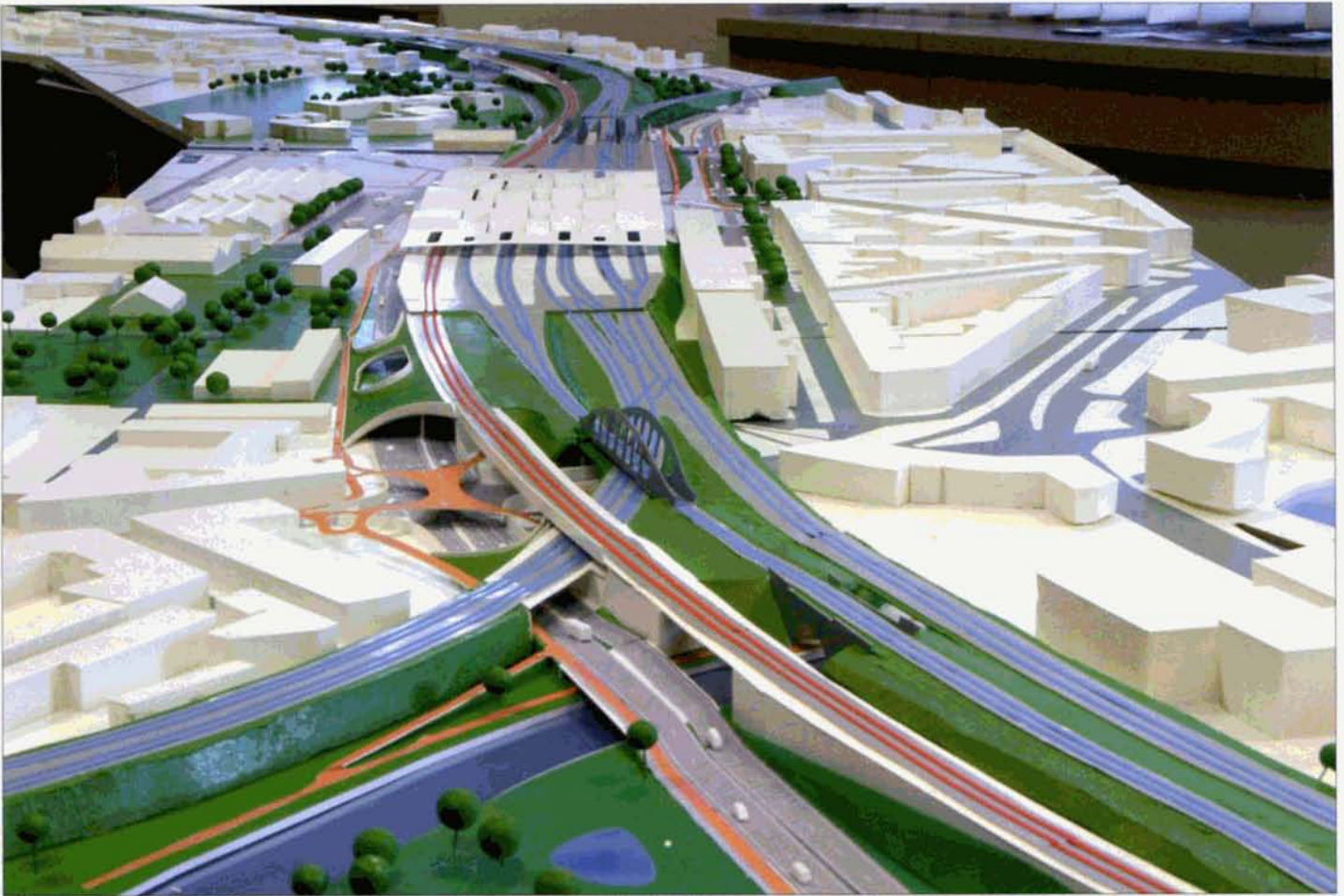
La maquette vue en direction de Bruxelles. En rouge, on aperçoit les deux nouvelles voies rapides du "by-pass", qui seront installées à gauche de la ligne 25 en regardant vers Bruxelles. Au milieu, l'actuel pont Vierendeel qui permet à la ligne 25 de franchir la ligne 53A vers Muizen et Leuven. On remarquera également la tangente routière qui sera établie parallèlement au by-pass et qui occupera une partie des terrains de l'Atelier Central de Mechelen. Copyright TUC RAIL.
