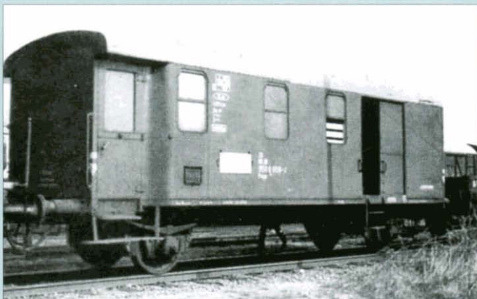
Le fourgon DB 20 88 950 6 659-2, modernisé avec des fenêtres à joints en caoutchouc. Ce véhicule a été démoli. Photo H.W. Westrhenderfehn, collection Charles OCSINBERG.
