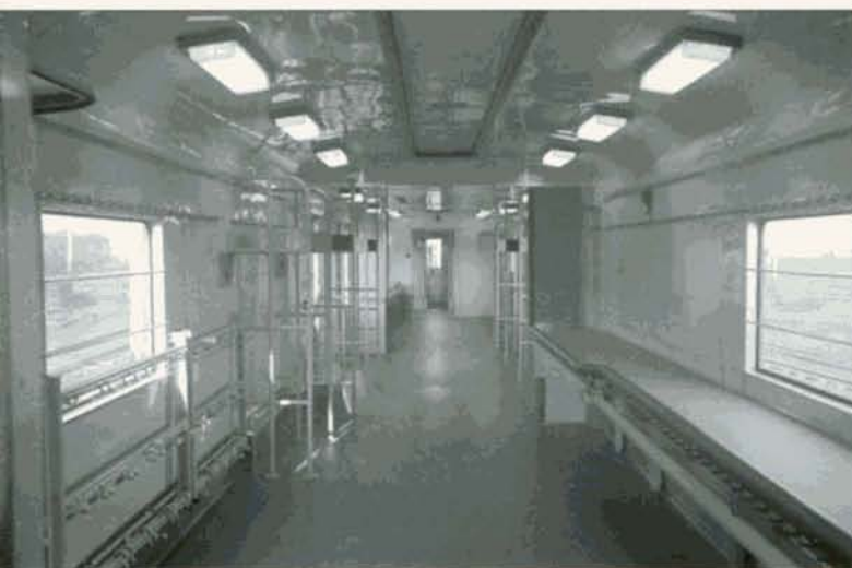
Quatre vues de l'aménagement des automotrices postales. En haut à droite, une plate-forme d'accès avec quatre doubles portes coulissantes. En haut à gauche, l'emplacement de stockage des sacs postaux. En bas : les tables et casiers de tri.
