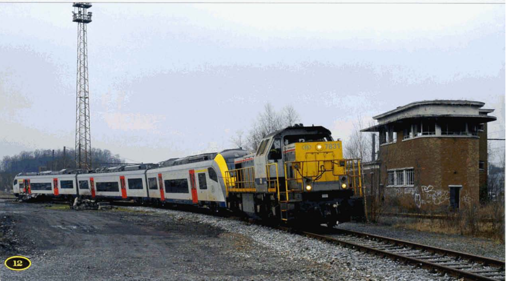
↓ Le 21 janvier, la 08501 a été testée sur la voie d'essai en forte courbe et en forte déclivité se trouvant à côté de l'ancien atelier d'Haine-St-Pierre. Dominique ALLARD.
