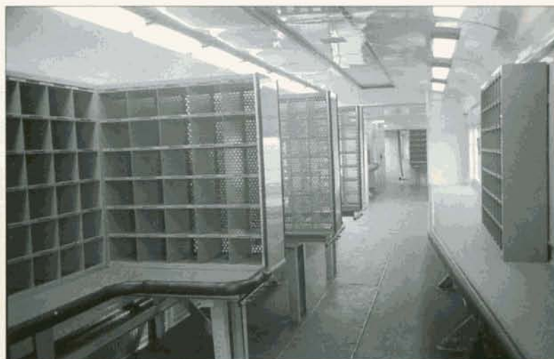
Quatre vues de l'aménagement des automotrices postales. En haut à droite, une plate-forme d'accès avec quatre doubles portes coulissantes. En haut à gauche, l'emplacement de stockage des sacs postaux. En bas : les tables et casiers de tri.
