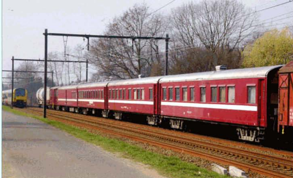
PHOTO 107-55 ↑ Les voitures 00206 à 00209 (dans l'ordre, de gauche à droite de la photo) en cours de transfert vers un autre chantier. Il s'agit d'anciennes remorques d'automotrices de 1935 transformées en 1970. Elles sont actuellement utilisées dans le train de renouvellement P93. Nijlen, 15 mars 2011. Tim VAN ROOY.
