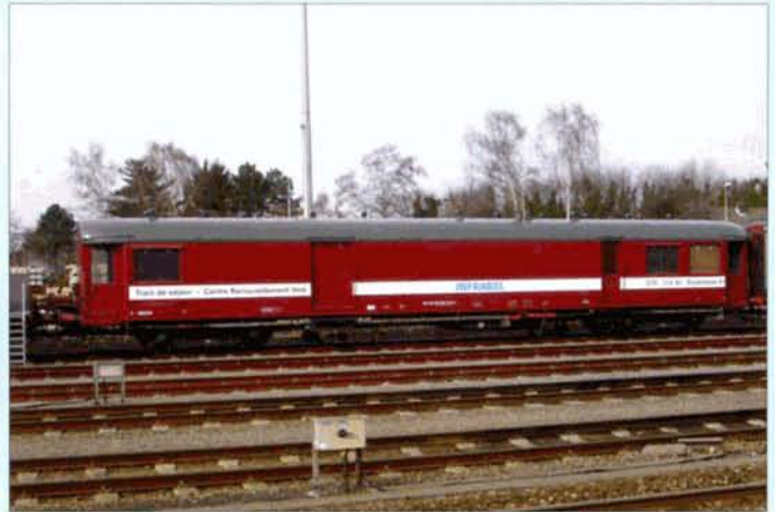
↑ La voiture 00218 (60 88 99-29 218-1) provient de la transformation de la voiture I1 n° 12.017 en 1979. Sortie d'atelier en 1980, elle est aménagée en atelier. A noter que l'ensemble de ces véhicules n'a pas reçu à l'origine un n° UIC de voiture, mais bien de wagon. La gérance "voitures" n'a repris les dossiers qu'au début des années 1990. Mol, 17 mars 2010. Johnny BRAUNS.
