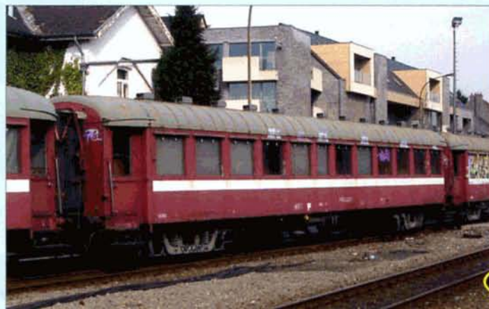
↑ Les voitures 00201 à 00205 du train de renouvellement P811S proviennent de la transformation de voitures internationales du type I1. Ces quatre photos montrent, dans l'ordre, les 00202 à 00204, à leur arrivée à Mol le 17 mars 2010. Johnny BRAUNS.
