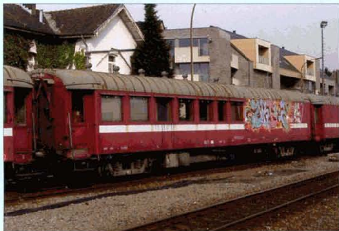
↑ Les voitures 00201 à 00205 du train de renouvellement P811S proviennent de la transformation de voitures internationales du type I1. Ces quatre photos montrent, dans l'ordre, les 00202 à 00204, à leur arrivée à Mol le 17 mars 2010. Johnny BRAUNS.
