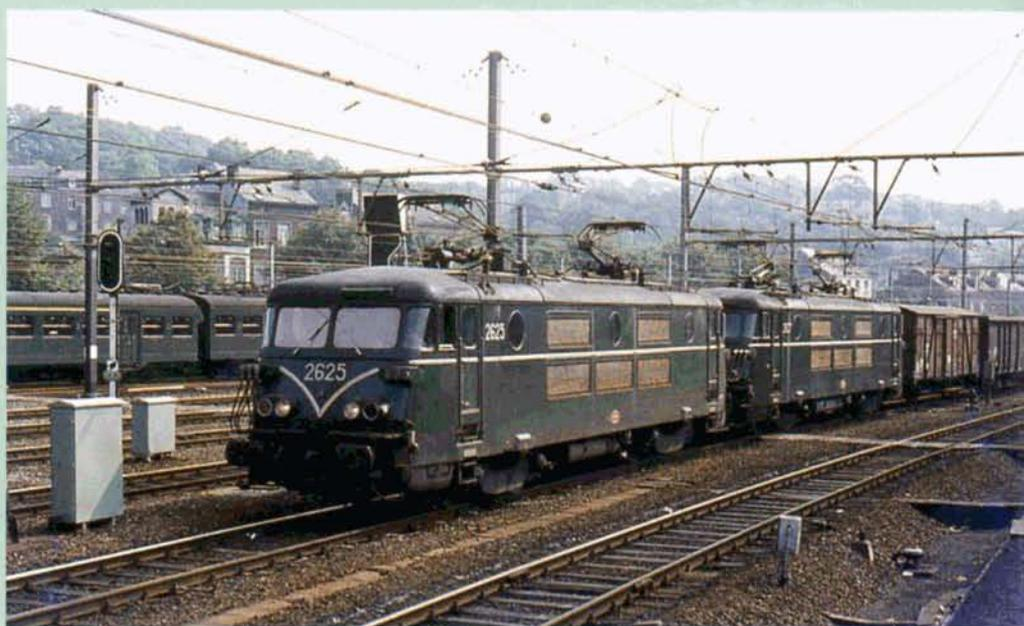
**PHOTO 111-11** Passage en gare de Namur d'un train de marchandises tracté par les 2625 et 2627. La 2625 a été équipée récemment des câblots d'unité multiple, comme en témoigne le carré de peinture verte au droit du boîtier. La garniture en aluminium a dû être interrompue. Photo Julien CASIER, collection PFT.
