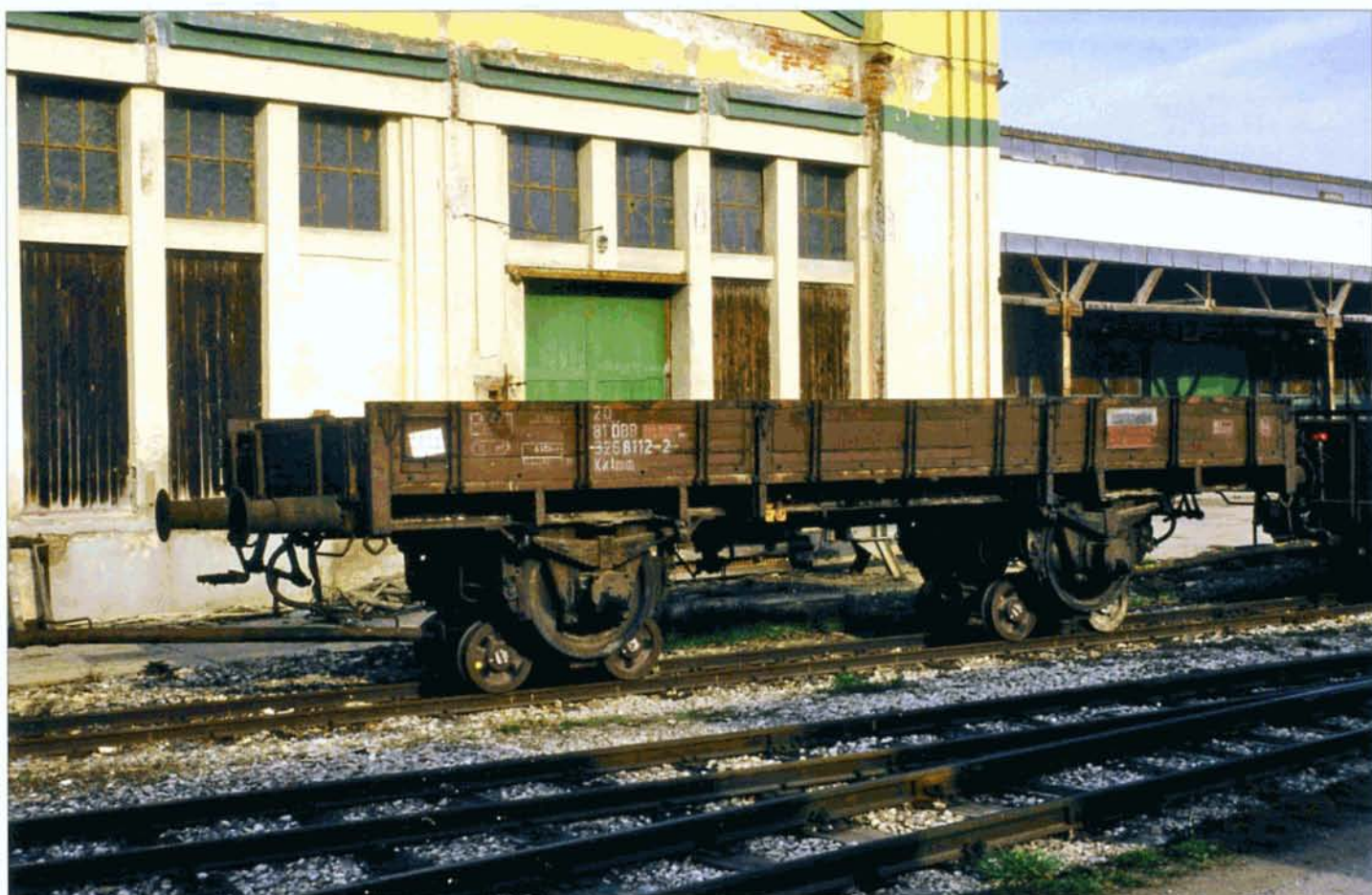
PHOTO 117-51 Avec le système classique de trucks porteurs, il est fait usage de lorries à deux essieux placés sous chaque essieu du wagon à voie normale. Les Chemins de fer autrichiens (ÖBB) ont sauvé un wagon plat porté sur deux lorries en tant que patrimoine historique. Obergrafendorf, 4 avril 1998. Wim DE RIDDER.
