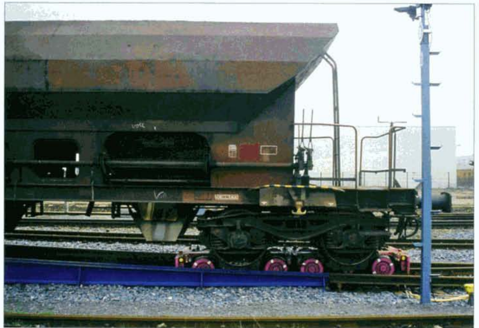
Gros plan sur le truck porteur type Vevey n° Ua 220 utilisé par le réseau suisse du BAM (Bière-Apples-Morges). L'essieu du wagon à voie normale prend place dans la cavité centrale. Morges, 11 septembre 2007. Marc STRIFFELER.
