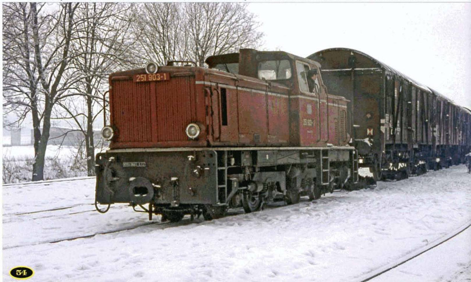
PHOTO 117-79 ↓ Lors de sa création en 1949, la DB s'est vue confier l'exploitation de plusieurs lignes à voie étroite. En 1964, la DB mit en service cinq locomotives Diesel construites par Gmeinder : les V51 901 à 903 (écartement 0,750 m) et les V52.901 et 902 (écartement 1,000 m). En 1968, ces machines furent renumérotées dans les séries 251 et 252. En 1972, en gare de Warthausen (ligne Warthausen - Oschenhausen), la 252 903 manoeuvre des lorries transportant des wagons fermés à voie normale. Les 252 furent radiées le 5 juin 1973; les 251 le 29 décembre 1983, sauf la 251 901 déjà réformée le 21 février 1971. Julien CASIER, collection PFT.
