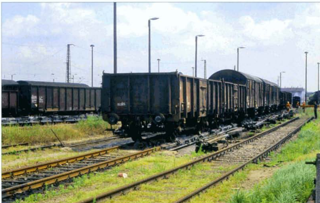
PHOTO 117-50 L'aire de chargement/déchargement des wagons à voie normale de Oschatz (Saxe), le 7 juillet 1991. La locomotive à voie étroite visible à l'arrière-plan, a poussé tous les wagons porteurs l'un contre l'autre. Après l'accouplement des wagons à voie normale, une locomotive à voie normale viendra les tirer hors des wagons porteurs. Wim DE RIDDER.
