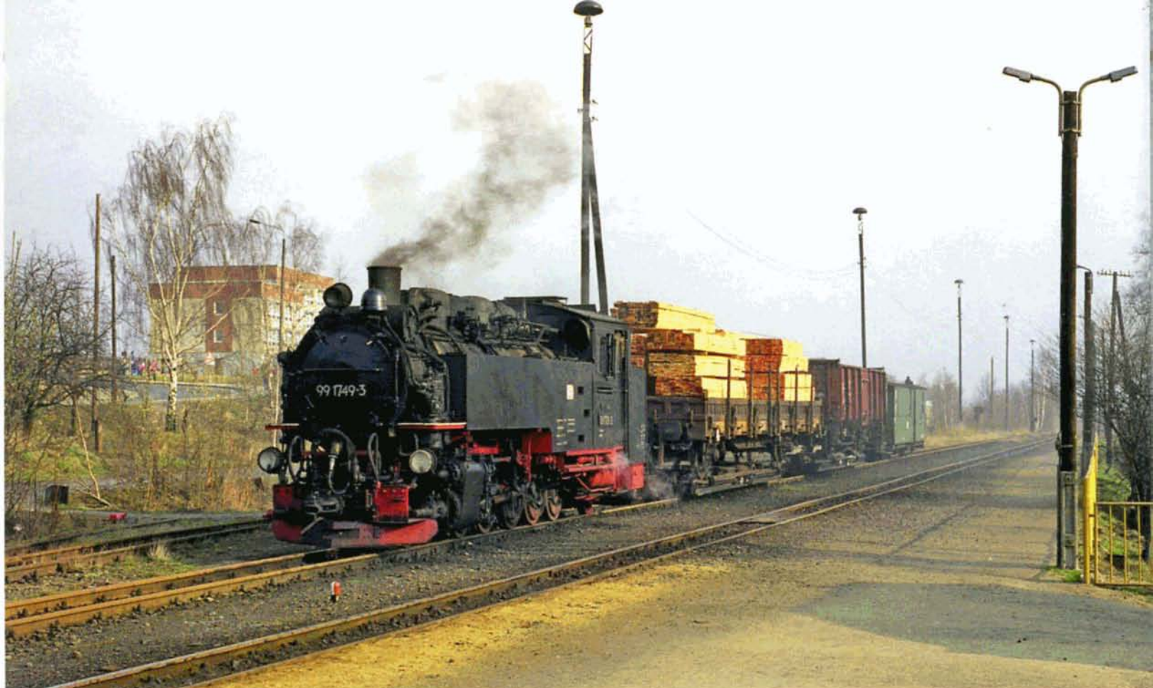
PHOTO 117-78 ↑ Le 20 mars 1991, un train de marchandises remorquant deux wagons à voie normale est garé à Zittau-Vorstadt (ligne Zittau - Bertsdorf - Oybin/Jonsdorf) à l'écartement 0,750 m), afin de se faire dépasser par un train de voyageurs. En tête, la 99 1749 (Schwartzkopff 9638 / 19259) du dépôt de Zittau. Ce type de locomotive 1E1t fut produit à 32 unités (DRG 99 731 à 762, puis DR 99 1700) de 1929 à 1933 par Hartmann et Schwartzkopff. Philippe GOUSSET.
