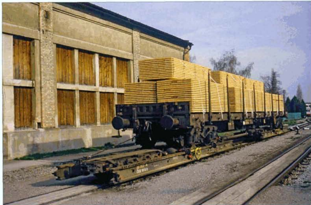
PHOTO 117-49 Le transport de wagons à bogies ne pose aucun problème. Il est fait usage d'un wagon porteur par bogie, comme c'est le cas pour ce wagon autrichien (ÖBB) chargé de planches de bois. Obergrafendorf (Autriche), 4 avril 1998. Wim DE RIDDER.
