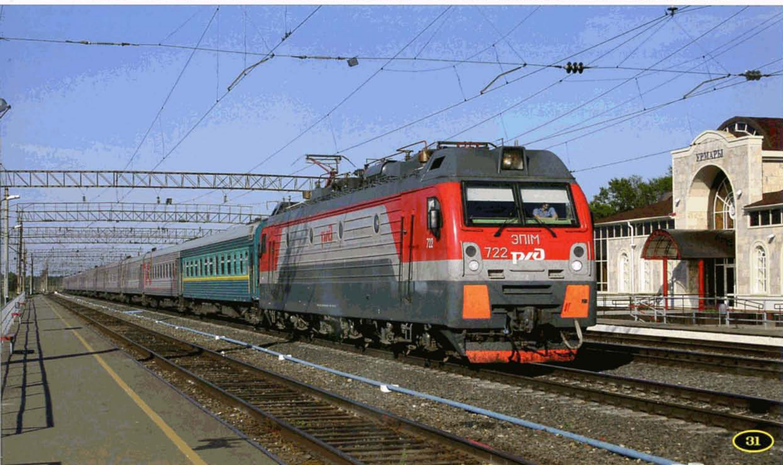
↓ PHOTO 117-47 Le 12 juillet 2012, la EP1M-722 passe devant le bâtiment voyageurs de la gare de Urmari en tête d'un train express Petropavlovsk - Moskwa Kazanskii. Les EP1M sont des Bo'Bo'Bo' de 4400 kW pouvant circuler à 140 km/h. Dans le programme de modernisation des RZD, la EP1M est la locomotive 25 kV 50 Hz pour trains de voyageurs et est destinée à remplacer les ChS4T. Elle est produite depuis 2007 par NEVZ Novotcherkassk et est une évolution de la EP1 (381 unités livrées de 1999 à 2007). Depuis la EP1M-696, les EP1M sortent d'usine dans la nouvelle livrée. Fin juin 2013, 459 EP1M étaient en service. Philippe DE GIETER.
