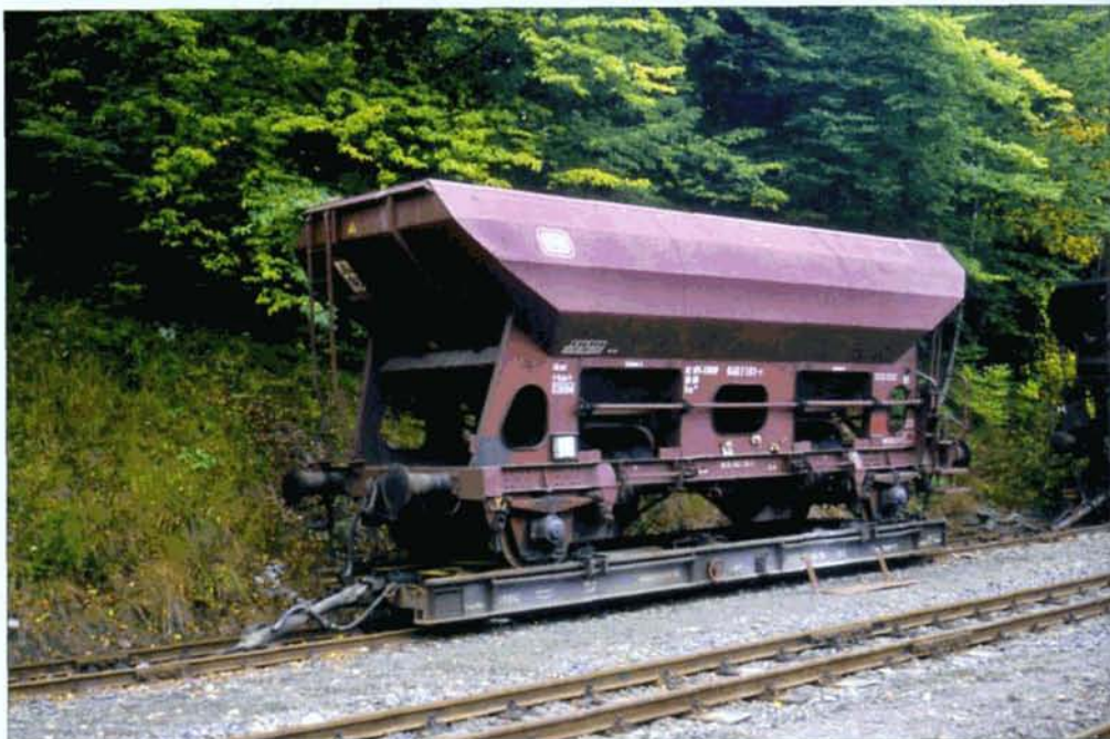
PHOTO 117-48 Les wagons porteurs sont constitués d'un châssis avec, dans le sens de la longueur, deux grosses poutrelles servant de chemin de roulement pour les wagons à voie normale. Voici le wagon porteur 99-20-38 du Harzer Schmalspurbahnen à Eisfelder Thalmühle, le 4 octobre 1997. Wim DE RIDDER.
