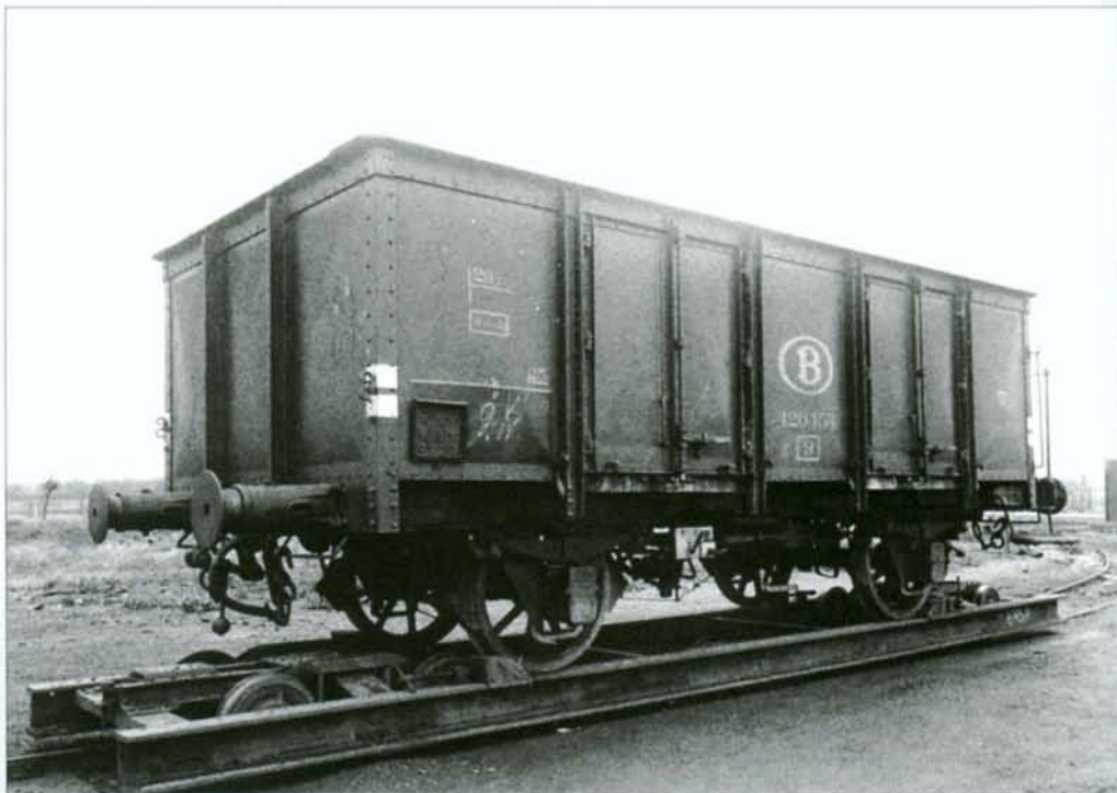
↑ Un tombereau de la SNCB transporté sur un wagon porteur sur la ligne Warsage - Trembleur. Auteur et date inconnus, collection PFT.
