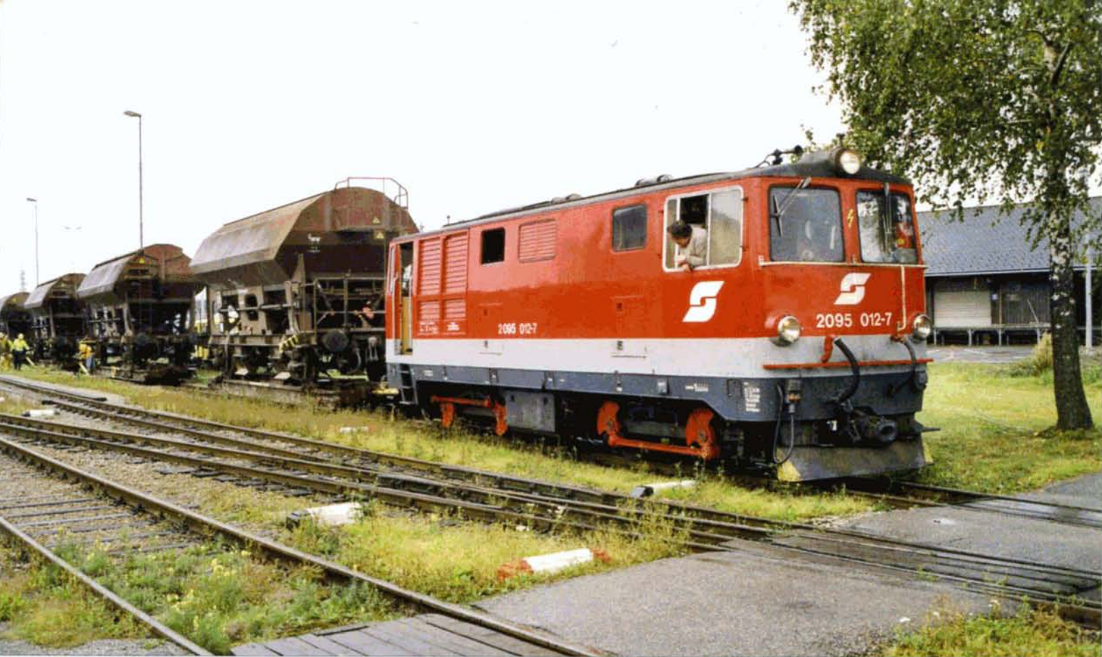
PHOTO 117-83 ↑ Toujours en Autriche, le 15 septembre 2004, la 2095 012 des ÖBB manoeuvre un train en gare de Gmünd. Il s'agit d'un train de service (transport ballast). Le service commercial était supprimé depuis le 8 janvier 2000. Les 2095 furent construites à 15 unités entre 1958 et 1962 par SGP. Ivo VAN STEENWINKEL.
