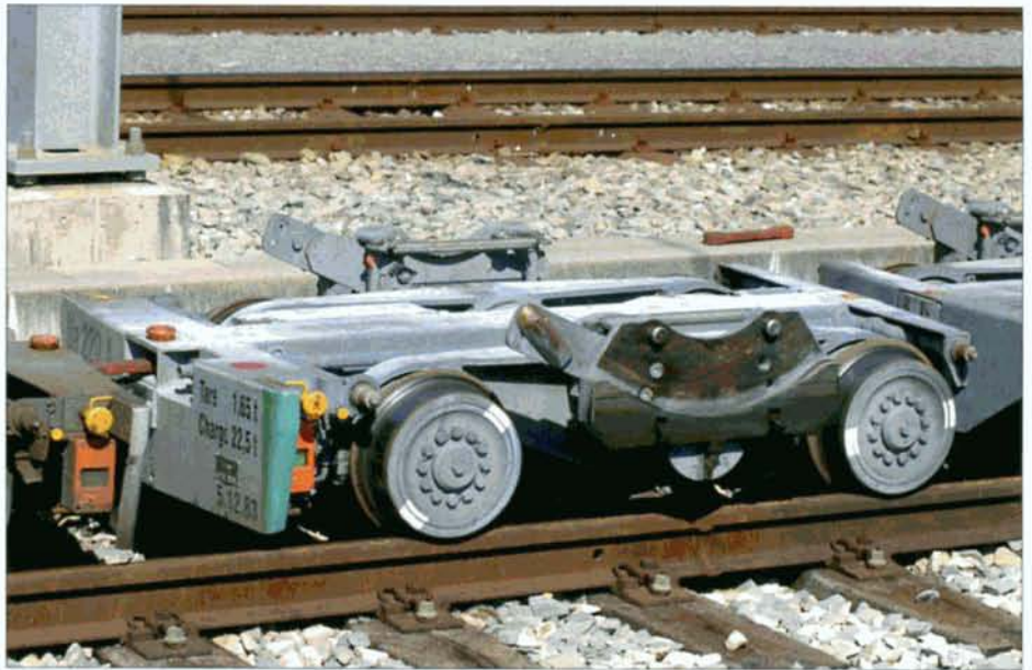
Gros plan sur le truck porteur type Vevey n° Ua 220 utilisé par le réseau suisse du BAM (Bière-Apples-Morges). L'essieu du wagon à voie normale prend place dans la cavité centrale. Morges, 11 septembre 2007. Marc STRIFFELER.
