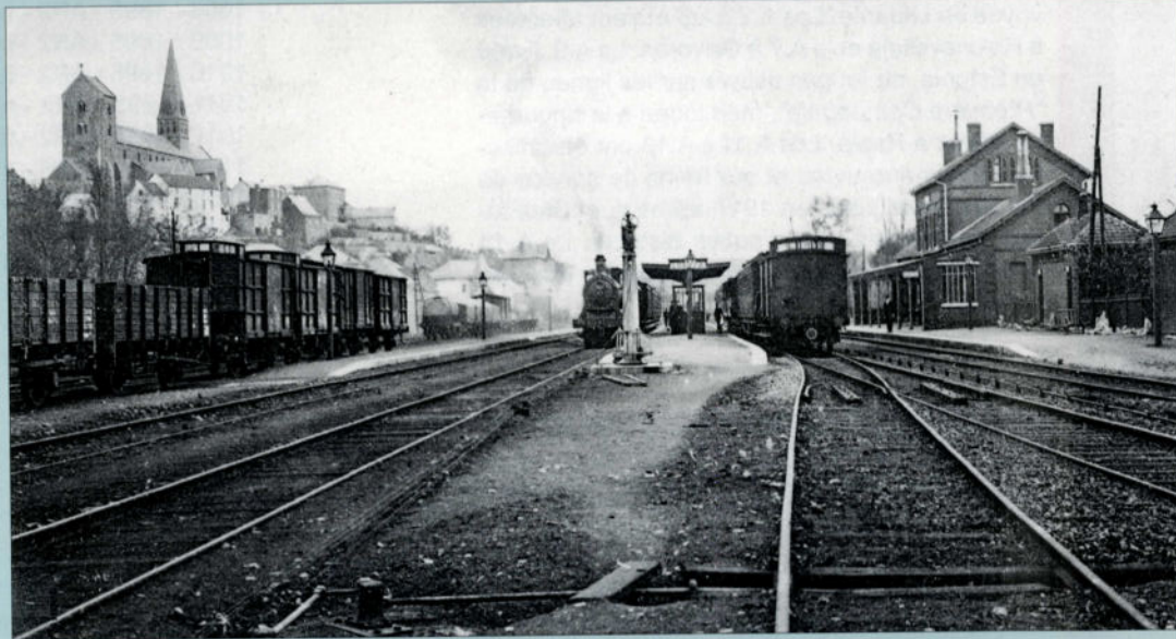
→ Sur cette carte postale ancienne de la gare de Lobbes, on voit à droite un train de voyageurs pour Charleroi stationnant à quai; en queue est accouplé un fourgon de la série 603 à 630. Le convoi se trouvant à sa gauche est un train Etat Belge à destination de Mons ou de la région du Centre. Collection PFT.
