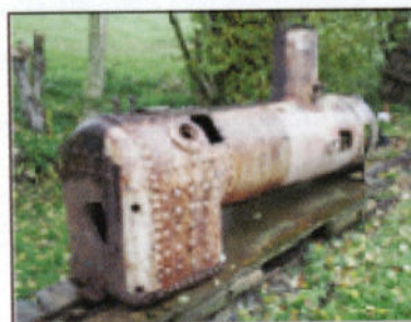
L'ancienne chaudière à remplacer
