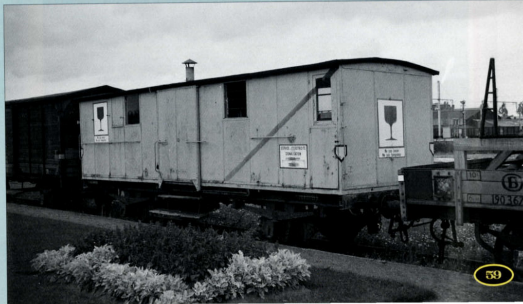
PHOTO 120-64 NB → Un fourgon de la série 603 à 630 réutilisé comme véhicule de service 190.898 par le service ES. Gembloux, 12 septembre 1962. Photo Bruno DEDONCKER, collection PFT.
