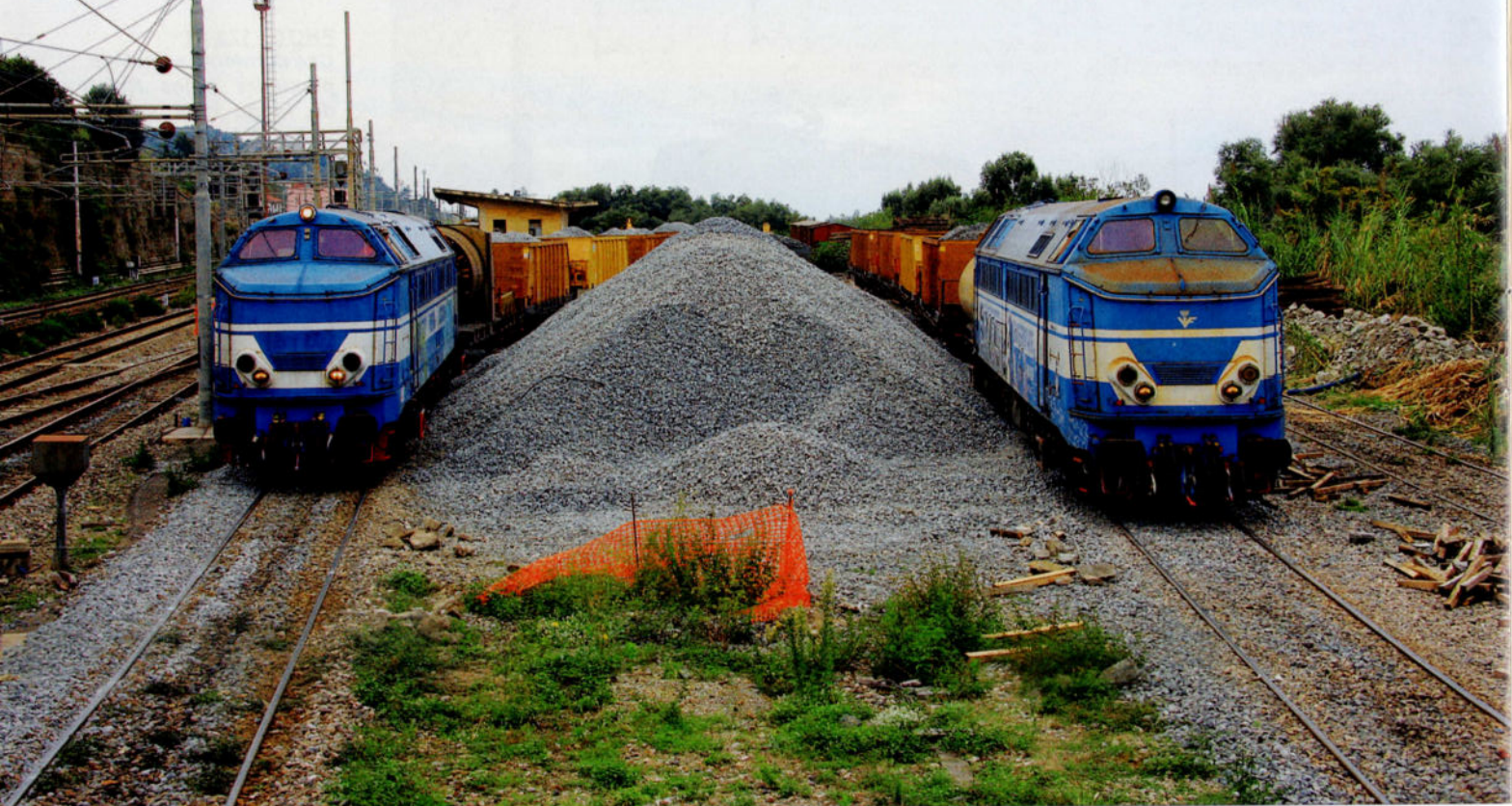
PHOTO 125-30 Un important chantier de réfection d'un long tunnel à Palmi (tunnel et voies), sur la ligne Paola - Reggio Calabria, nécessite l'engagement de pas moins de cinq locomotives de la série 51 de Ventura et d'un locotracteur d'origine allemande. En gare de Palmi, deux rames de ballast sont en cours de chargement, avec à leur tête, les 5170 (à gauche) et 5167 (à droite). Pierre HERBIET.
