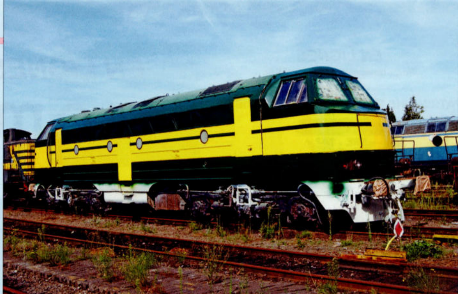
PHOTO 129-03 La caisse de la 5205 est peinte. Il reste à traiter les bogies, les traverses de tête et la toiture. Schaerbeek, 6 août 2015. PFT.
