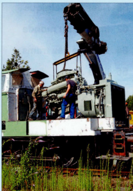
PHOTO 129-03 Placement du moteur Diesel dans la 8051. Schaerbeek, 6 août 2015. PFT.
