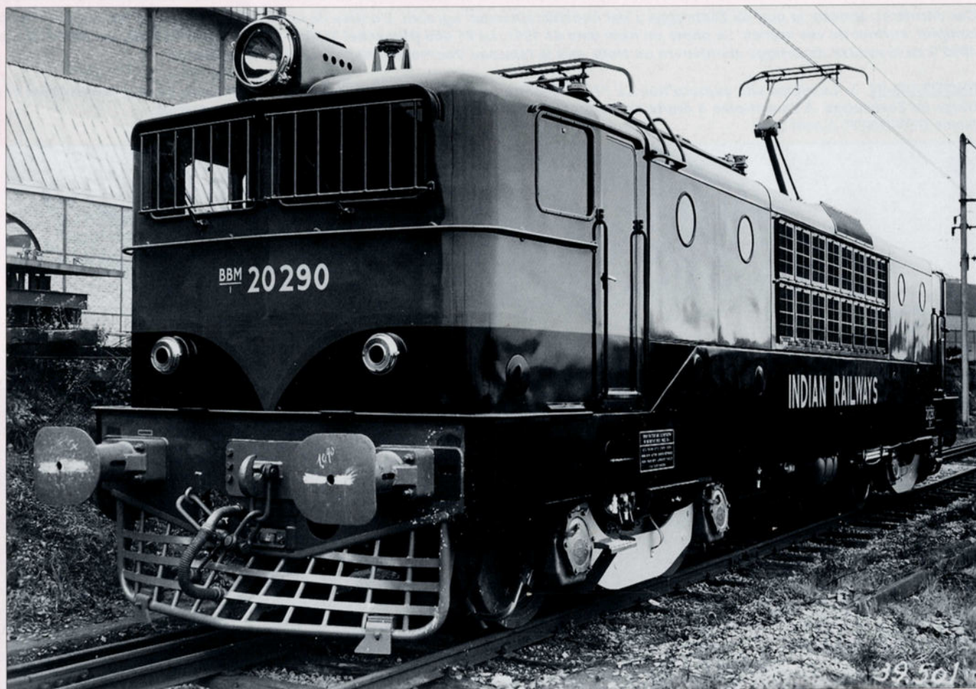
La BBM1-20290 en cours de test sur la voie d'essai de La Brugeoise et Nivelles à Nivelles en 1959. L'influence française est indéniable, avec les bogies identiques aux BB9200 de la SNCF et la caisse calquée sur les BB16500 de la SNCF.
