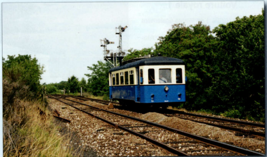
PHOTO 129-58 Les autorails à deux essieux du type 551 étudiés par Brossel furent construits à 56 unités en 1938 et 1939 dans le but d'exploiter économiquement les petites lignes secondaires. Le 15 août 1986, le 551.48 en route vers Zolder, vient de franchir le chandelier d'entrée de Leopoldsburg. Jean-Luc VANDERHAEGEN.
