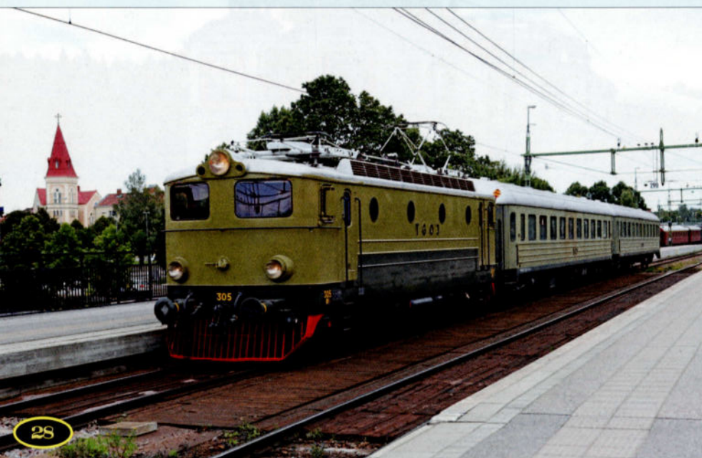
PHOTO 130-48 De 1954 à 1955, le réseau privé du TGOJ (Trafik AB Grängesberg - Oxelösunds Järnvägar) utilisait 11 Bo'Bo' construites par ASEA et numérotées dans la série Bt 301 à 311. D'une puissance de 2640 kW, elles pouvaient circuler à 105 km/h et pesaient 72,6 t. Le 12 septembre, la Bt 305 remise dans sa version d'origine, a remorqué un train spécial jusqu'à Gävle. La voici en gare de Gävle lors du voyage du retour. Michel AERTS.
