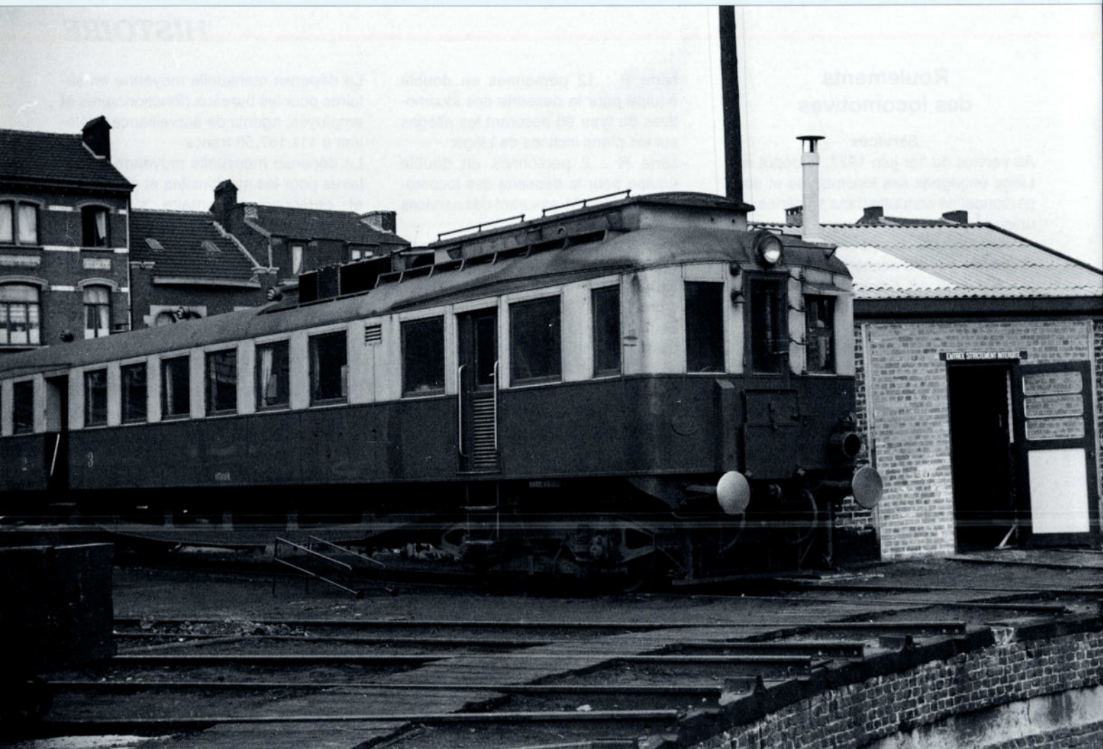
En 1938, l'autorail Diesel 650.01 stationne sur la même voie que la photo précédente. Cet autorail a été construit en 1938 en Suède par ASEA. Il était équipé d'un moteur Diesel danois Burmesiter de 200 CV et d'une transmission électrique ASEA. Gravement endommagé lors des bombardements de Liège en mai 1944, il fut radié le 18 avril 1945. Cet engin a été décrit en détail dans EN LIGNES 112 pages 58 à 62. Collection PFT.
