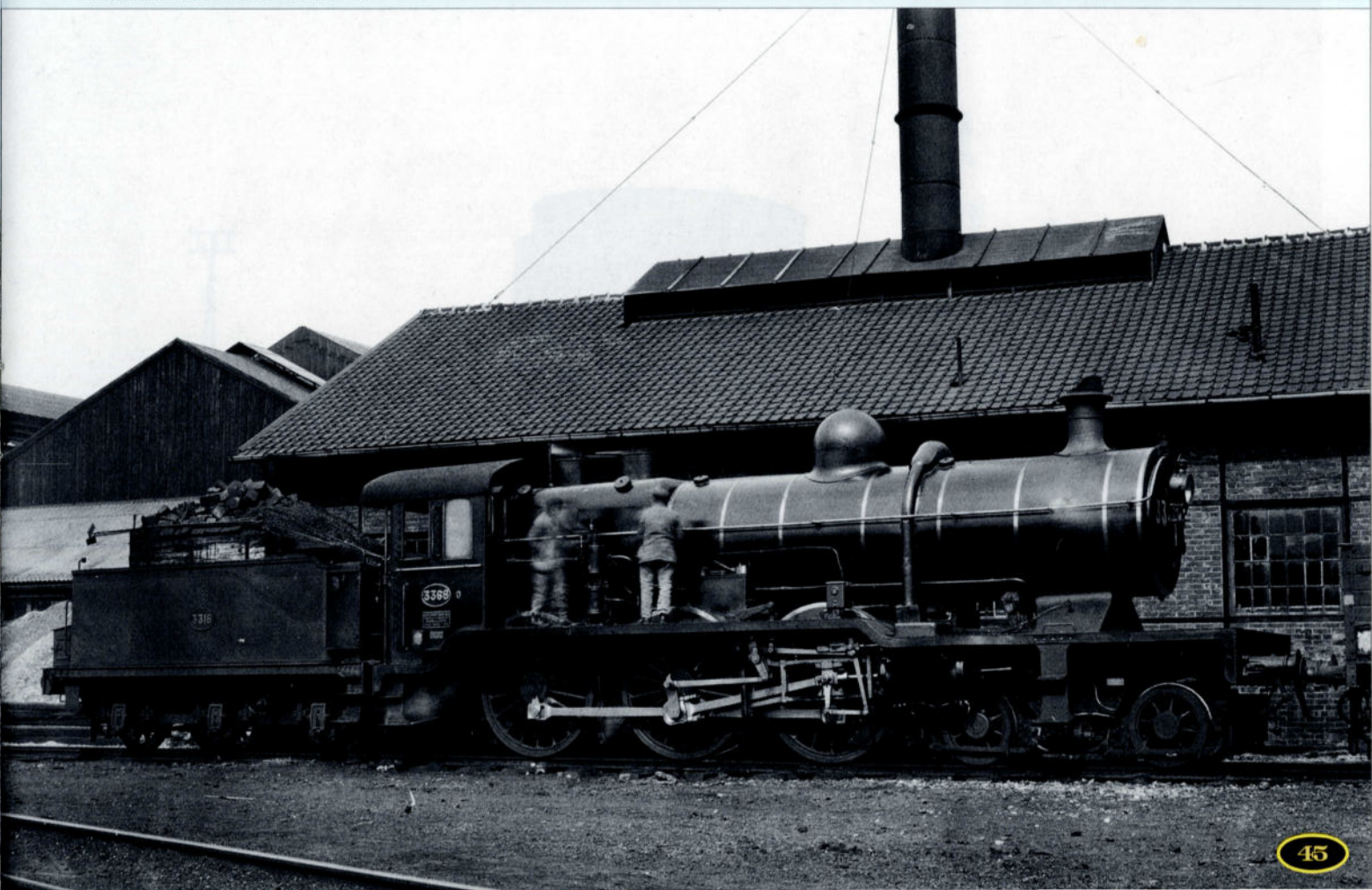
L'équipe de conduite de la type 8 n° 3368 assure le graissage de la pompe à air. Le bâtiment visible à l'arrière renferme les chaudières de lavage. Cette locomotive, construite par la Franco-Belge (n° 1627 de 1907), fut mise en service le 8 décembre 1907 au dépôt de Verviers. Elle termina sa carrière à Tamines le 5 juin 1948. Collection André DAGANT / PFT.
