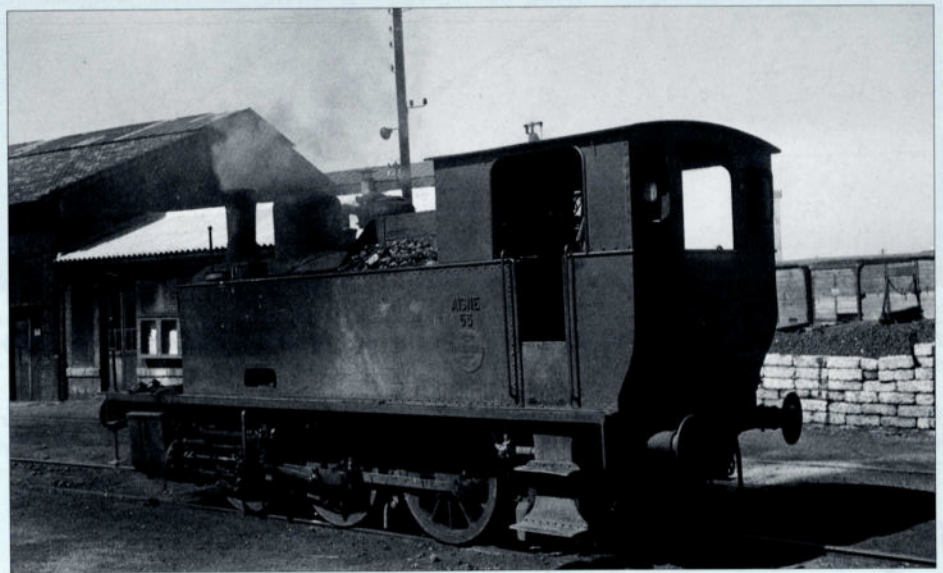
Locomotive-Tender pour industries diverses à 6 roues complètes de 0=950 de diamètre. Poids en service : 32 tonnes.
