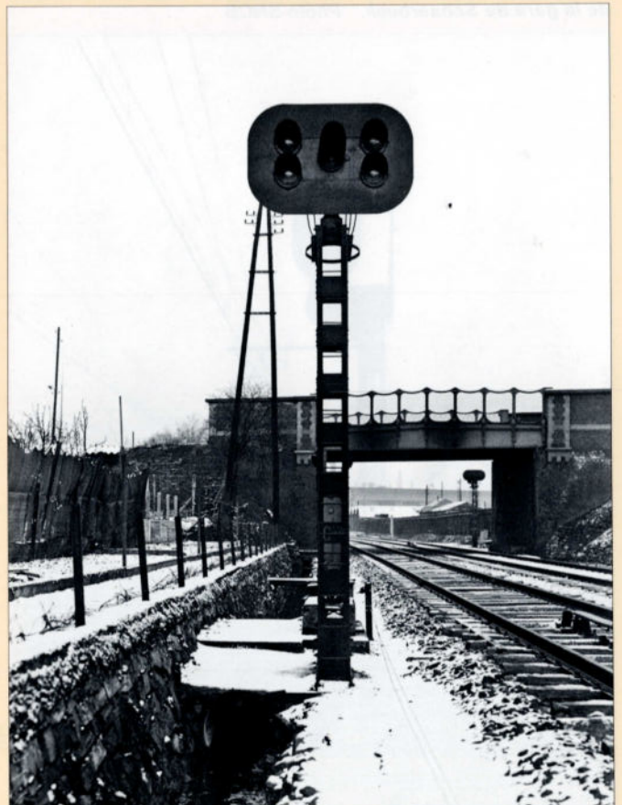
Un signal combiné à cinq feux implanté entre Couillet et Charleroi-Sud. Photo SNCB.
