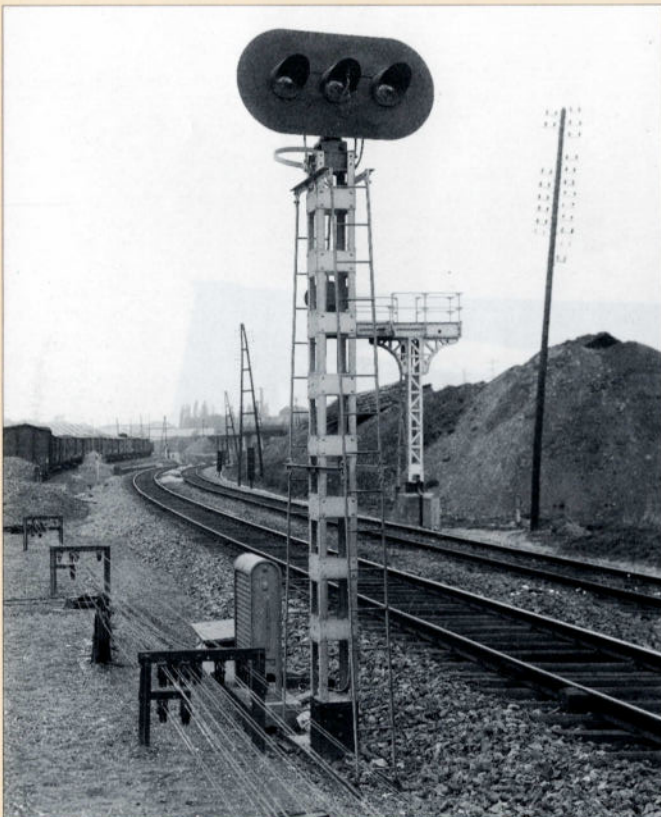
Signal avertisseur à trois feux implanté à la sortie de la gare de Couillet en direction de Charleroi-Sud. Fonds ACEC, collection Bois du Cazier.
