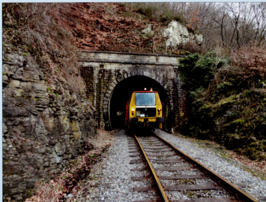
Le 24 mars, la bourreuse oeuvre à la sortie du tunnel de Purnode. CFB-PFT.
