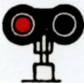
- feu rouge ordonnant l'arrêt (plaque du signal mécanique de face)
