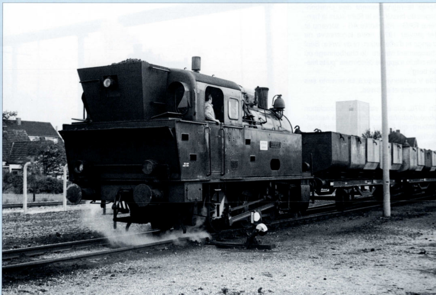
Encore deux vues de notre Knapsack en action dans le charbonnage de Neukirchen-Vluyn. Ci-dessus le 29 septembre 1974. Ci-dessous, le 2 janvier 1973. Nous remarquons le sifflet raccordé au dôme de prise de vapeur et la cloche Latowski. Martin WELZEL - Günther BARTHS.
