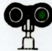
- feu vert pour le passage autorisé (plaque du signal mécanique effacée)
