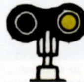
- le feu jaune autorise la manoeuvre (plaque ronde du signal mécanique effacée)
