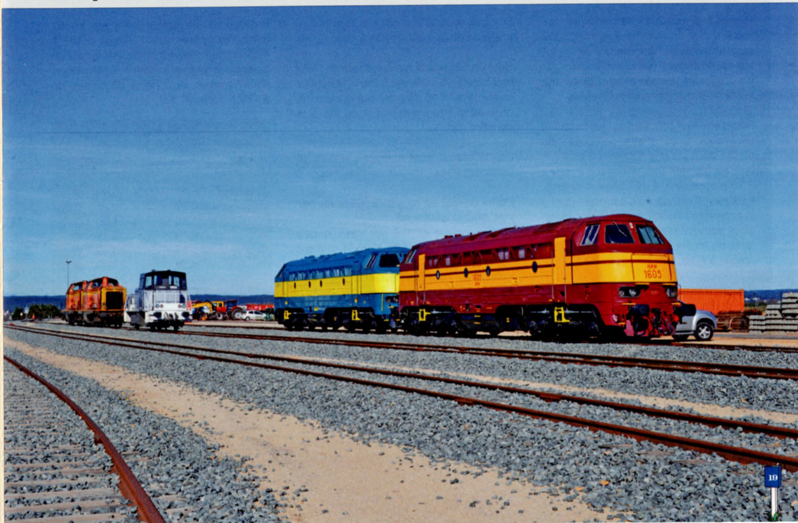
PHOTO 133-15 Les deux locomotives à la base travaux de Montpellier. Elles sont utilisées pour remorquer des trains de ballast sur la ligne nouvelle TGV de contournement de Nîmes et de Montpellier. Gwenaël PIÉRART.
