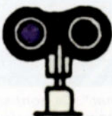
- le feu mauve ordonne l'arrêt (plaque ronde du signal mécanique de face)
