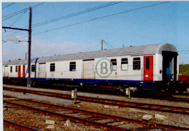
PHOTO 133-20 Le fourgon-générateur Dms 17.817 utilisé pour alimenter des installations en 220 V. J-L VANDERHAEGEN.
