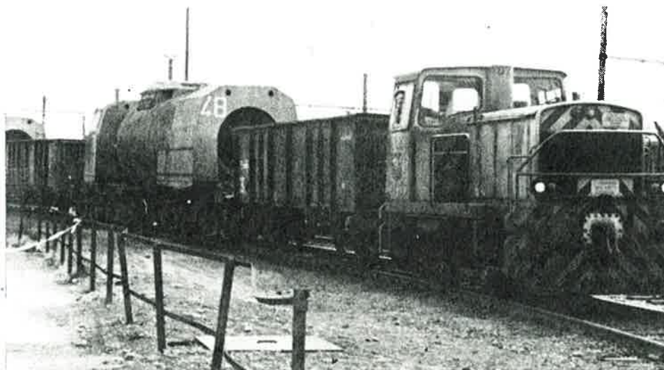
Un train en provenance de Chertal vient d'être pris en charge par un locotracteur de Cockerill-Sambre sur l'embranchement particulier de l'usine. Nous pouvons remarquer la présence d'un tombereau entre chaque wagon "torpille". Un second locotracteur (accouplé à un élément moteur sans cabine) ferme la marche.
