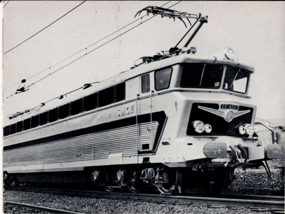
Dit type locomotief van de Franse serie CC 40100, maximum snelheid 180 km/u, rijdt dagelijks met een gelijksoortige machine van Belgische constructie de TEE-treinen tussen Parijs en Brussel. Deze meerstroom-locomotieven kunnen rijden onder alle stroomsoorten van Europa: de wisselstroombaanvakken met 16 \frac{2}{3} Hz of met 50 Hz en de lijnen met gelijkstroom van 3000 of 1500 Volt.
